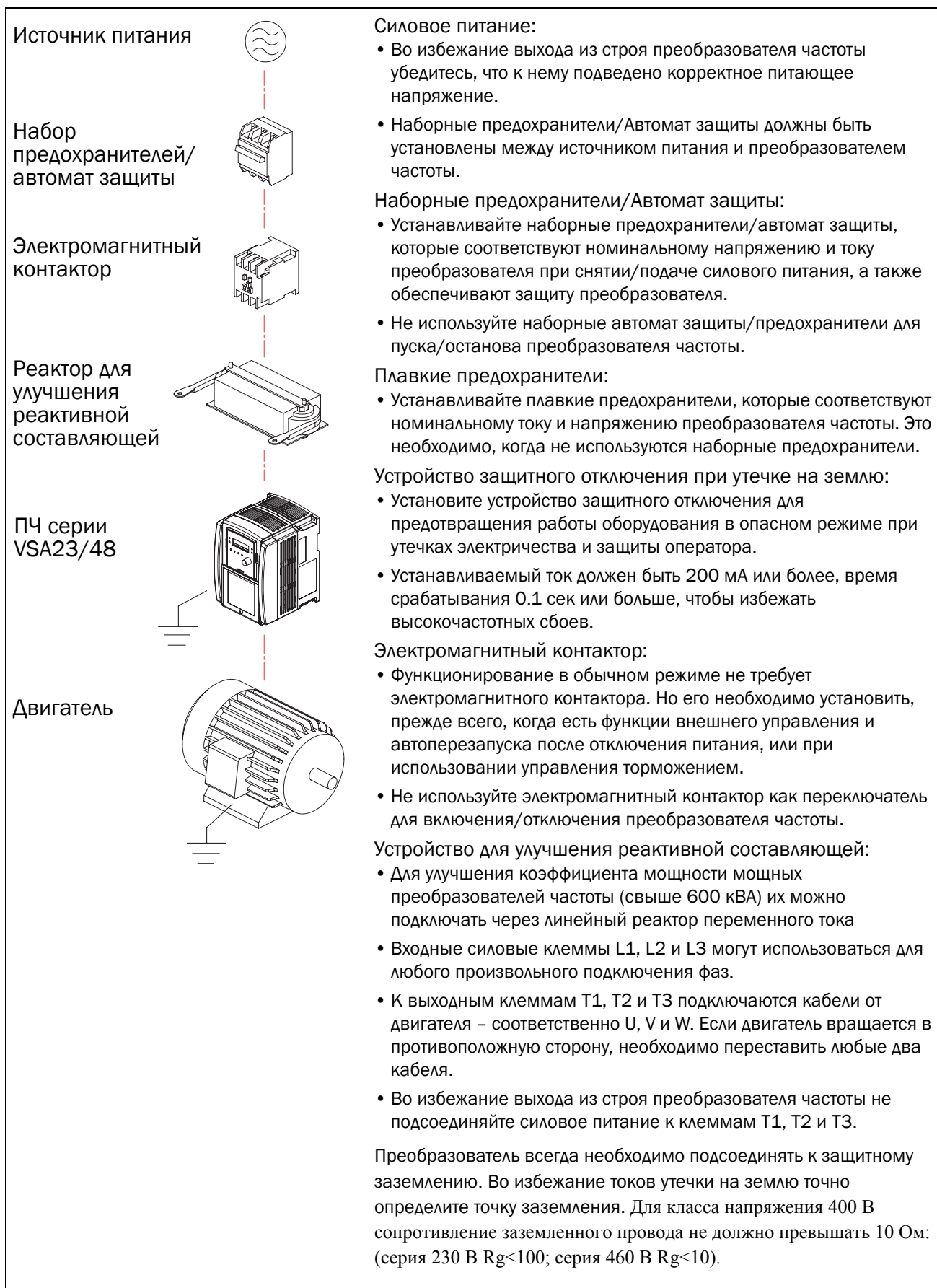
Рис. 5 Пример установки оборудования
