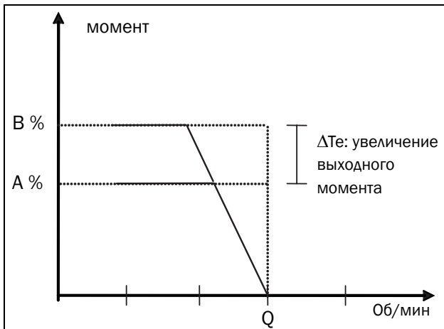
Рис. 27 Зависимость крутящий момент/скорость вращения
