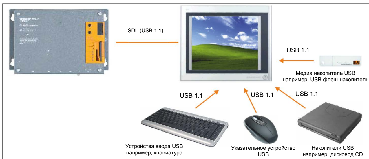
Рис. 33: Дистанционное подключение к Automation Panel 800/900 через SDL
