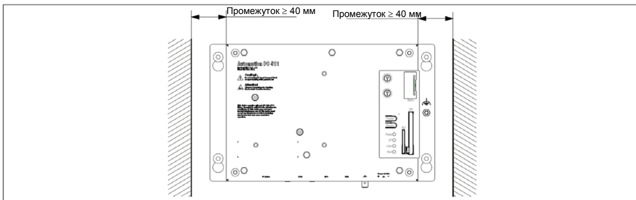
Рис. 20: Промежуток для циркуляции воздуха - Вид сзади
