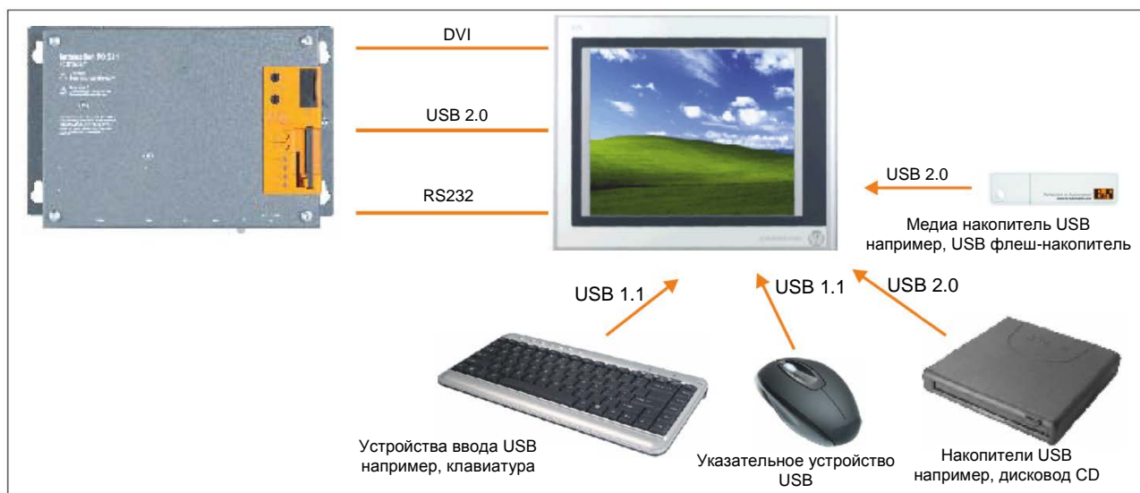
Рис. 32: Дистанционное подключение к Automation Panel 900 через DVI
