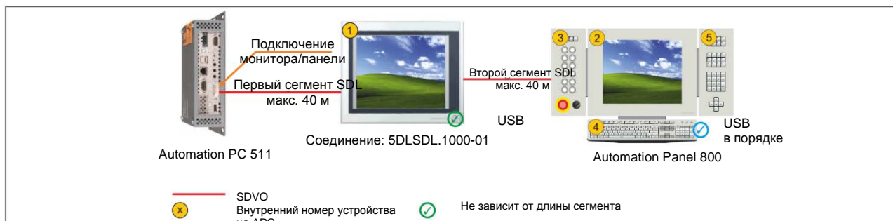
Рис. 29: Одна система AP900 и одна система AP800 работают со встроенным SDL
