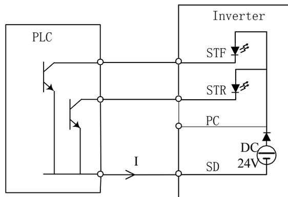
Sink-режим. Дискретные входы замыкаются через транзисторы с открытым коллектором ПЛК на SD
