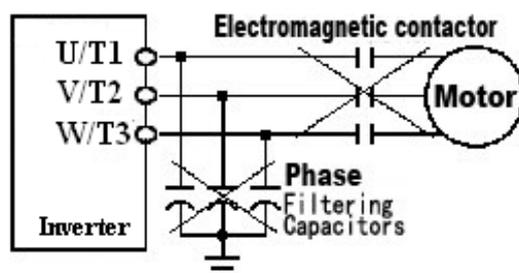
3. Не используйте электромагнитные контакторы или автоматические выключатели в цепи питания для запуска или остановки двигателя. Используйте для этого сигналы на клеммах управления STF и STR.
