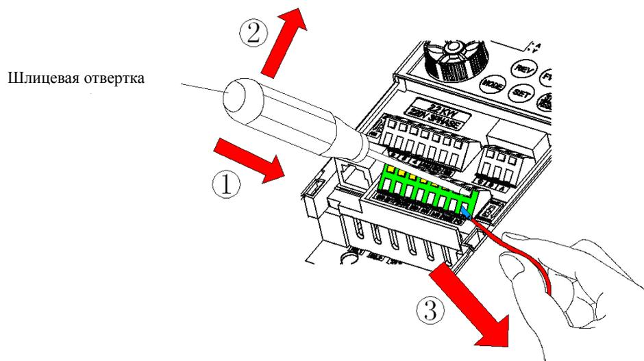
Вставьте отвертку в верхнее клеммное отверстие и нажмите вниз (как показано на рис.), а затем выньте электрический провод.
