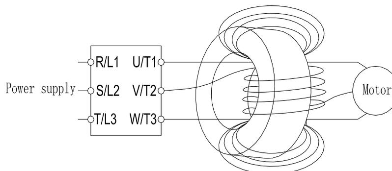
Схема А: Намотайте по 4 витка вокруг сердечника каждым проводом.
