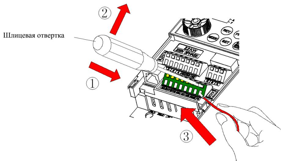
Вставьте отвертку в верхнее клеммное отверстие и нажмите вниз (как показано на рис.), а затем вставьте электрический провод в нижнее отверстие клеммы и выньте отвертку.
