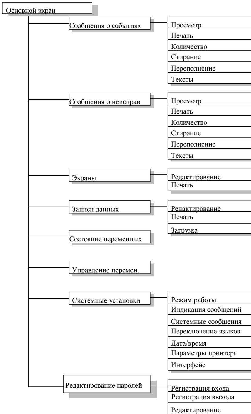
Рис. 4-2. Иерархия стандартных экранов, поставляемых для OP7 и OP17
