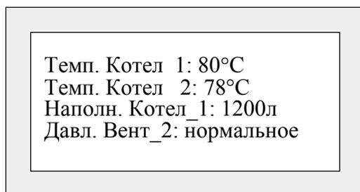
Рис. 5-1. Пример тематически сгруппированных значений, характеризующих процесс, на экране
