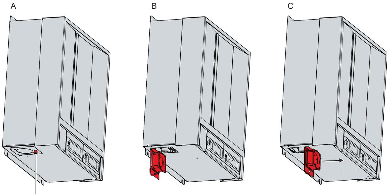
Fig. 27: C6675\_exchange fan bottom
