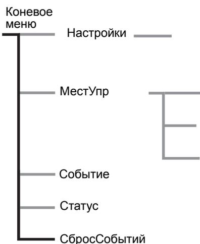
Вход в меню сброса событий осуществляется автоматически, когда возникает неисправность или срабатывает система защиты. В него можно также войти через главное меню. С помощью кнопок навигации можно проверить, есть ли дополнительные события, подлежащие сбросу.
