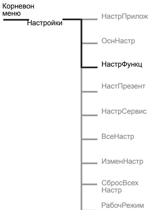
Меню настроек функций состоит из групп с параметрами, упорядоченными в соответствии с конкретными функциями, такими как защита, формирование предупреждений, обмен по технологической шине и др. Это меню должно использоваться, если требуется более тщательная настройка системы. Подробное описание каждого параметра приведено в Разделе 10 "Функции".
