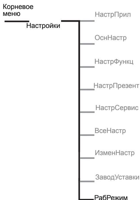
Рабочий режим позволяет выполнять переключение между двумя различными режимами устройства: плавного пуска, деморежимом и стандартным рабочим режимом. В деморежиме можно проверить программируемые входы/выходы, цепи пуска и остановки, шунтирующий контактор и т.д. до начала эксплуатации устройства. Пока устройство находится в деморежиме цвет дисплея изменен (кроме внешней клавиатуры).
