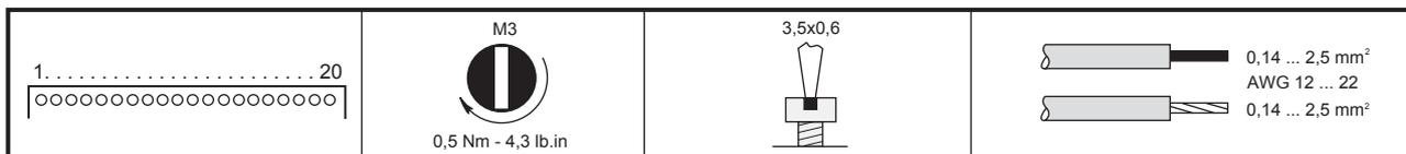
Рис. 34: Усилия затяжки и размеры кабелей (1 мм = 0,0394 дюйма)
