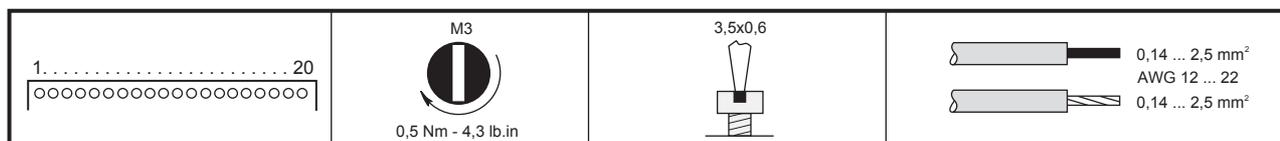
Рис. 31: Усилия затяжки и размеры кабелей (1 мм =0,0394 дюйма)
