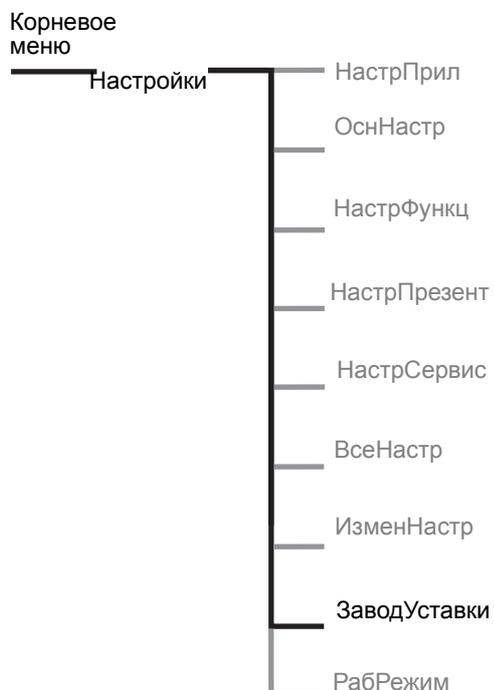
Для сброса всех измененных параметров на значения, принятые по умолчанию на заводе-изготовителе, войдите в это меню. Подтверждение сброса будет осуществляться выводом надписи "Сделано" на ЖК-дисплее. Сброс не повлияет на часы реального времени, счетчик времени наработки и число пусков.
