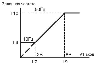
● Установка частоты посредством входа V1 (0 (В) – + 10 (В))
