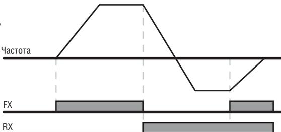
● Подача команд с помощью клемм FX, RX, вариант 2
