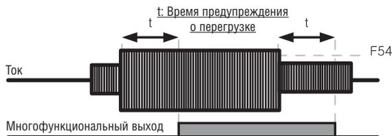
● Сбой из-за перегрузки
