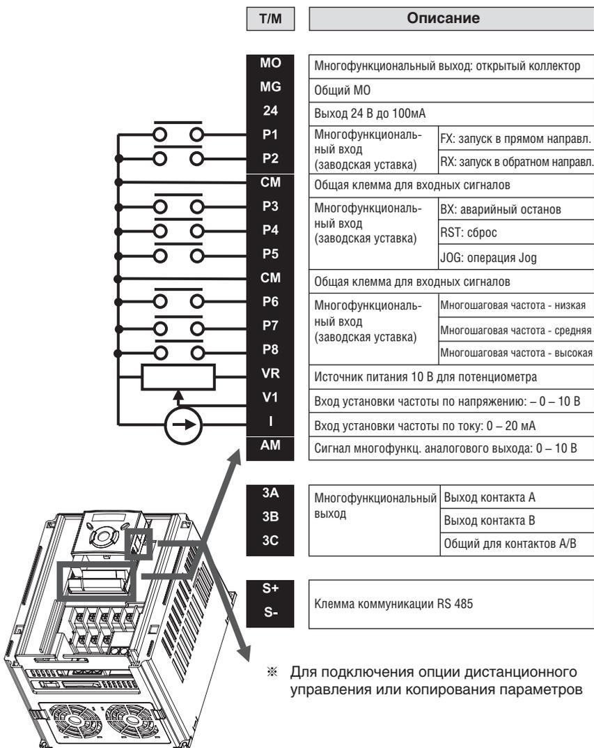
**\* Подключение. Мощность (0,4 – 7,5 кВт)**
