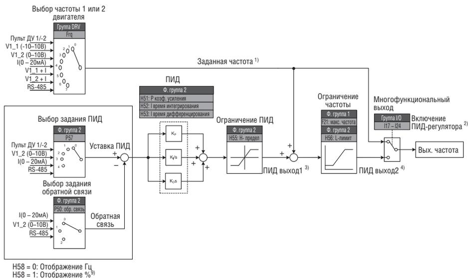
1) Сигнал задания частоты (FRQ, кроме сигнала Up/Down) суммируется с выходным сигналом PID OUT1 и ограничивается PID OUT2.
