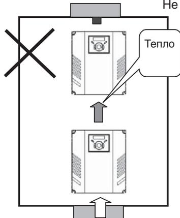
👉 **Примечание:** следует уделить внимание правильности установки частотных преобразователей и вентиляторов на панели, в плане обеспечения рассеивания тепла.
