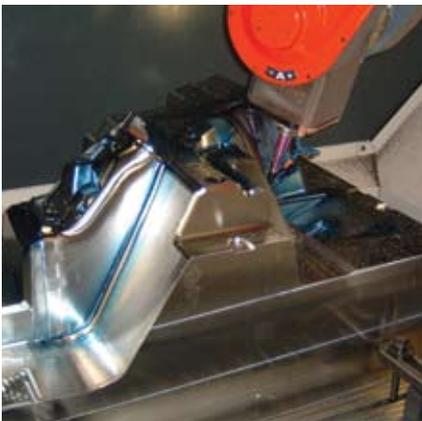
Il est aussi possible d'utiliser la fonction RTCP pour les programmes 3 axes, en positionnant manuellement la tête ou la table, la pointe de l'outil restant en contact avec la pièce.
