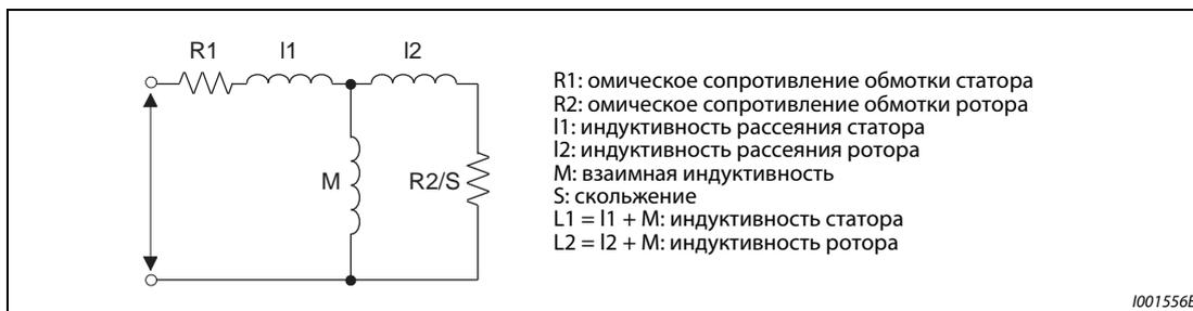
**Рис. 5-142:** Схема замещения двигателя
