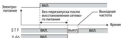
Если параметр 261 установлен на "1", "11" или "21" и после исчезновения сетевого напряжения преобразователь останавливается, то при включении пускового сигнала (STR/STF) при восстановлении питания или сбросе преобразователя перезапуск не происходит. Для повторного запуска после восстановления питания пусковой сигнал необходимо выключить и снова включить.
