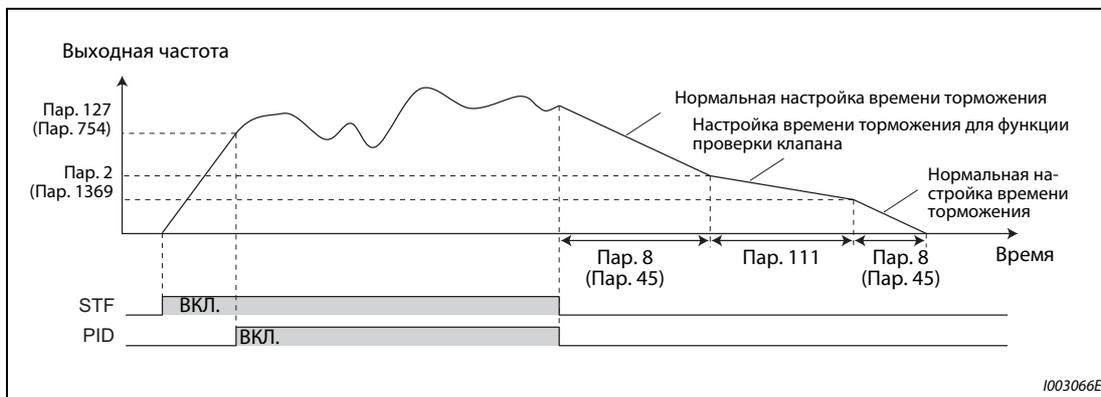
**Рис. 5-200:** Время торможения для функции проверки клапана
