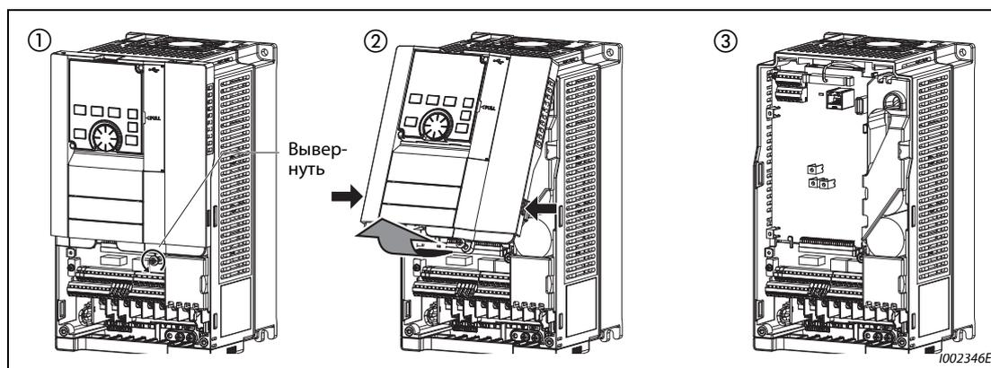
**Рис. 2-8:** Снятие верхней передней панели
