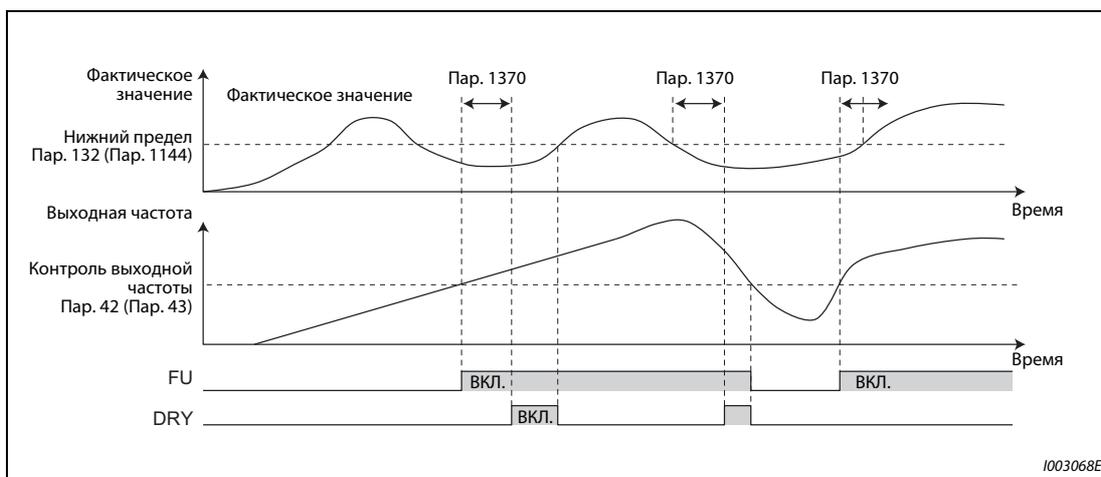
**Рис. 5-202:** ПИД-функция контроля сухого хода
