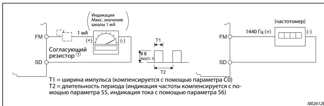
**Рис. 5-88:** Калибровка выхода FM
