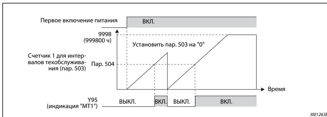
Рис. 5-11: Счетчик интервалов техобслуживания
