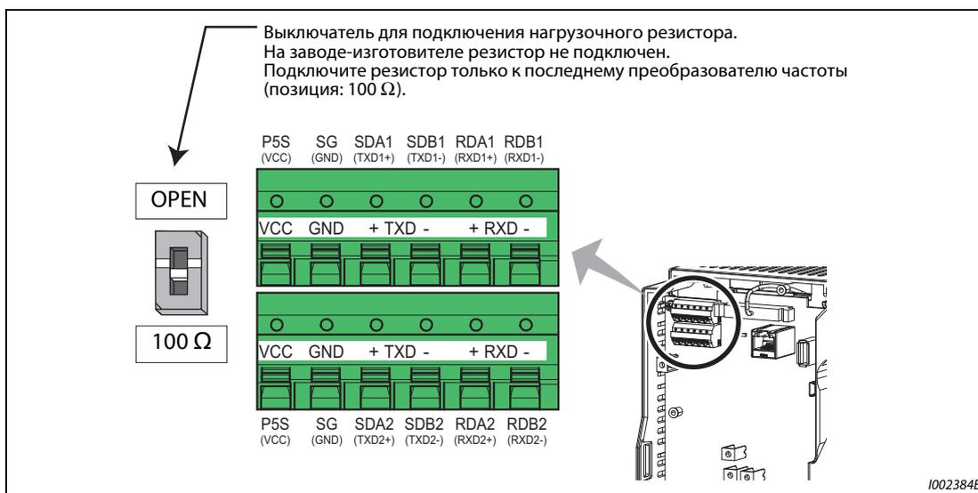
Рис. 5-224: 2-й последовательный интерфейс преобразователя частоты
