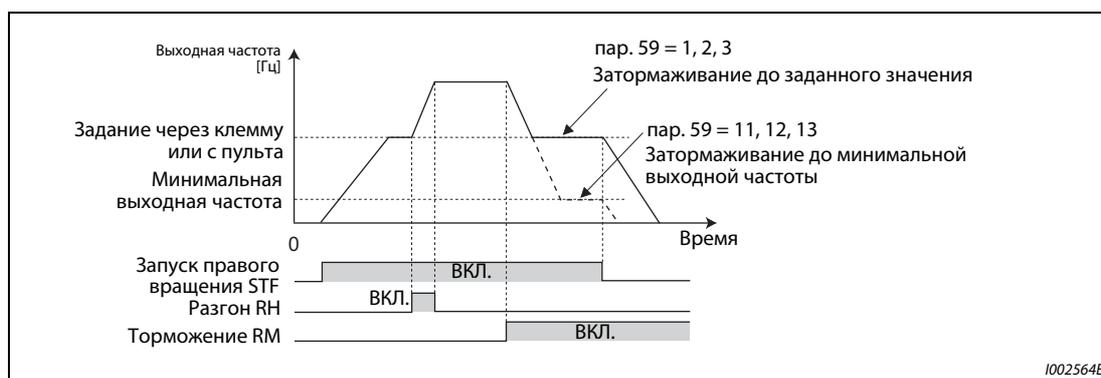
Рис. 5-27: Разгон и торможение
