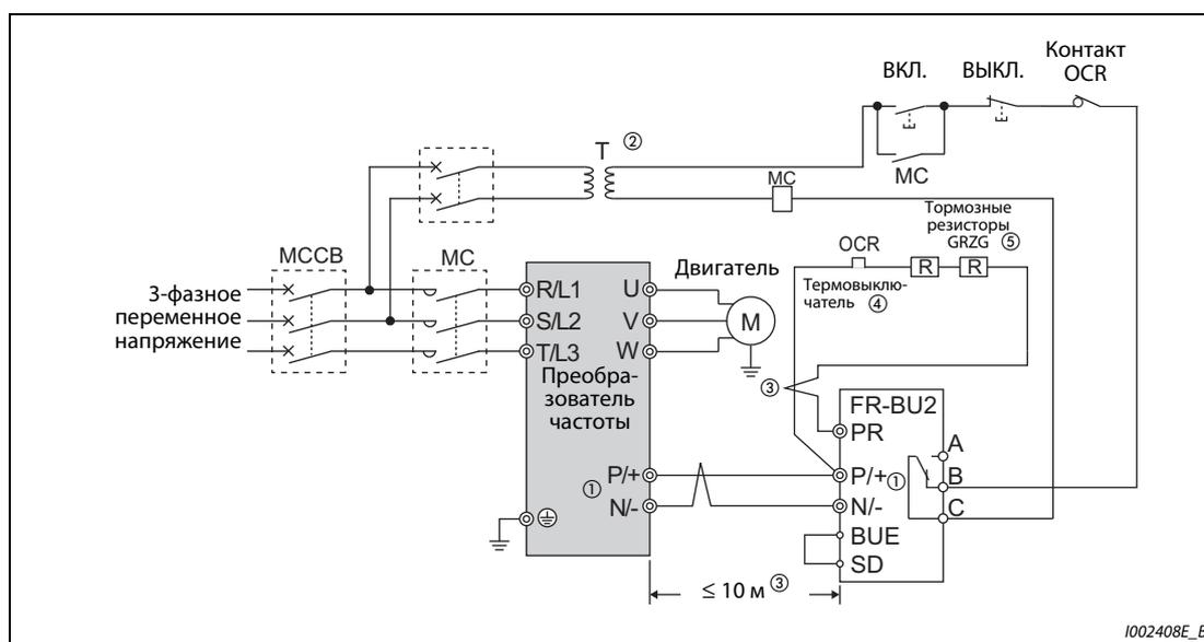
**Рис. 2-46:** Подключение тормозного блока с тормозным резистором GRZG
