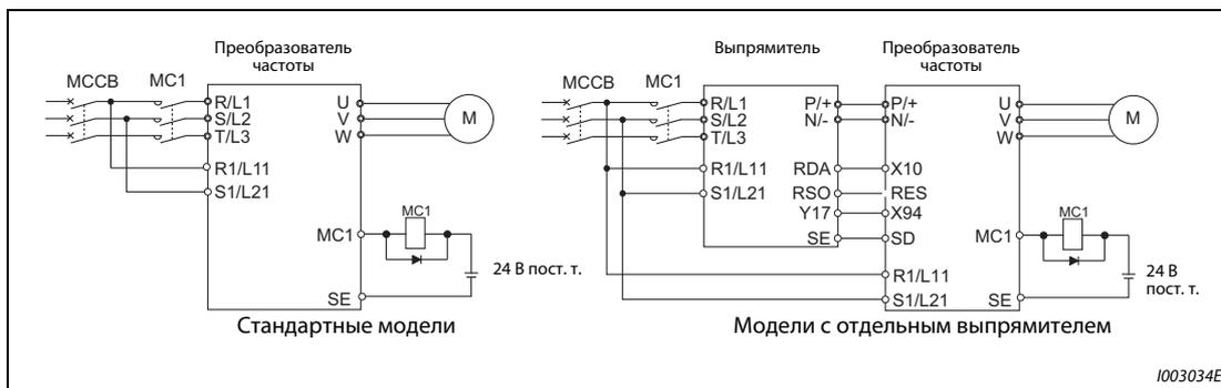
**Рис. 5-151:** Электронпитание через клеммы R1 и S1
