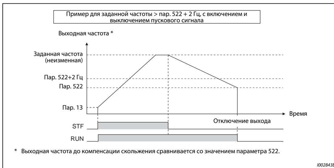
Рис. 5-253: Пример отключения выхода
