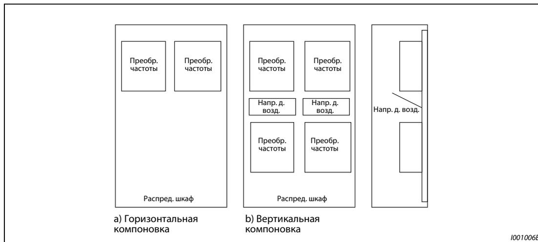
**Рис. 2-15:** Компоновка в случае установки нескольких преобразователей
