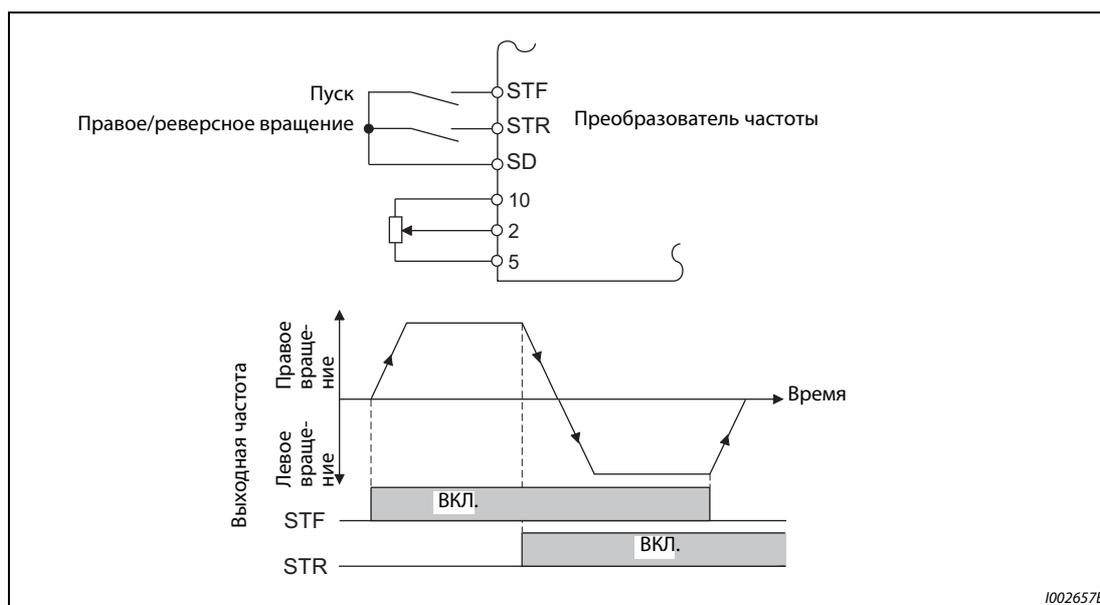
**Рис. 5-139:** Управление с помощью 2-проводной схемы управления (пар. 250 = 8888)
