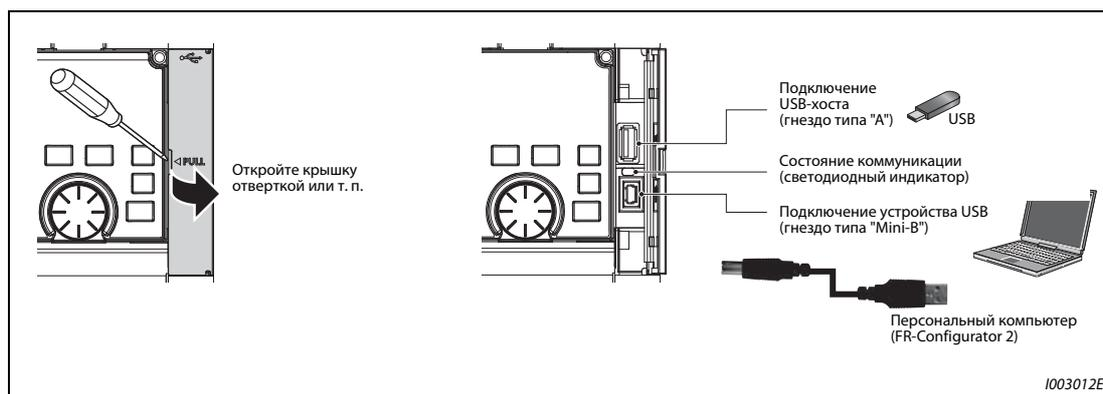
Рис. 2-44: Соединения USB
