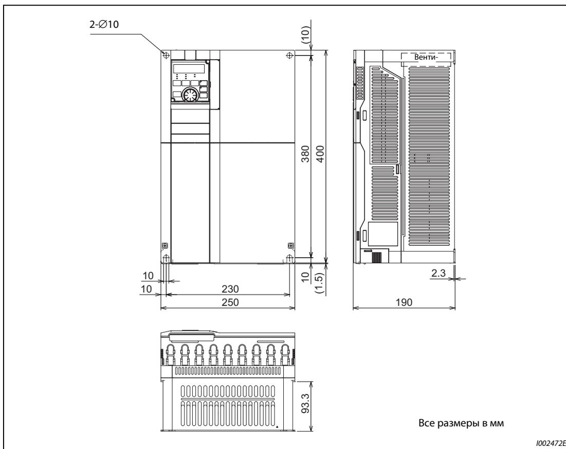
**Рис. 8-7:** Габаритно-присоединительные размеры преобразователей частоты FR-F820-00770(18.5K), 00930(22K), 01250(30K), FR-F840-00470(22K), 00620(30K)
