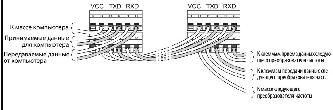
**Соединение по 2-проводной схеме**
