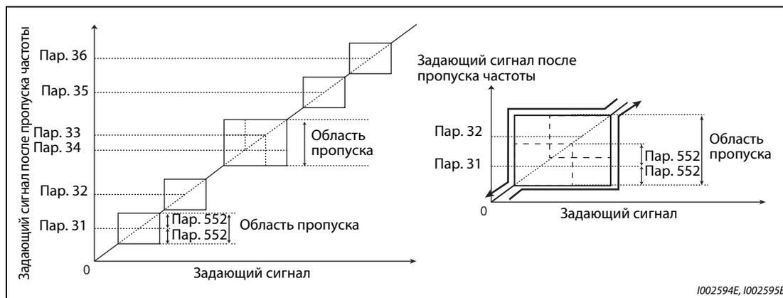
**Рис. 5-63:** 6-точечный пропуск частоты
