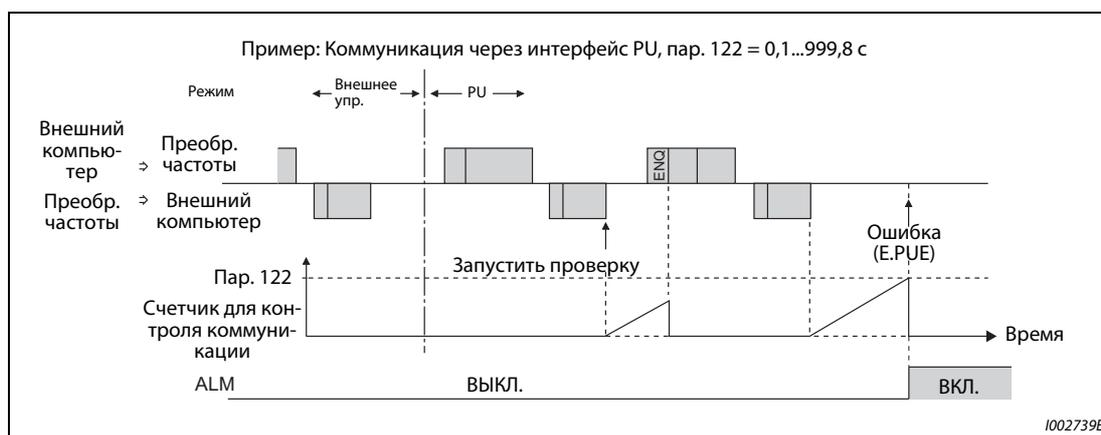
**Рис. 5-236:** Контроль на обрыв кабеля**Пример программирования**
