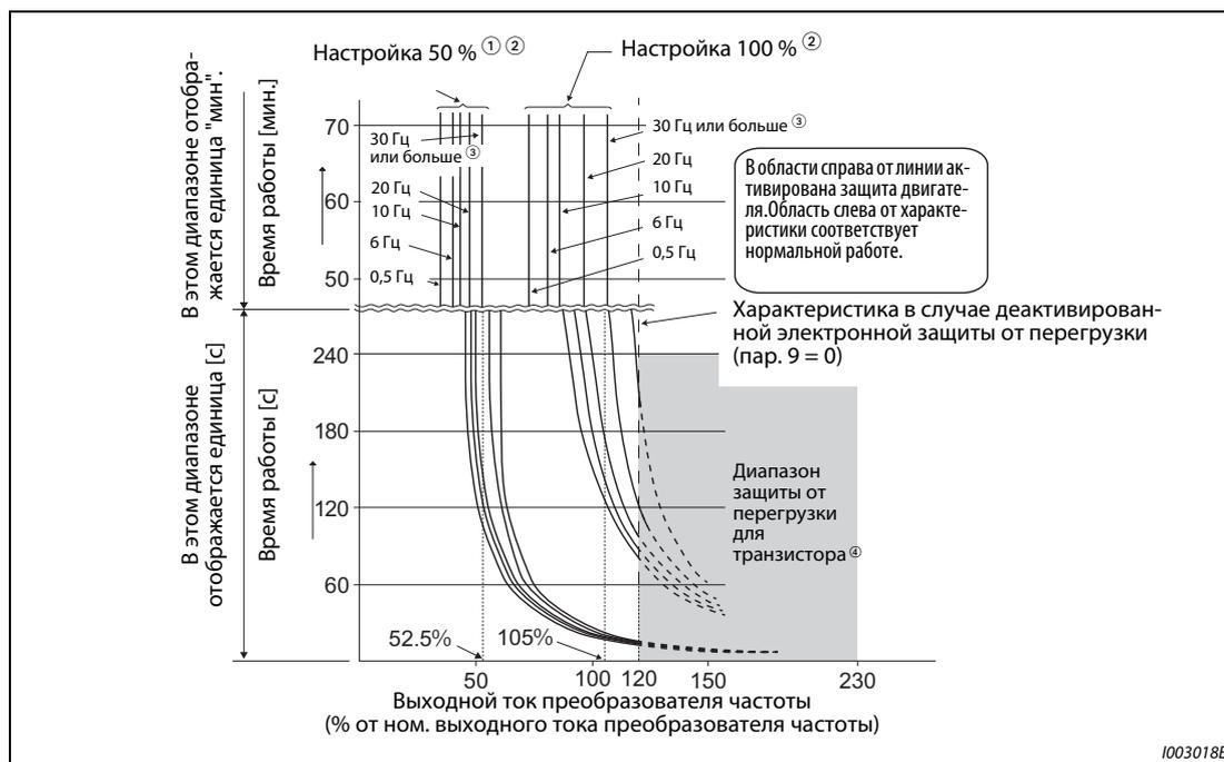
**Рис. 5-45:** Характеристики защиты двигателя
