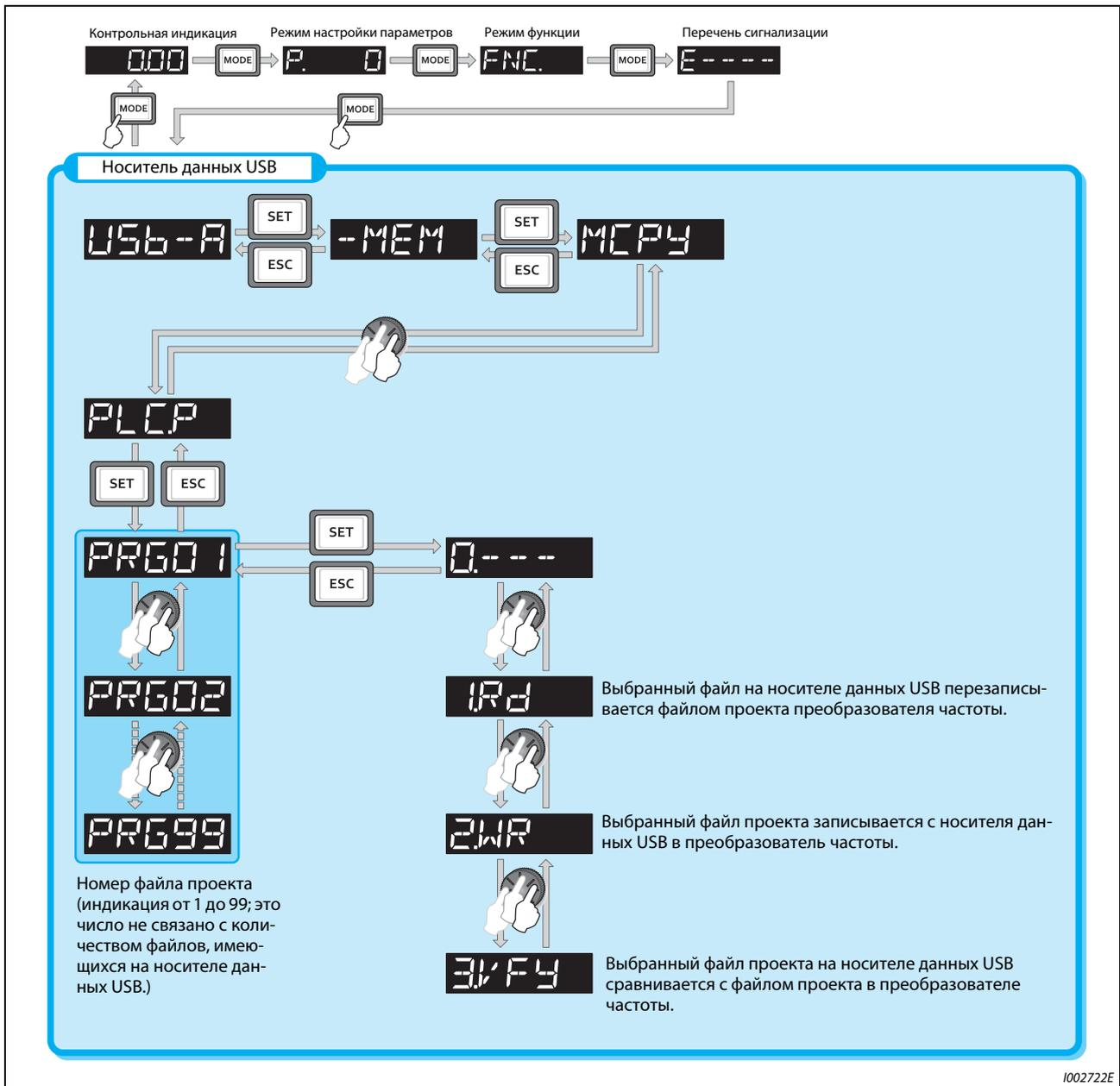
Рис. 5-217: Копирование проектных данных функции контроллера на носитель данных USB
