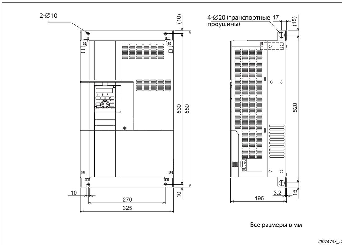
**Рис. 8-8:** Габаритно-присоединительные размеры преобразователей частоты FR-F820-01540(37K), FR-F840-00770(37K)
