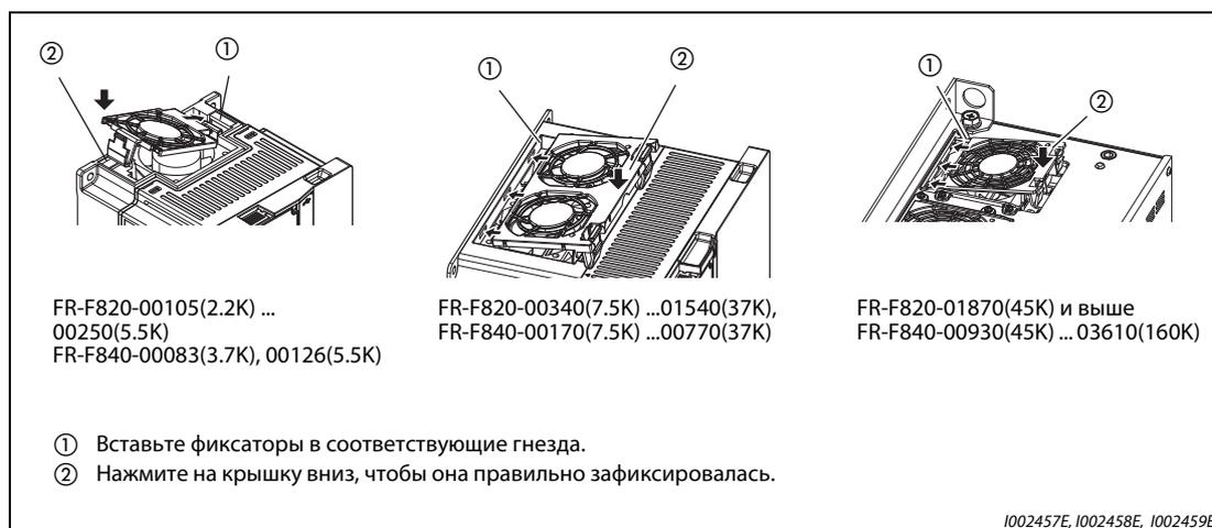
Рис. 7-6: Монтаж крышки вентилятора
