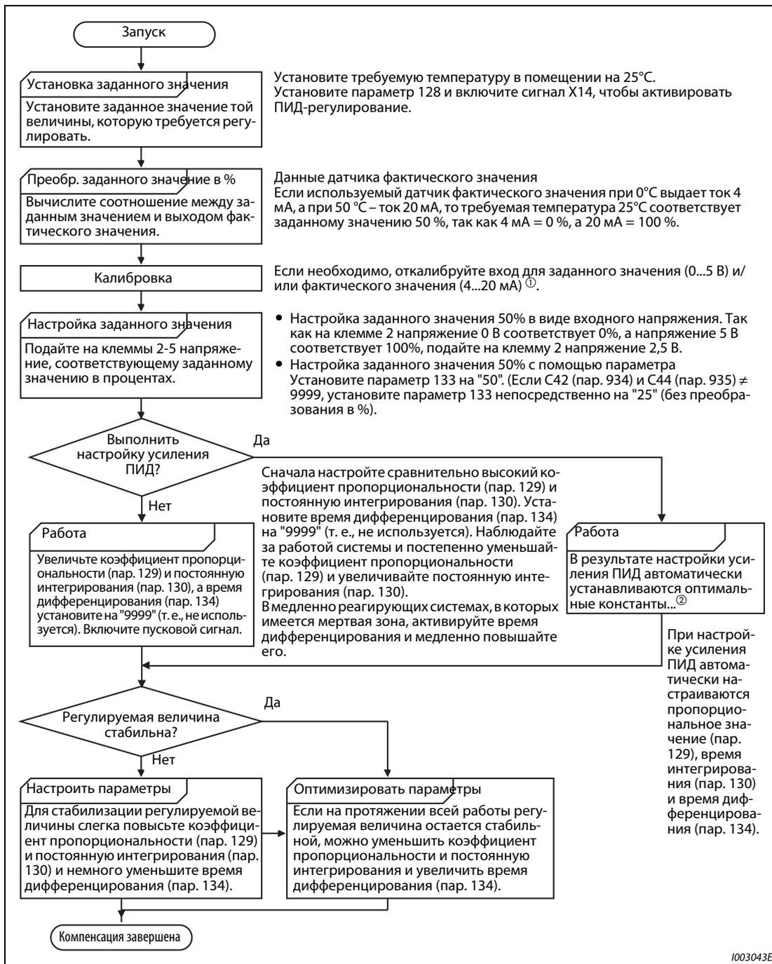
**Рис. 5-173:** Пример компенсации
