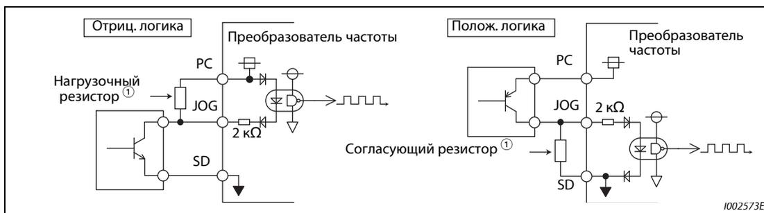
**Рис. 5-37:** Импульсный вход
