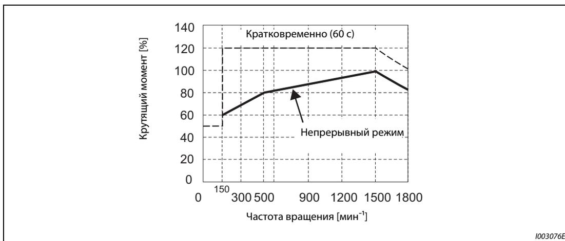
**Рис. 8-3:** Характеристика крутящего момента двигателей [ММ-ТН4 (ном. частота вращения 1500 мин<sup>-1</sup>)]
