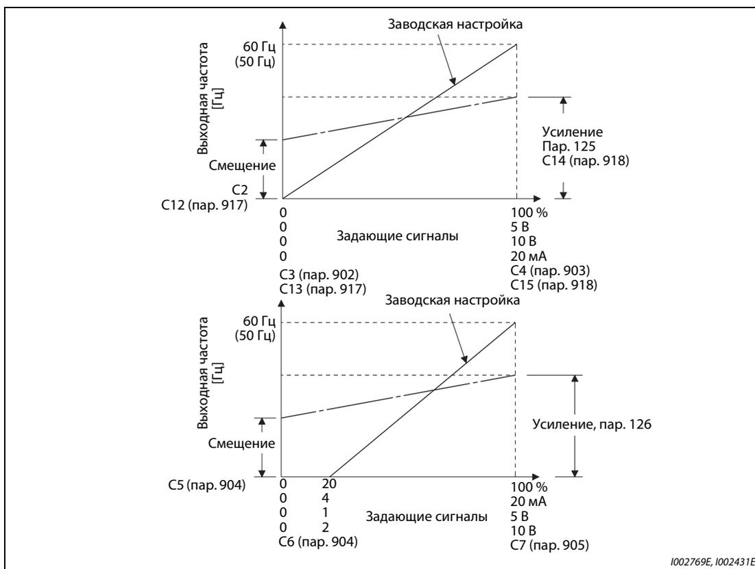
**Рис. 5-124:** Компенсация сигнала на клеммах
