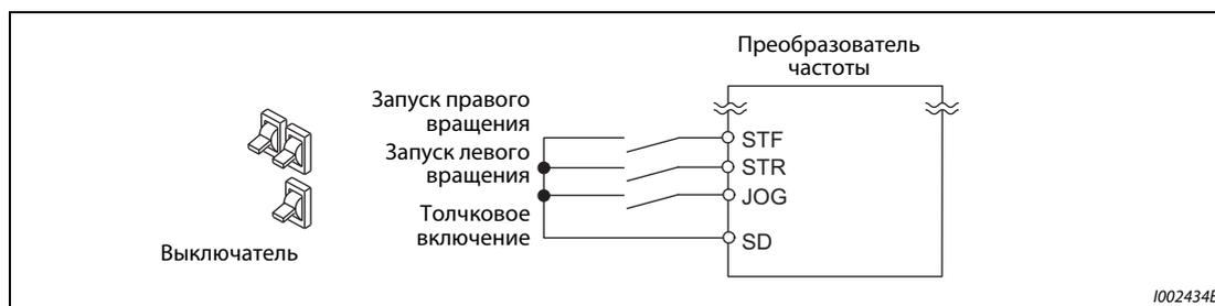
Рис. 4-12: Пример схемы для толчкового включения во внешнем режиме
