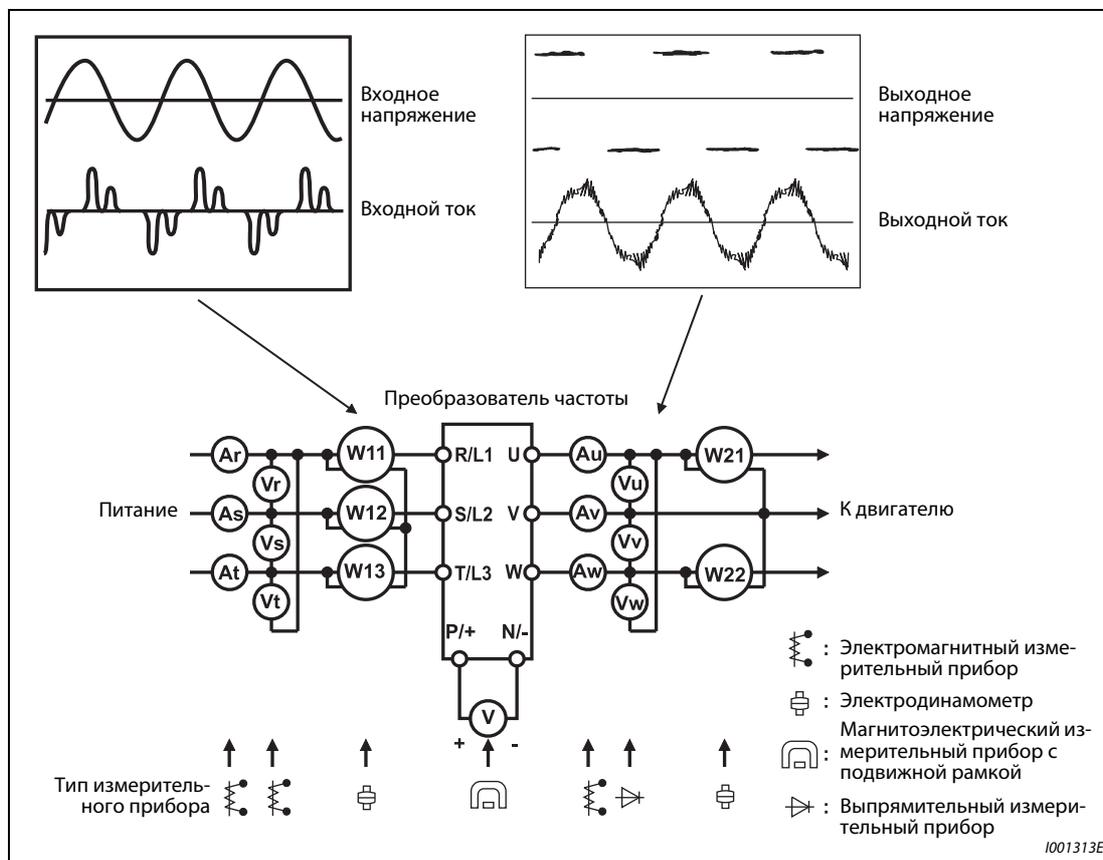
Рис. 7-11: Примеры точек измерения и измерительных приборов
