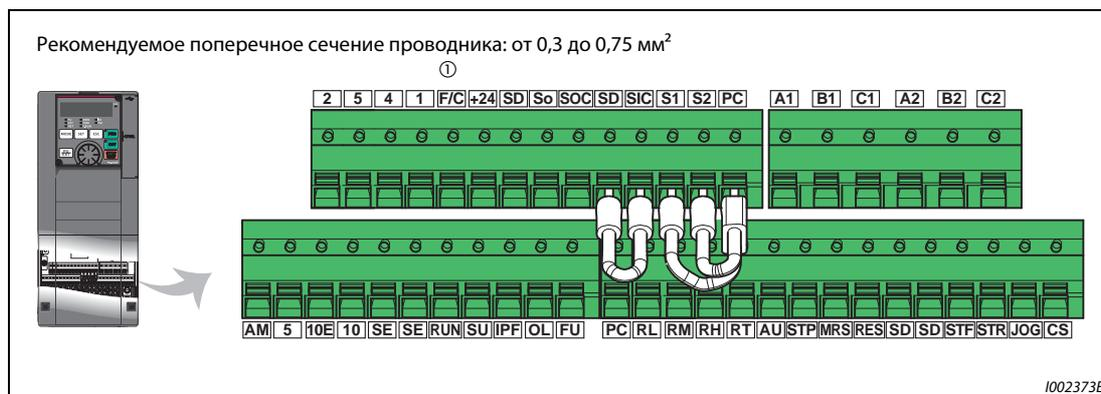
Рис. 2-28: Клеммы управляющего контура
