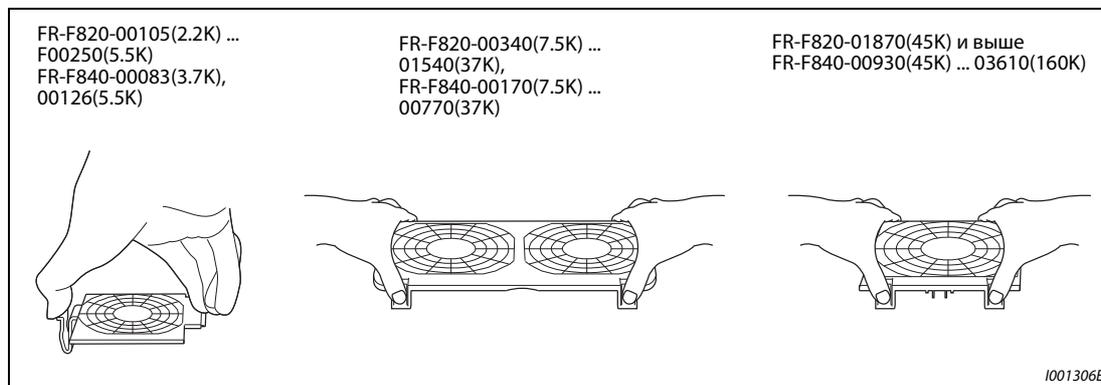
**Рис. 7-2:** Демонтаж крышки вентилятора
