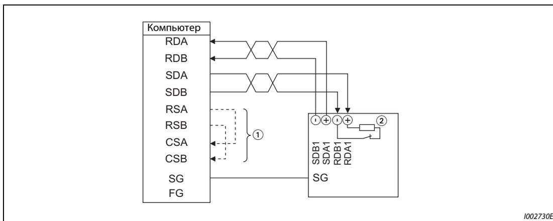
**Рис. 5-227:** Соединение с одним преобразователем частоты
