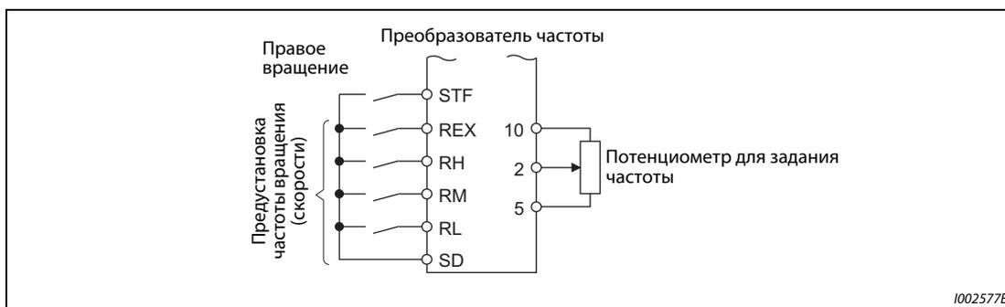
Рис. 5-43: Пример подключения
