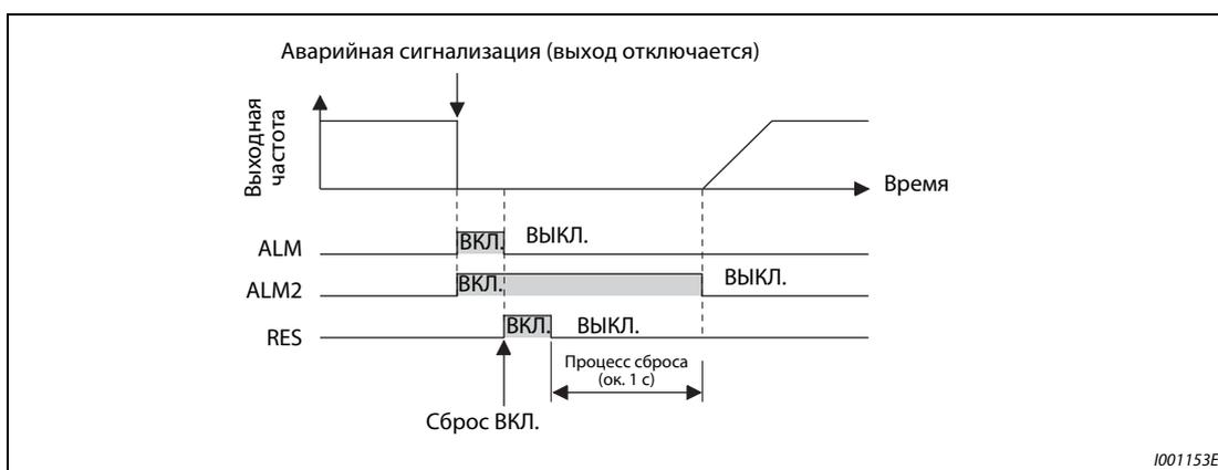
**Рис. 5-96:** Аварийный сигнал
