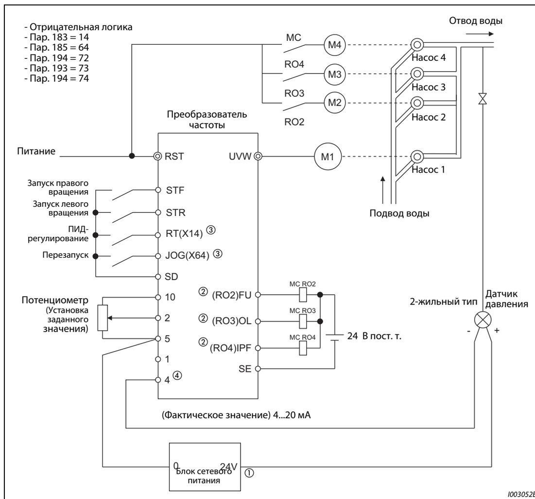
**Рис. 5-186:** Внешняя схема для многонасосного режима (стандартный режим)
