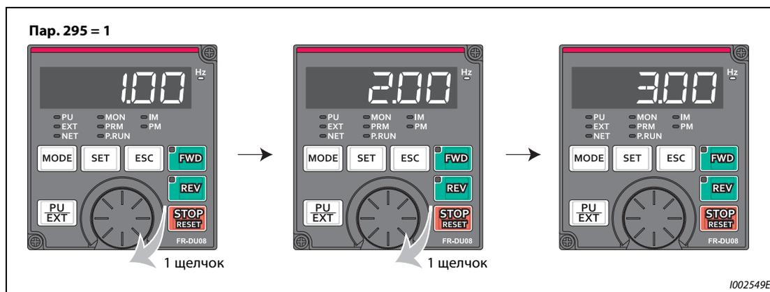
Рис. 5-9: Дискретность задания при настройке параметра 295 на "1,00"
