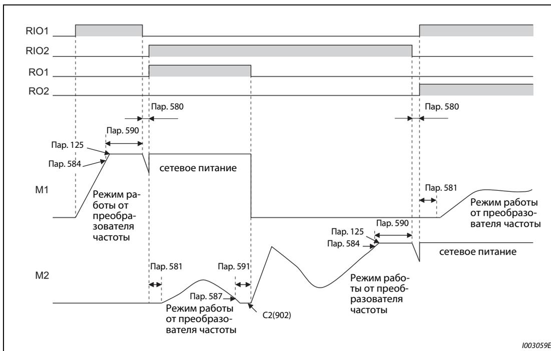
Рис. 5-193: Временная последовательность с двумя двигателями (режим переключения)
