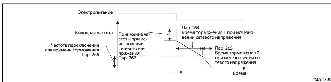
**Рис. 5-213:** Параметры метода останова при исчезновении сетевого напряжения
