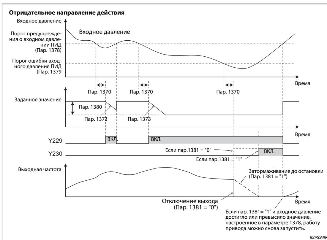
Рис. 5-203: ПИД-регулирование входного давления
