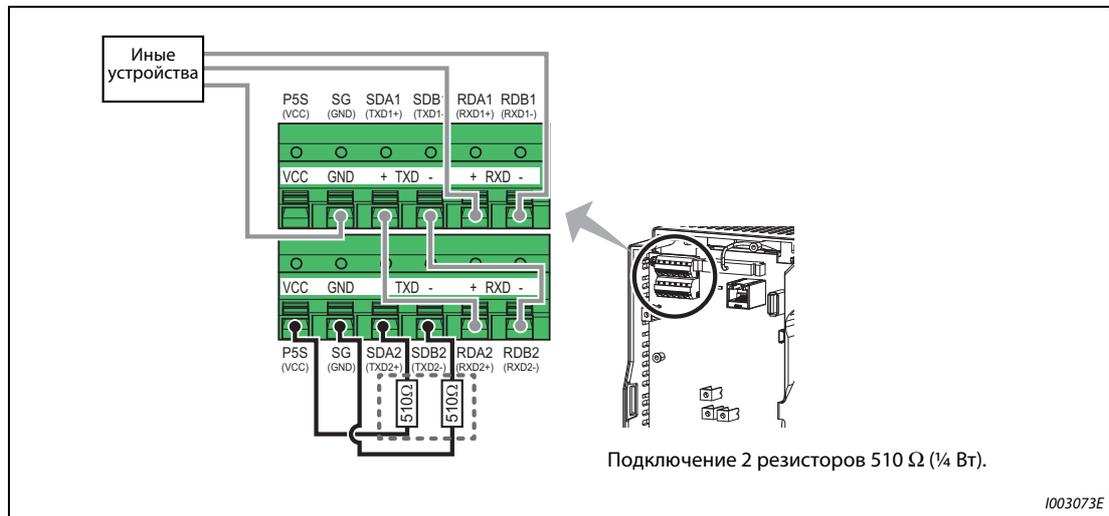
Рис. 5-242: Подключение нагрузочных резисторов к преобразователю частоты
