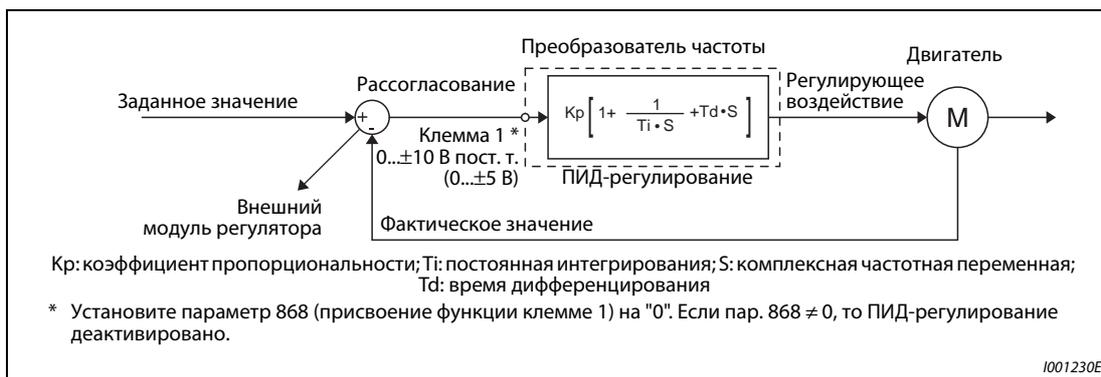
**Рис. 5-159:** Конфигурация системы для пар. 128 = 10, 11 (использование внешнего компаратора)
