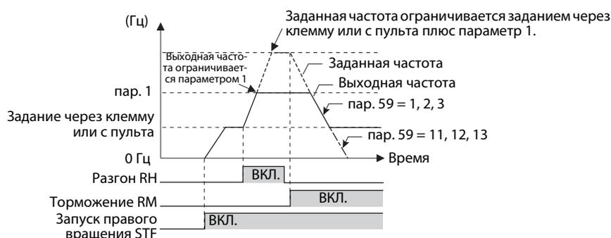
При выключенном пусковом сигнале (STF или STR) включение клеммы RH (разгон) или RM (торможение) изменяет предварительно настроенную выходную частоту.
