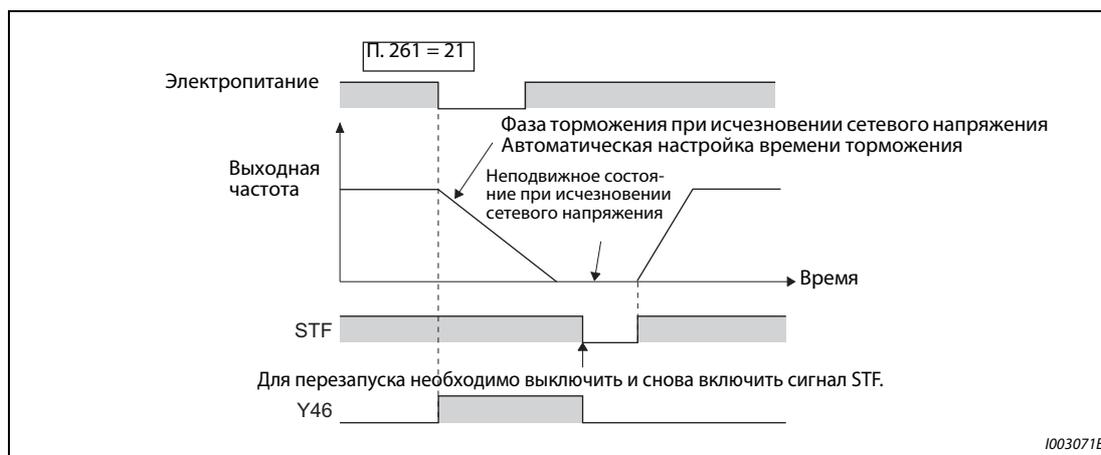
**Рис. 5-216:** Автоматическая настройка времени торможения
