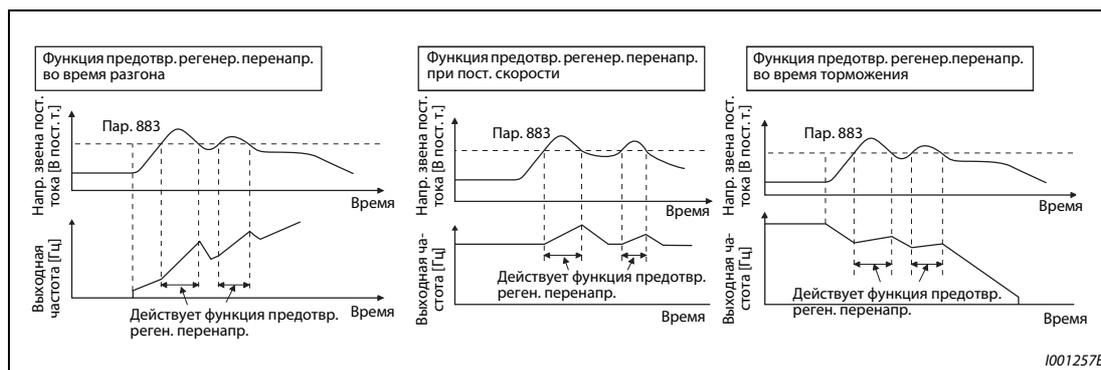
**Рис. 5-263:** Функция предотвращения регенеративного перенапряжения**ПРИМЕЧАНИЯ**
