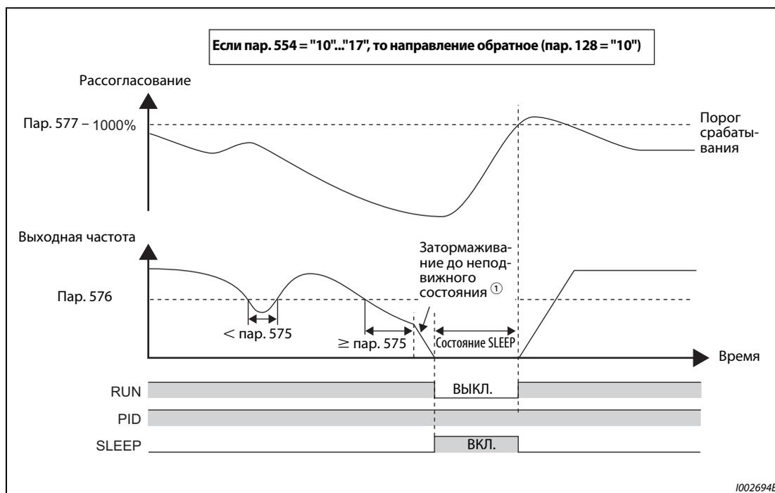
**Рис. 5-172:** Отключение выхода (функция SLEEP)
