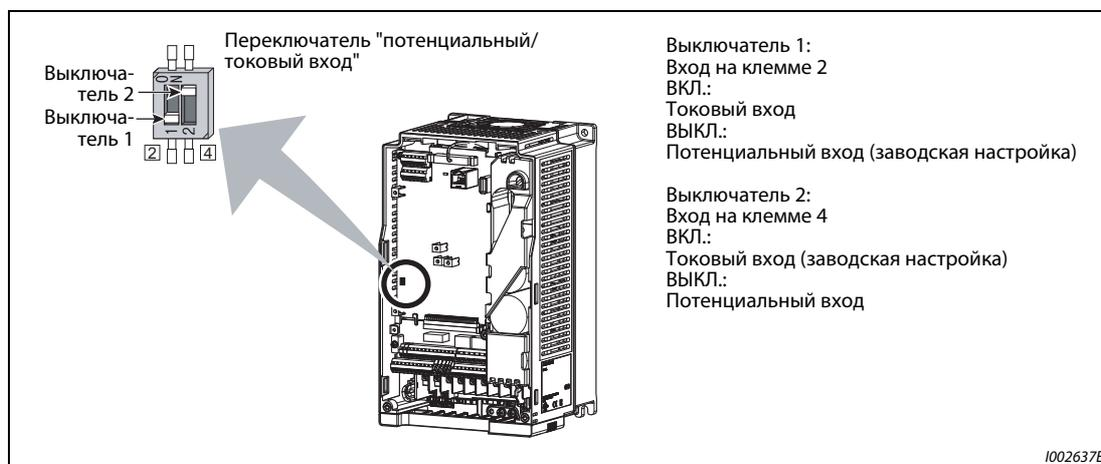
**Рис. 5-111:** Переключатель "потенциальный/токовый вход"
