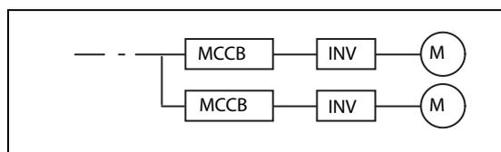
**Рис. 2-4:** Компоновка силовых выключателей I002770E
