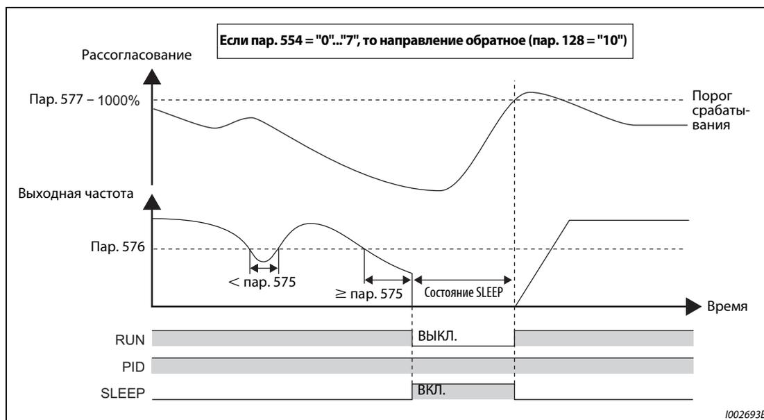
**Рис. 5-171:** Отключение выхода (функция SLEEP)
