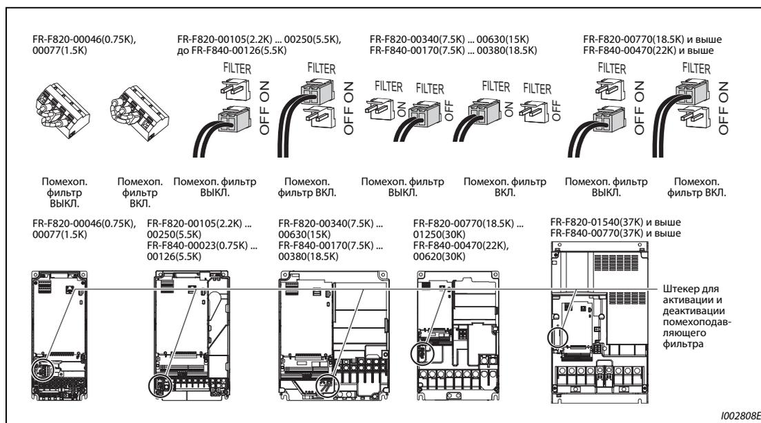
Рис. 3-7: Внутренний помехоподавляющий фильтр
