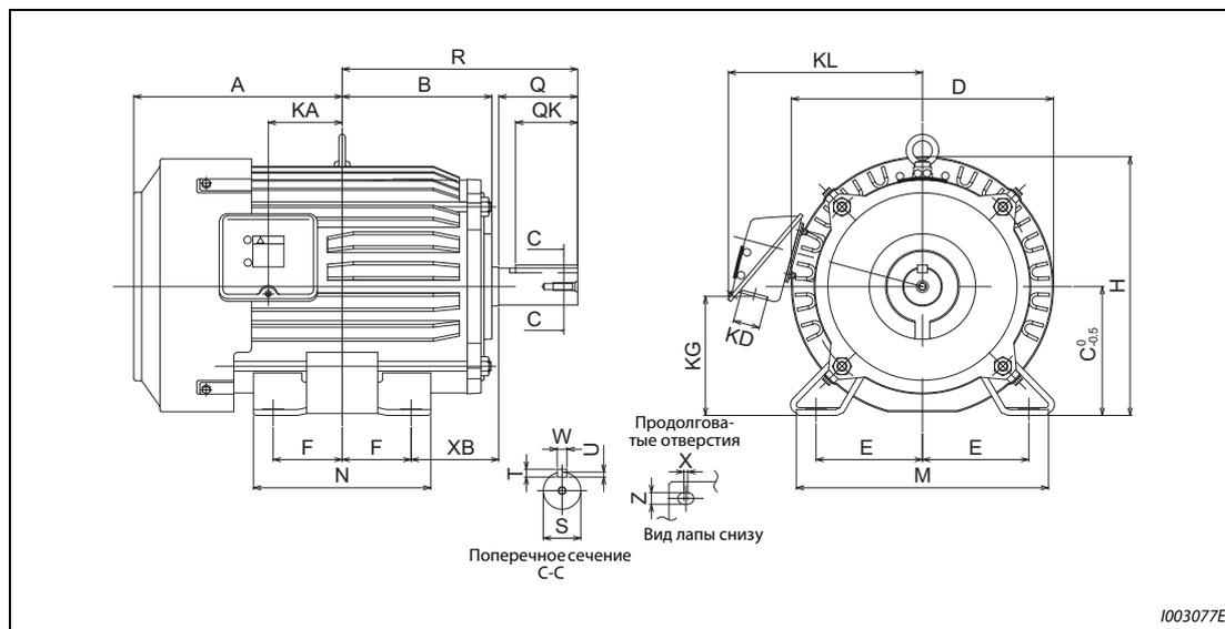
Рис. 8-13: Габаритно-присоединительные размеры MM-EFS (ном. частота вращения 1500 мин<sup>-1</sup>, до 30К
