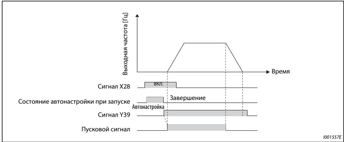
Рис. 5-143: Запуск онлайн-автонастройки параметров двигателя по внешнему сигналу
