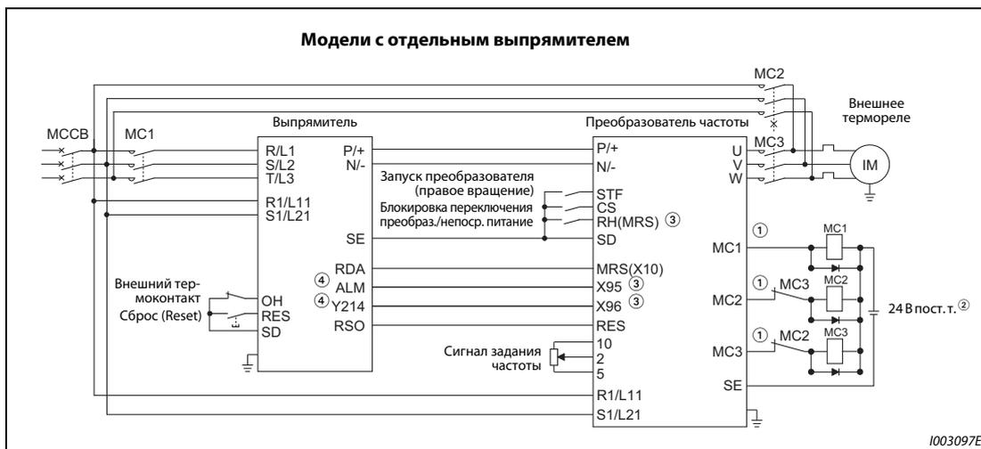
Рис. 5-146: Подключение силовых контакторов (модели с отдельным выпрямителем)
