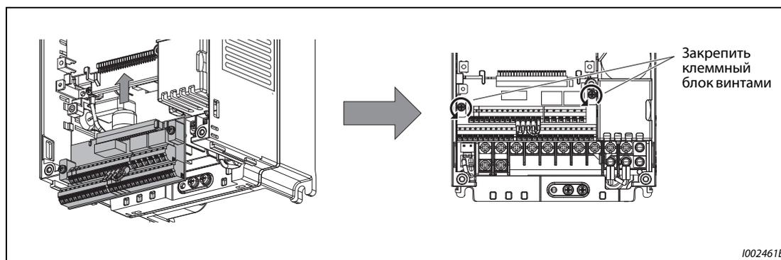
**Рис. 7-10:** Монтаж клеммного блока
