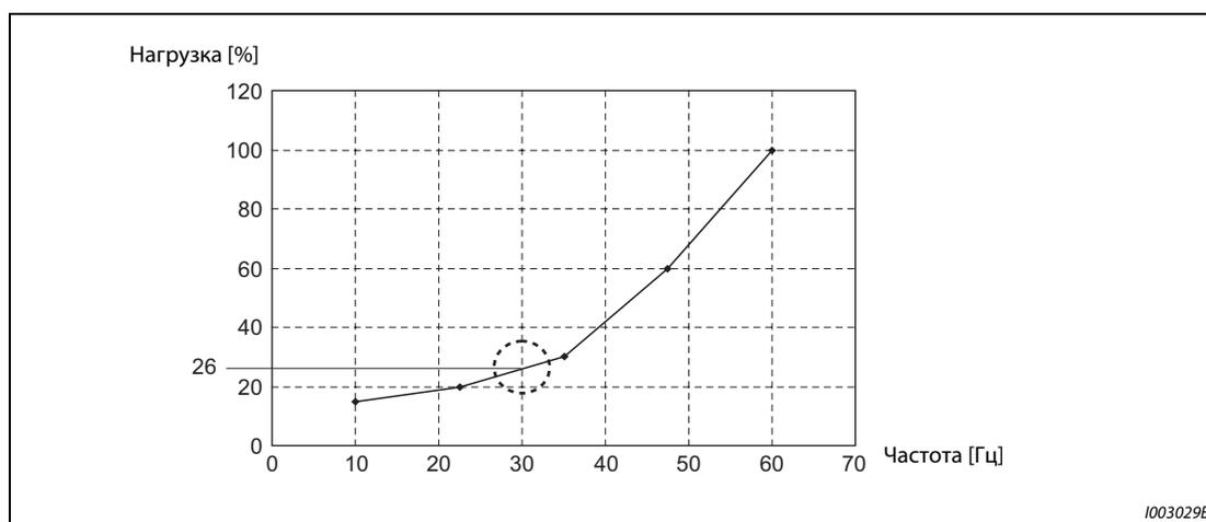
**Рис. 5-74:** Опорное значение при выходной частоте 30 Гц**ПРИМЕЧАНИЕ**
