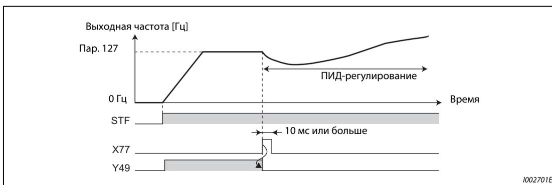
**Рис. 5-182:** Назначение сигнала X77 (пар. 178...189)
