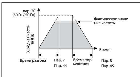
**Рис. 5-17:** Время разгона/торможения
