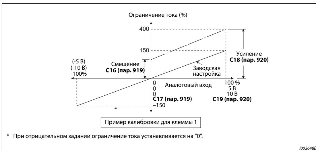
Рис. 5-125: Компенсация сигнала на клемме 1
