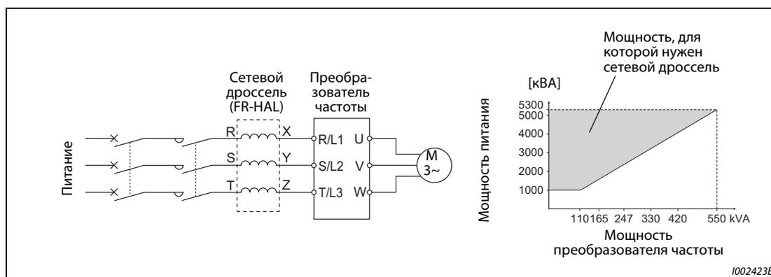
Рис. 3-11: Подключение сетевого дросселя
