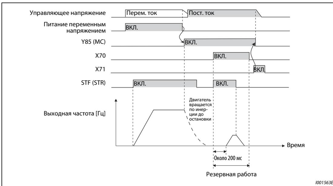
Рис. 5-260: Пример 1 работы при исчезновении сетевого напряжения
