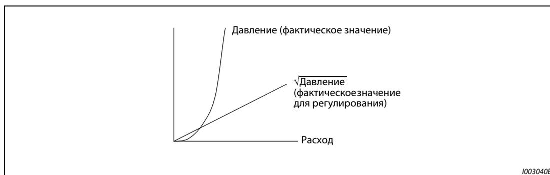
**Рис. 5-167:**  $\text{Расход} \propto \sqrt{\text{давление}}$
