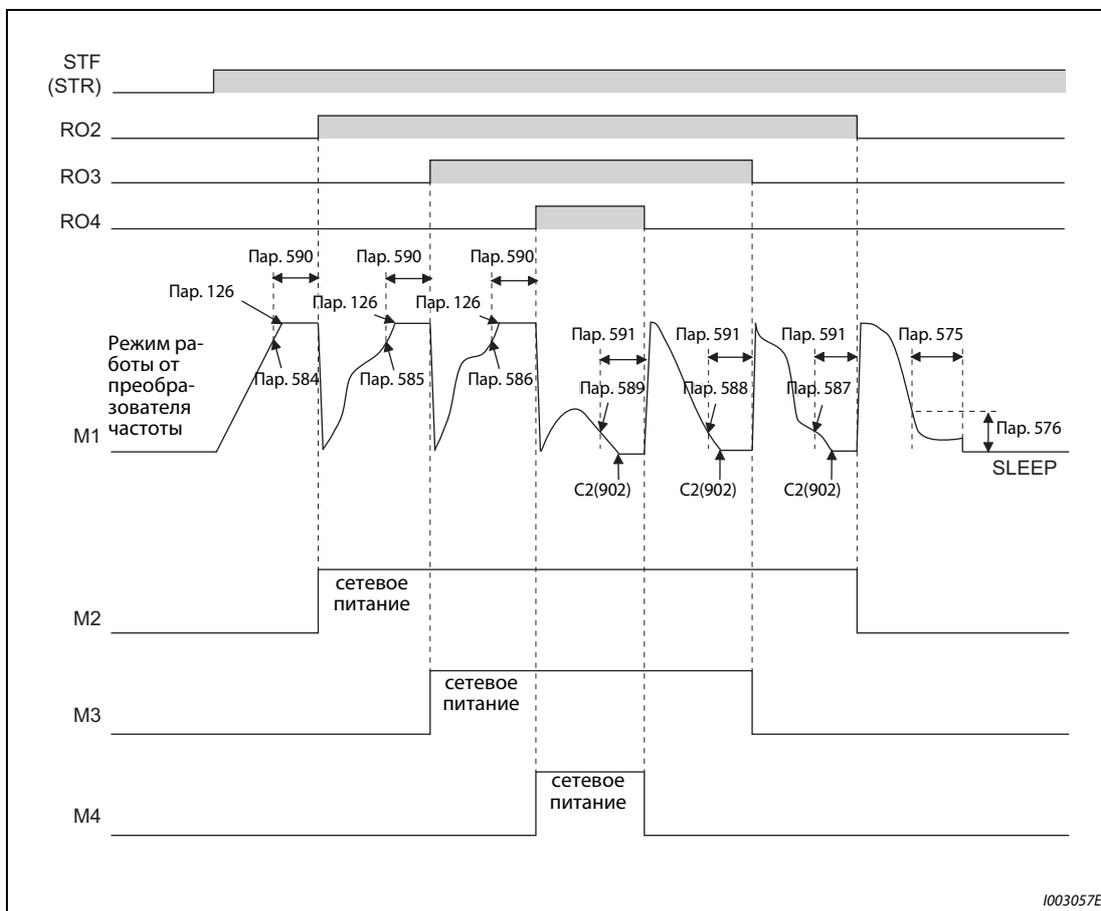
**Рис. 5-191:** Временная последовательность с четырьмя двигателями (стандартный режим)
