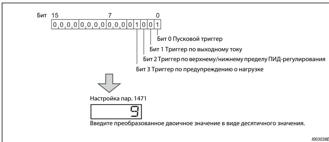
**Рис. 5-157:** Установка битов 0...3 в параметре 1471
