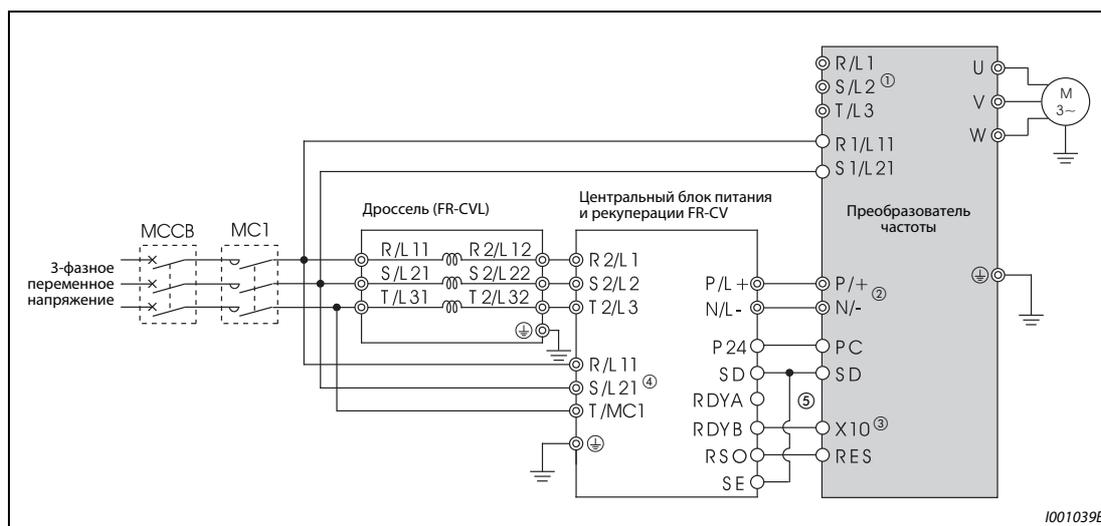
**Рис. 2-52:** Подключение центрального блока питания и рекуперации FR-CV
