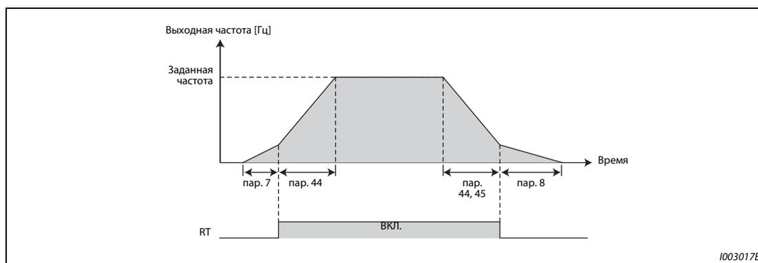
Рис. 5-18: Изменение времени разгона/торможения с помощью сигнала RT
