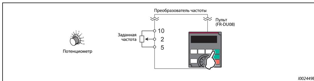
**Рис. 5-36:** Режим комбинированного управления 2
