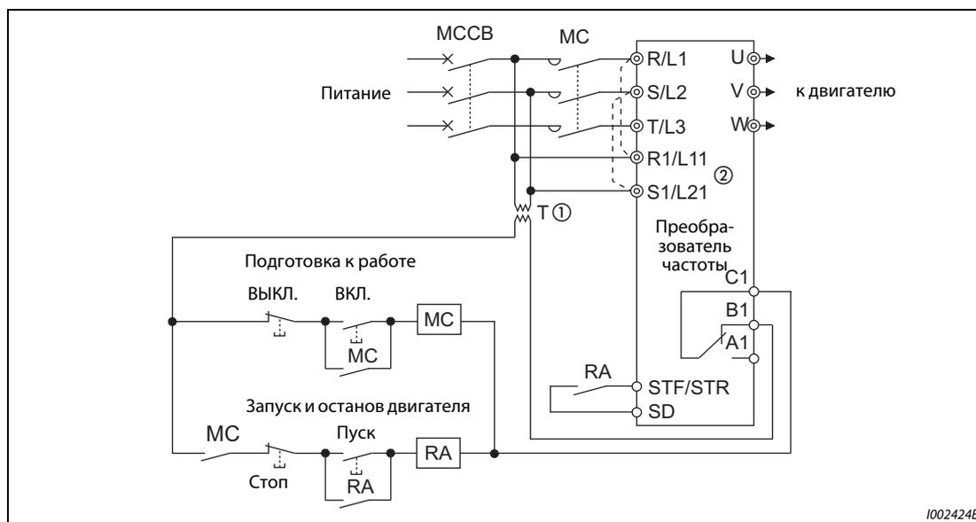
**Рис. 3-12:** Запуск/останов преобразователя частоты
