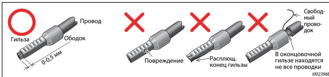
**Рис. 2-30:** Опрессовка оконцовочной гильзы
