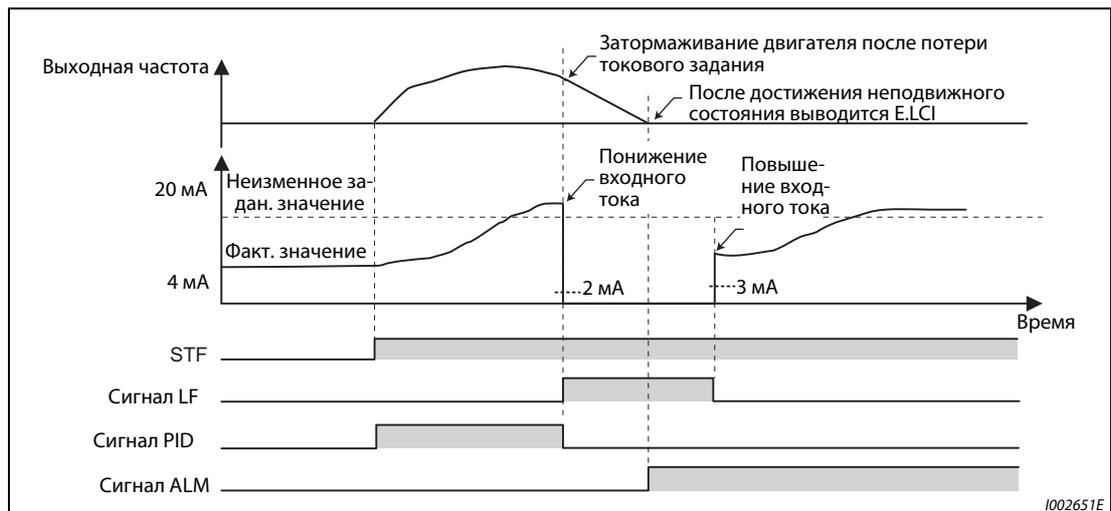
**Рис. 5-131:** Сообщение о неполадке после затормаживания до неподвижного состояния (пар. 573 = 3)
