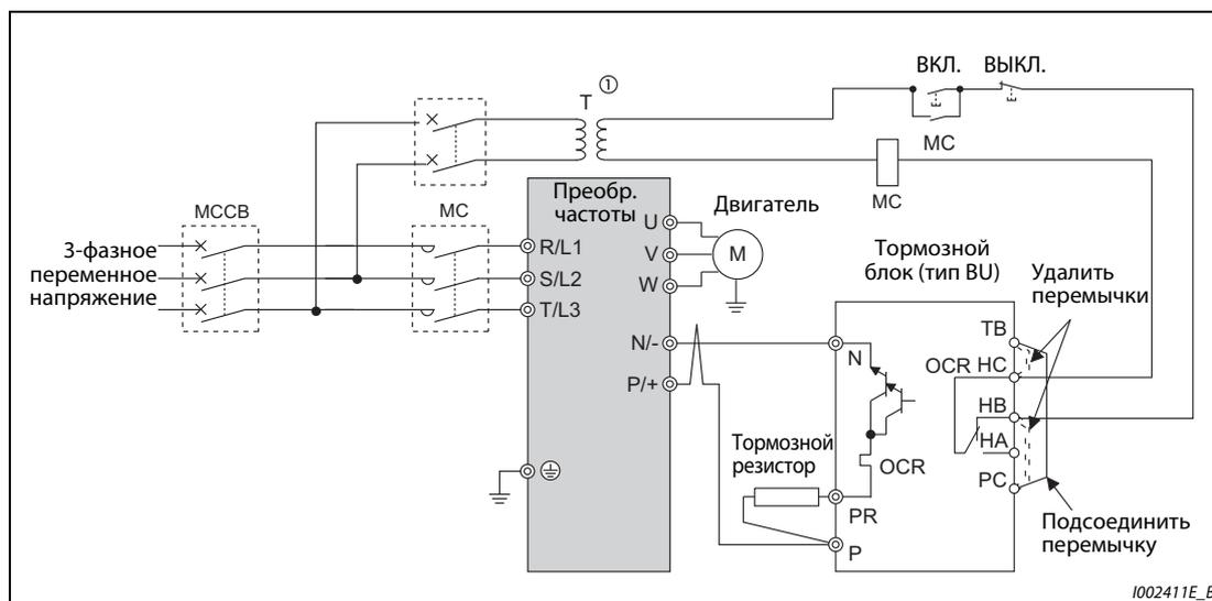
Рис. 2-50: Подключение тормозного блока типа ВU
