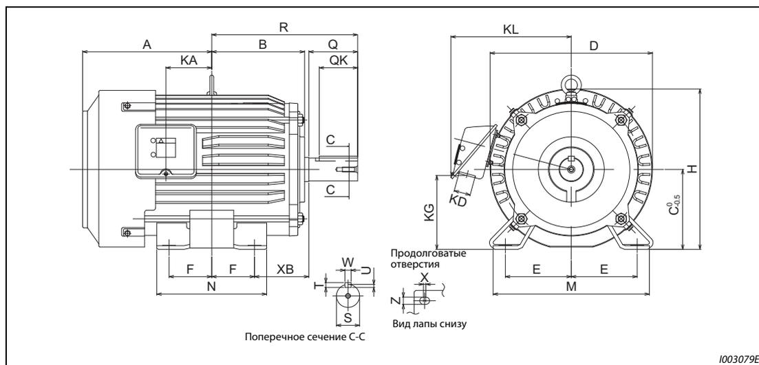
**Рис. 8-15:** Габаритно-присоединительные размеры MM-EFS (ном. частота вращения 3000 мин<sup>-1</sup>)
