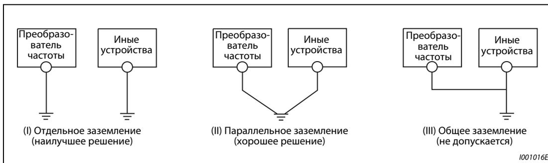
**Рис. 2-23:** Заземление системы привода
