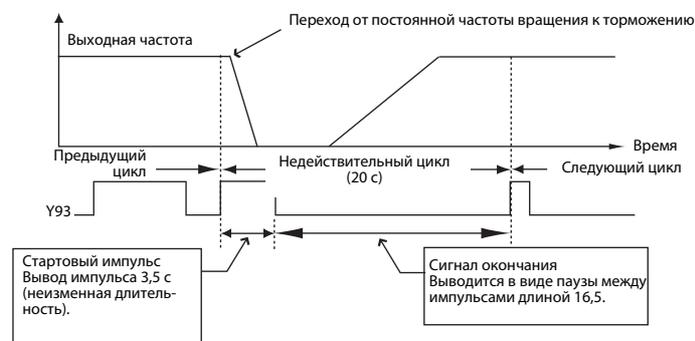
Если по окончании первого цикла выходной ток (индикация выходного тока) равен 0 А, то до следующей работы на постоянной частоте вращения сигнал Y93 более не выводится.
