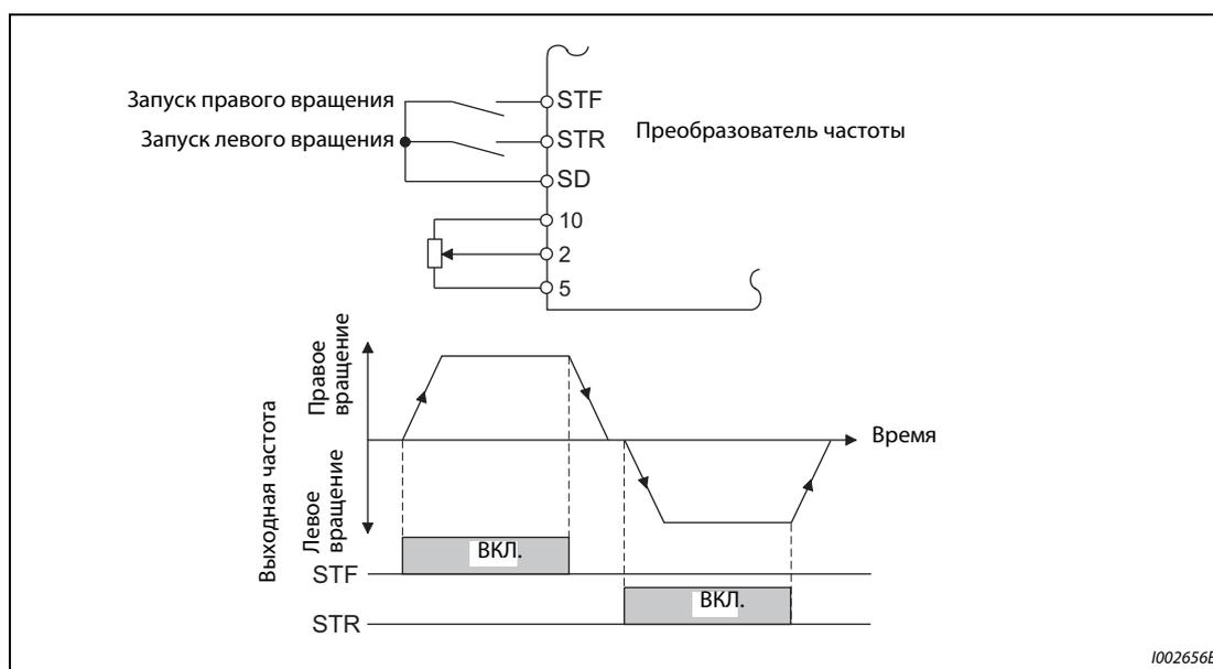
Рис. 5-138: Управление с помощью 2-проводной схемы управления (пар. 250 = 9999)
