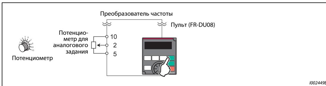
**Рис. 4-6:** Поддача заданного значения в виде аналогового потенциального сигнала с помощью потенциометра
