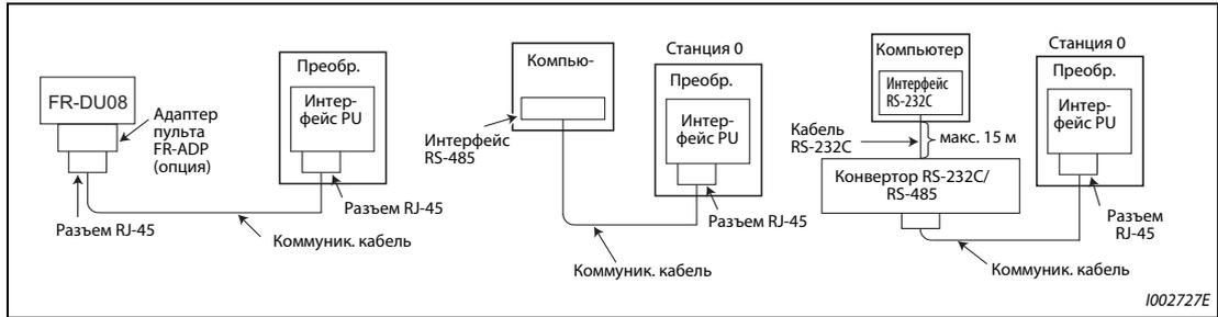
**Рис. 5-222:** Подключение интерфейса PU
