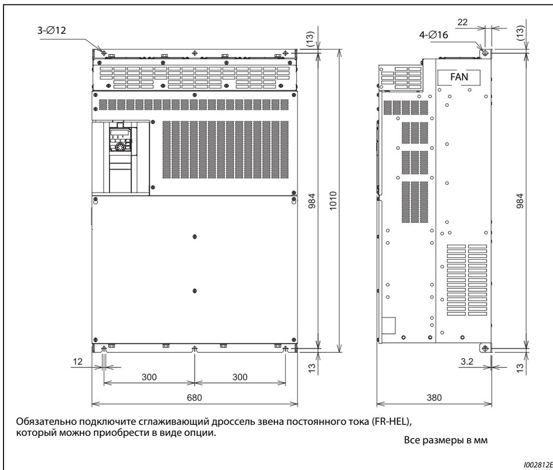
**Рис. 8-11:** Габаритно-присоединительные размеры преобразователей частоты FR-F840-05470(250K), 06100(280K), 06830(315K)
