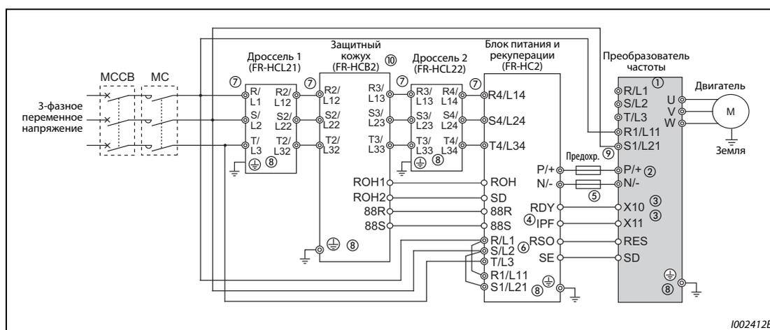
Рис. 2-51: Подключение блока питания и рекуперации FR-HC2
