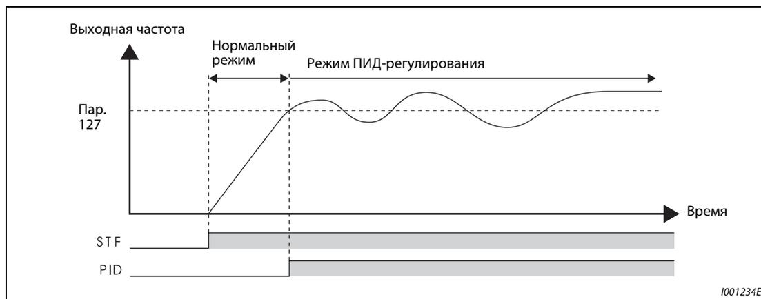
**Рис. 5-168:** Автоматическое переключение в режим ПИД-регулирования
