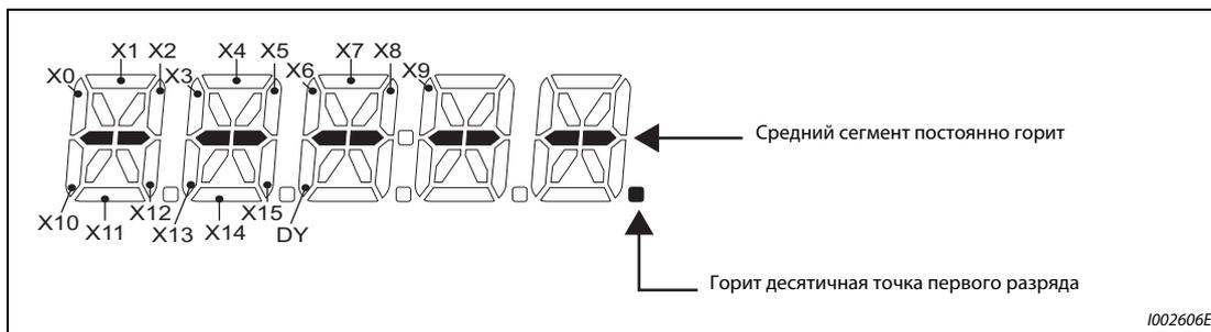
**Рис. 5-79:** *Индикация при установленной опции FR-A8AX*
