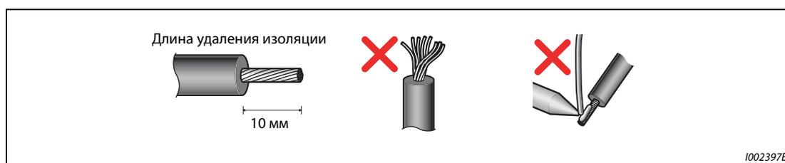
Рис. 2-29: Подготовка провода
