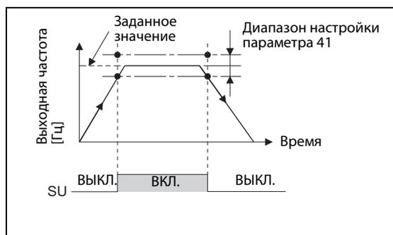
**Рис. 5-97:** Диаграмма срабатывания выходного сигнала на клемме SU
