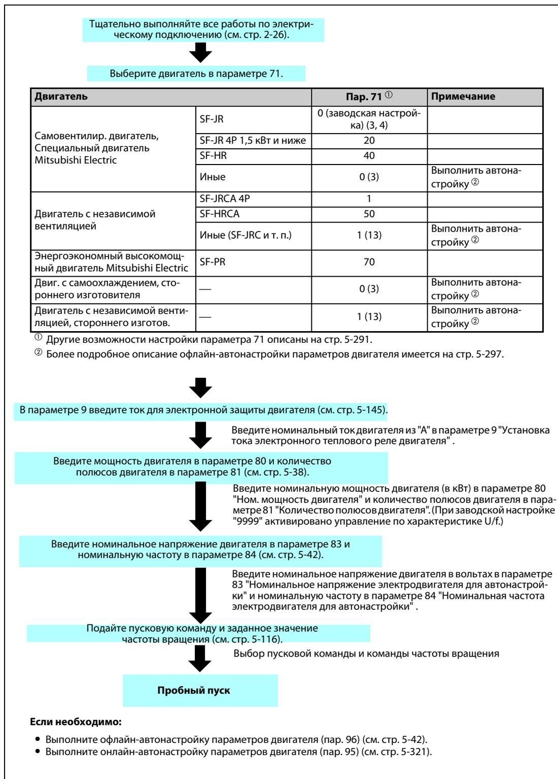
Рис. 5-2: Метод выбора расширенного управления вектором потока
