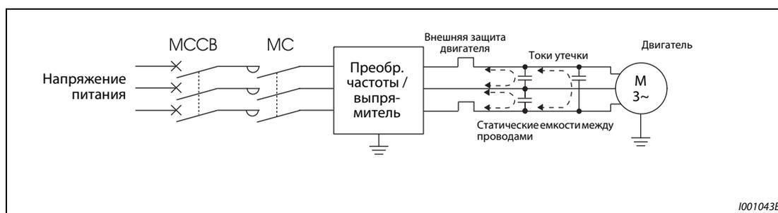
**Рис. 3-1:** Емкостные токи утечки
