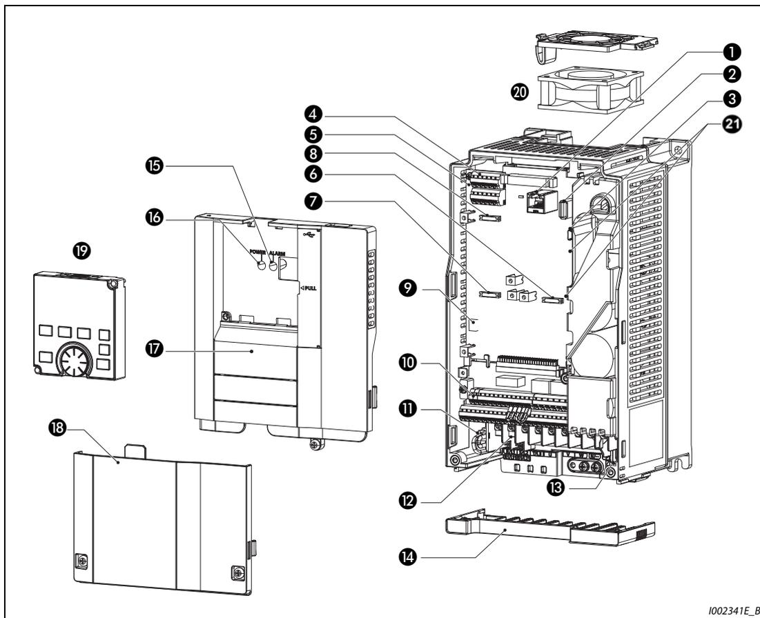
Рис. 1-2: Конструкция преобразователя частоты
