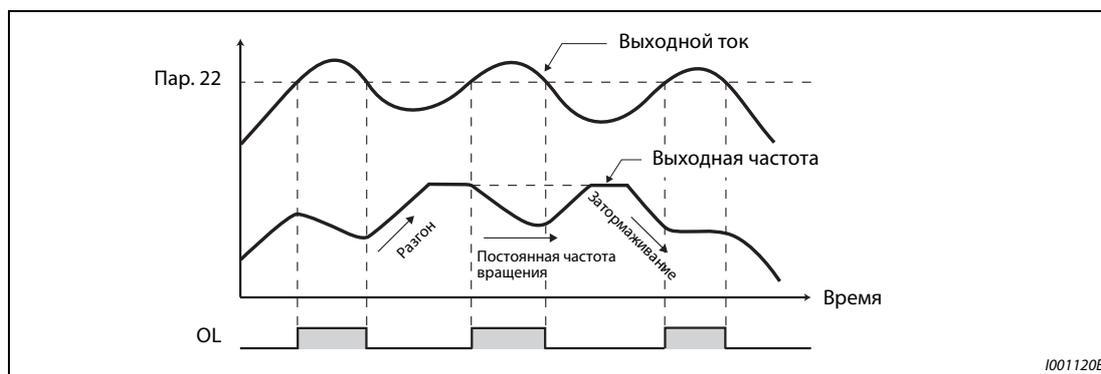
Рис. 5-64: Принцип работы ограничения тока
