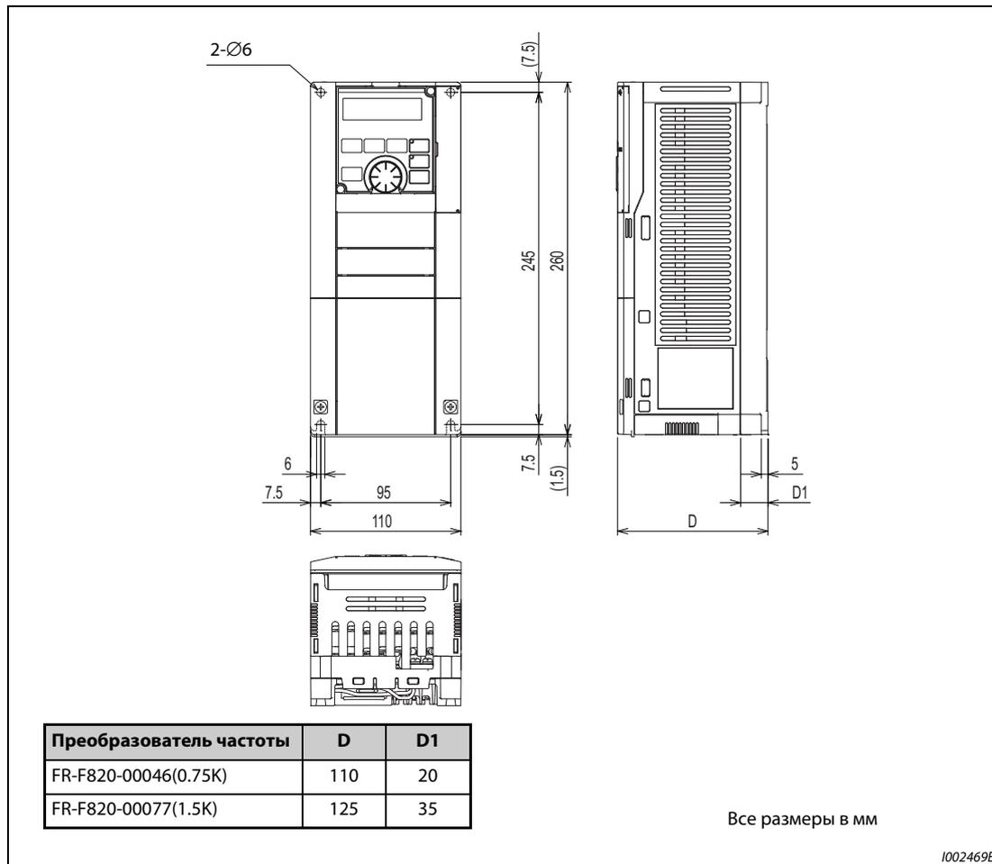
**Рис. 8-4:** Габаритно-присоединительные размеры преобразователей частоты FR-F820-00046(0.75K), FR-F820-00077(1.5K)
