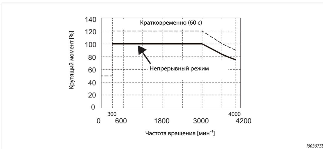
**Рис. 8-2:** Характеристика крутящего момента двигателей [MM-EFS (ном. частота вращения 3000 мин<sup>-1</sup>)]
