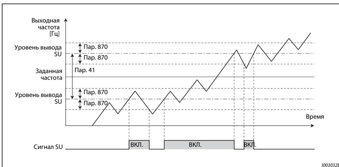
**Рис. 5-100:** Пример для сигнала "Частота достигнута" (SU)
