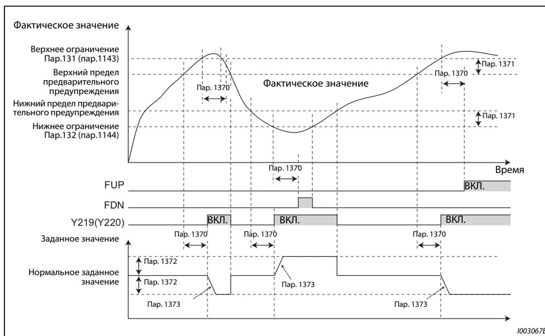
**Рис. 5-201:** Функция предварительного предупреждения о верхнем/нижнем пределе ПИД-регулирования
