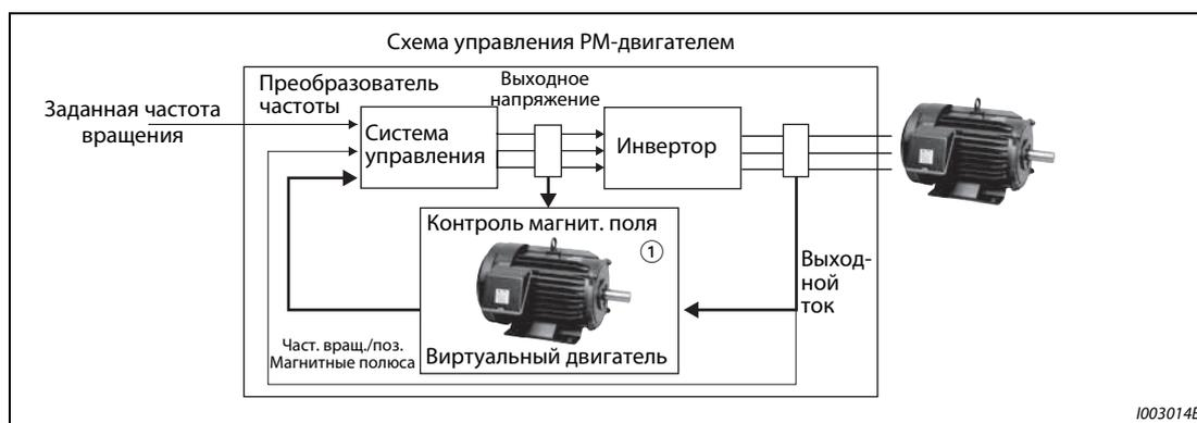
**Рис. 5-1:** Схема управления PM-двигателем
