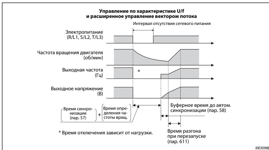
**Рис. 5-207:** Автоматический перезапуск при различных рабочих режимах
