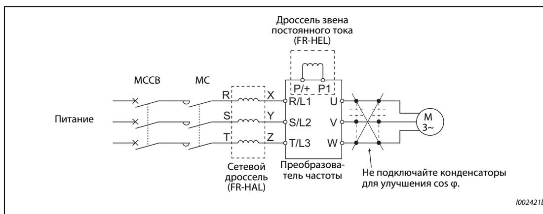
**Рис. 3-9:** Подавление высших гармоник в сетевых проводах
