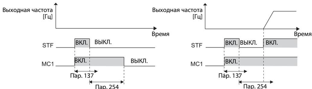
При сбросе преобразователя состояние сигнала МС1 сохраняется и силовой контактор не активируется.
