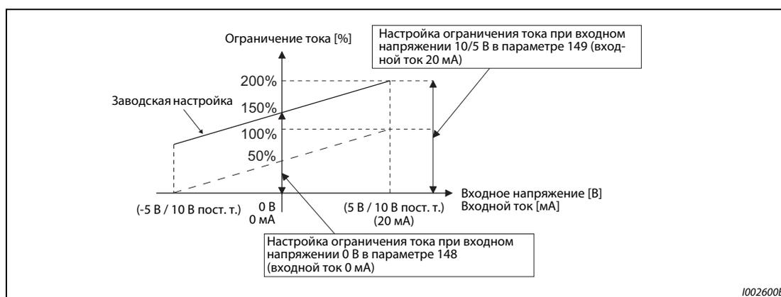
**Рис. 5-69:** Аналоговая настройка ограничения тока через клемму 1
