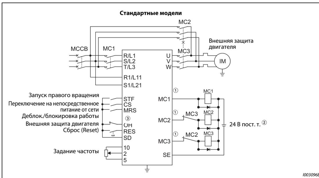
Рис. 5-145: Подключение силовых контакторов (стандартные модели)
