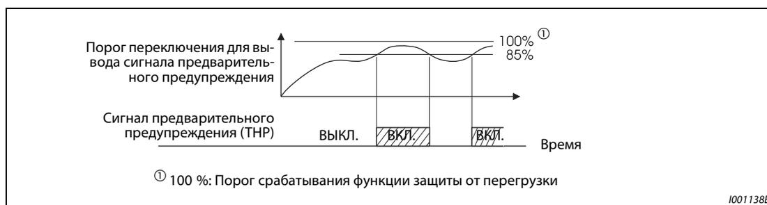
**Рис. 5-49:** Вывод сигнала предварительного предупреждения
