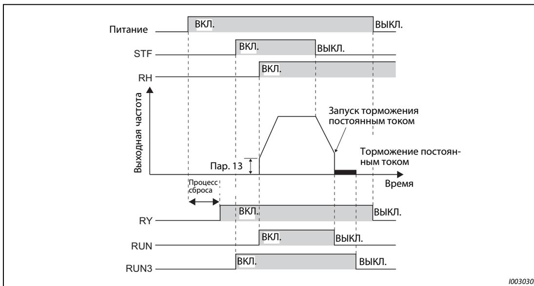
**Рис. 5-95:** Готовность к работе и вращение двигателя
