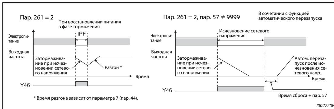
**Рис. 5-215:** Продолжение работы после исчезновения сетевого напряжения
