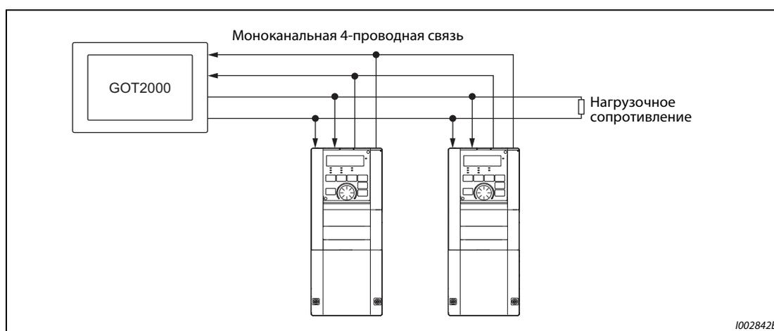
Рис. 5-245: Автоматическая связь с GOT2000
