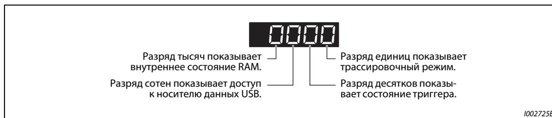
**Рис. 5-220:** Индикация состояния трассировки
