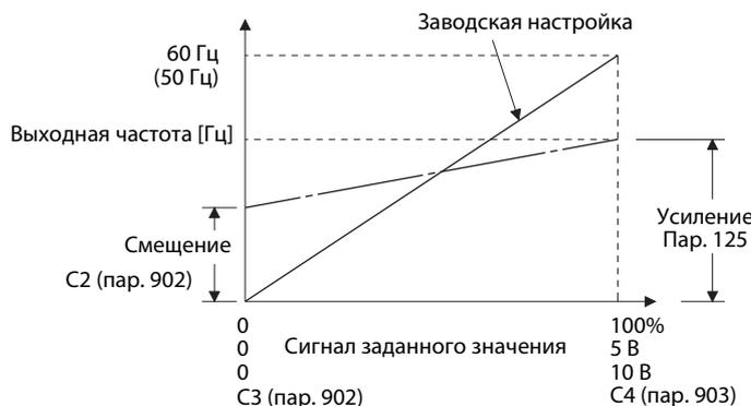
Усиление можно настроить как для наличия напряжения на клеммах 2-5, так и для отсутствия напряжения.
