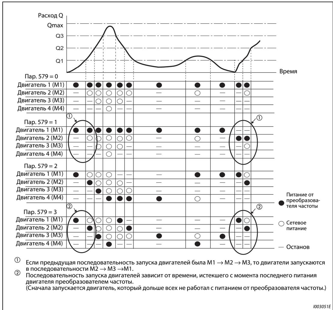
Рис. 5-185: Регулирование расхода жидкости через вспомогательные двигатели
