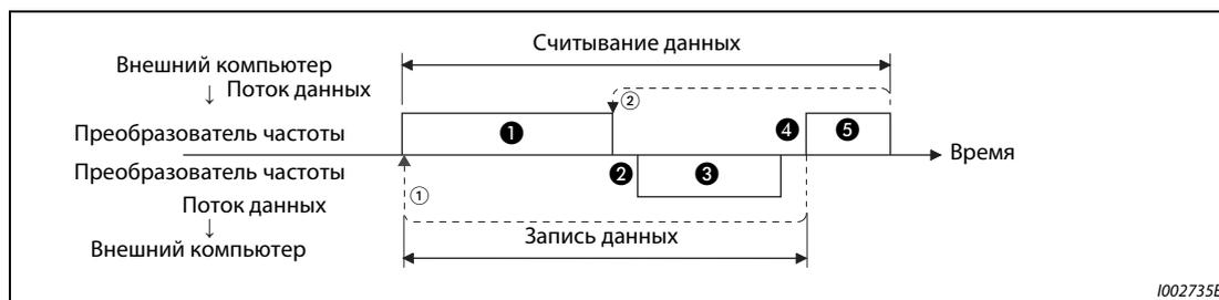
**Рис. 5-231:** Схематическое изображение обмена данными
