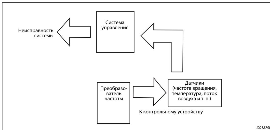
**Рис. 3-15:** Контроль двигателя с помощью внешней системы управления
