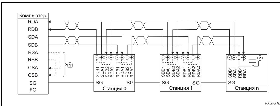
Рис. 5-228: Соединение с несколькими преобразователями частоты
