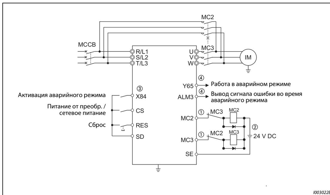
**Рис. 5-58:** Внешнее подключение выводов для аварийного режима
