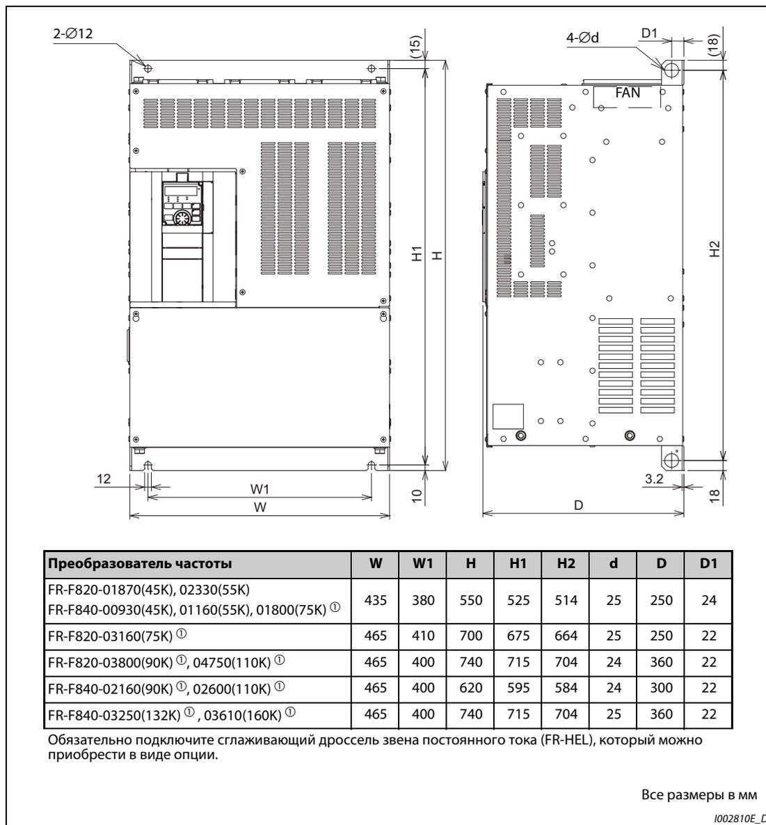
**Рис. 8-9:** Габаритно-присоединительные размеры преобразователей частоты FR-F820-01870(45K), 02330(55K), 03160(75K), 03800(90K), 04750(110K), FR-F840-00930(45K), 01160(55K), 01800(75K), 02160(90K), 02600(110K), 03250(132K), 03610(160K)
