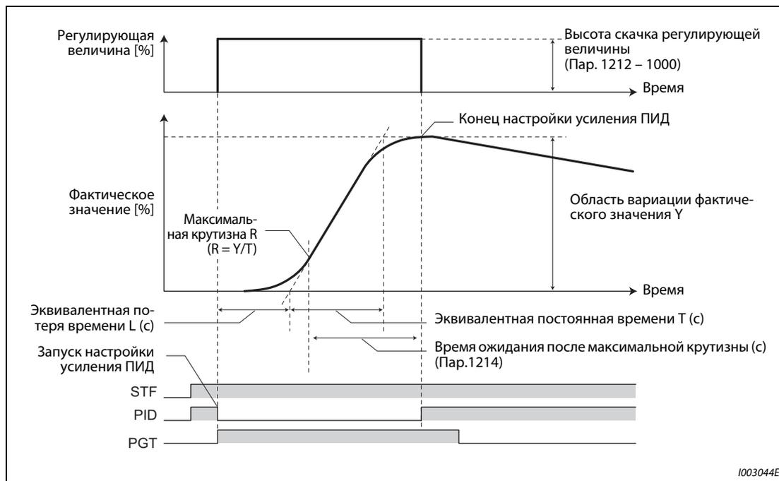
**Рис. 5-175:** *Временная последовательность при методе реакции на скачок*
