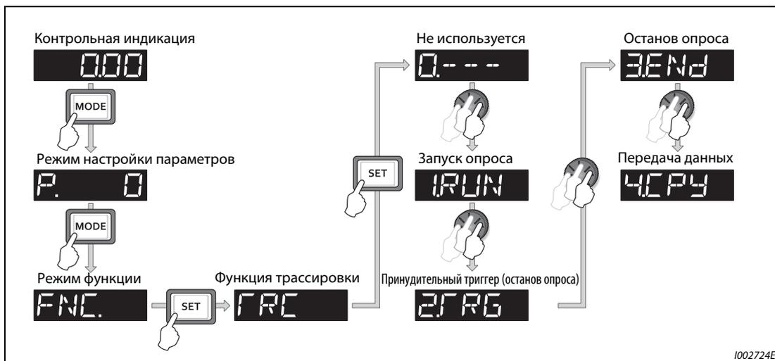
Рис. 5-219: Выбор функции трассировки
