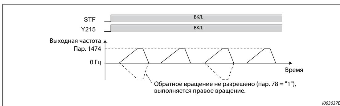
Рис. 5-156: Выходная частота при запрете обратного вращения
