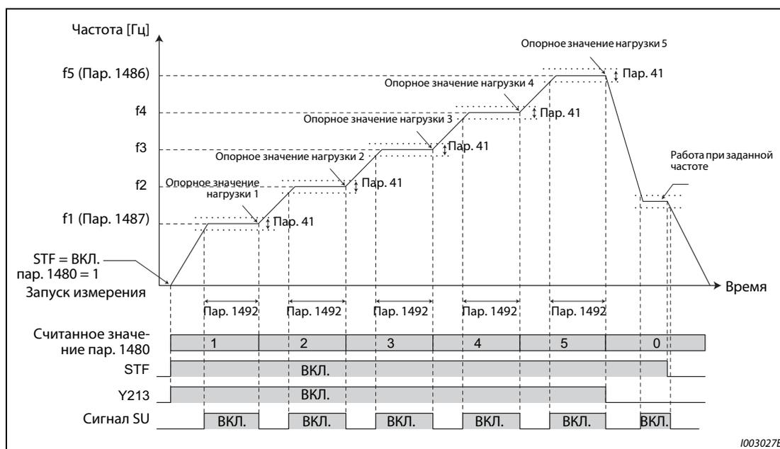
**Рис. 5-72:** Пример для запуска измерения из неподвижного состояния
