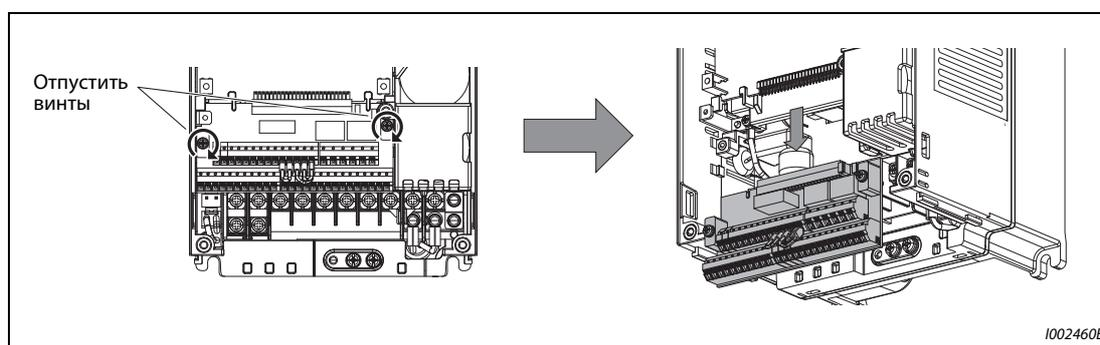
**Рис. 7-9:** Демонтаж клеммного блока
