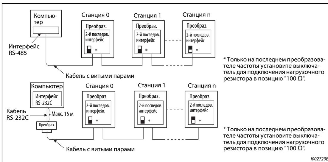
**Рис. 5-226:** Соединение с несколькими преобразователями частоты
