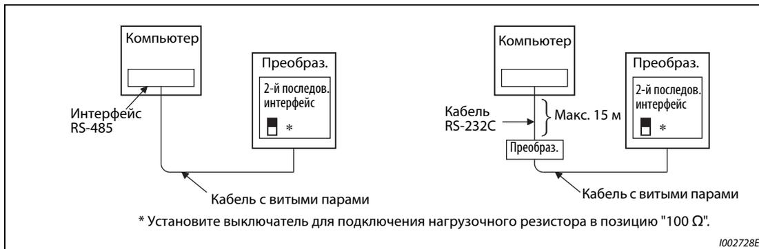
**Рис. 5-225:** Соединение с одним преобразователем частоты
