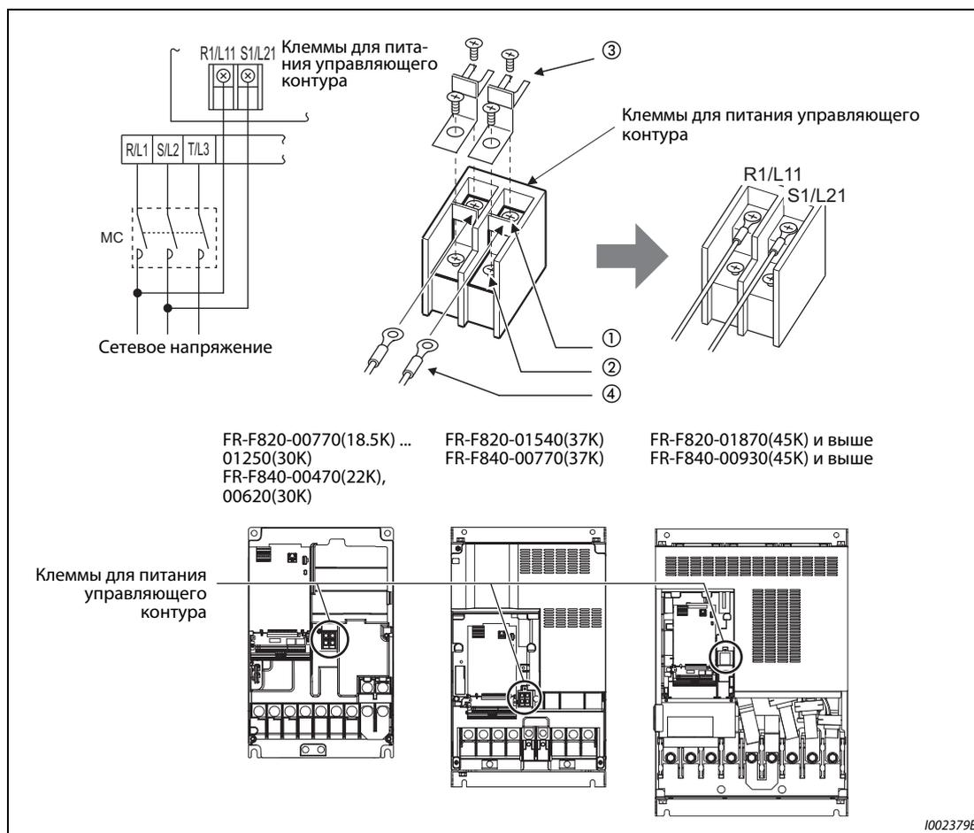
**Рис. 2-40:** Детальный вид клемм**ПРИМЕЧАНИЯ**
