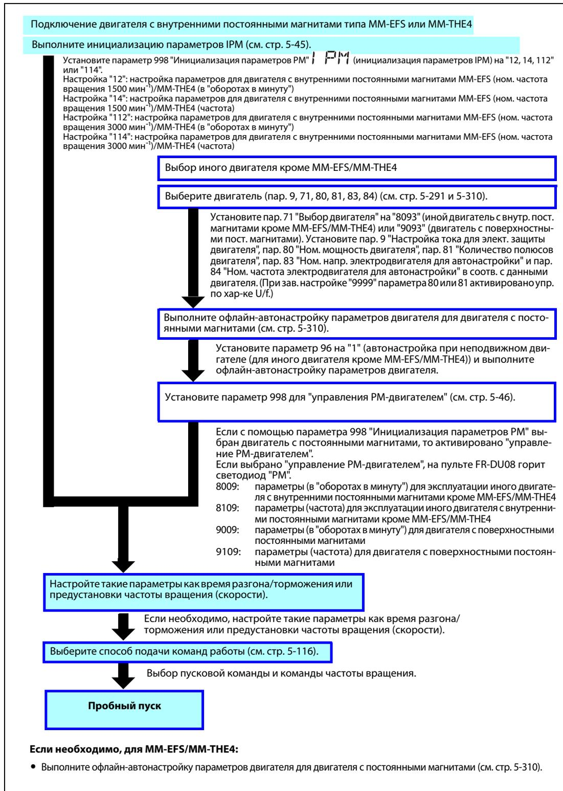
Рис. 5-4: Метод выбора "управления РМ-двигателем" (регулирование частоты вращения)
