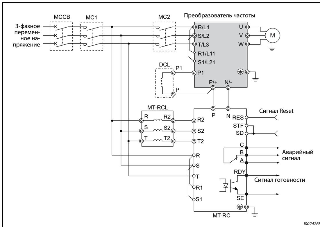
Рис. 2-53: Подключение блока рекуперации (MT-RC)
