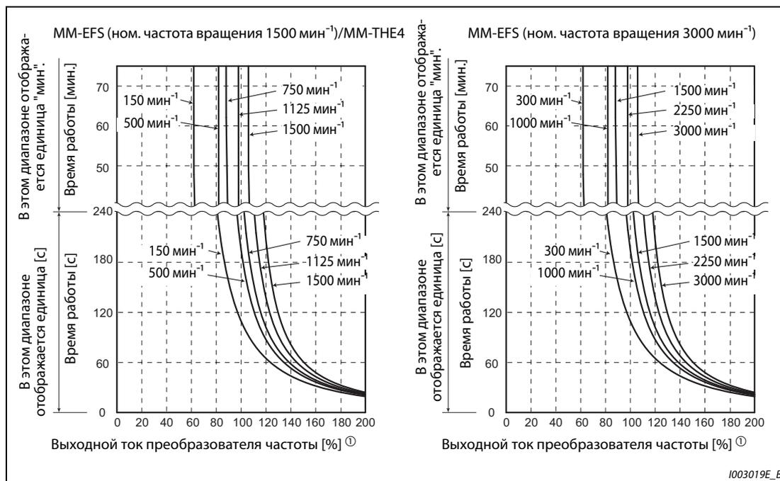
**Рис. 5-46:** Характеристики защиты двигателя (MM-EFS, MM-THE4)
