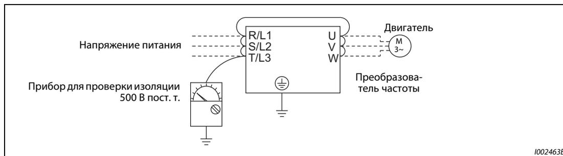
Рис. 7-14: Проверка изоляции относительно земли
