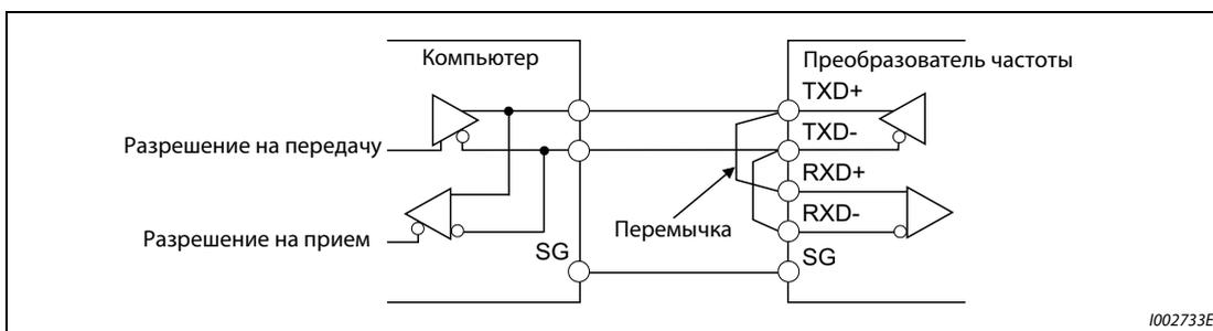
Рис. 5-229: Соединение по 2-проводной схеме
