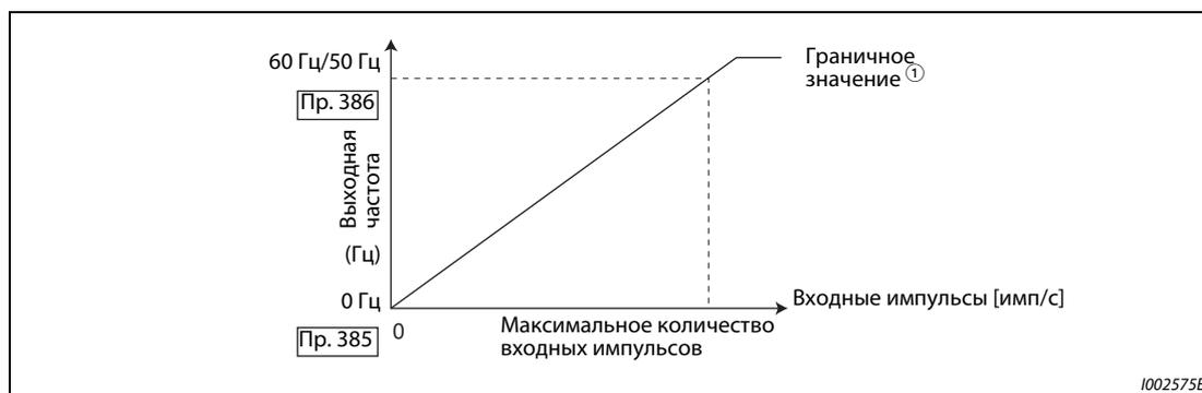
**Рис. 5-39:** Калибровка импульсного входа
