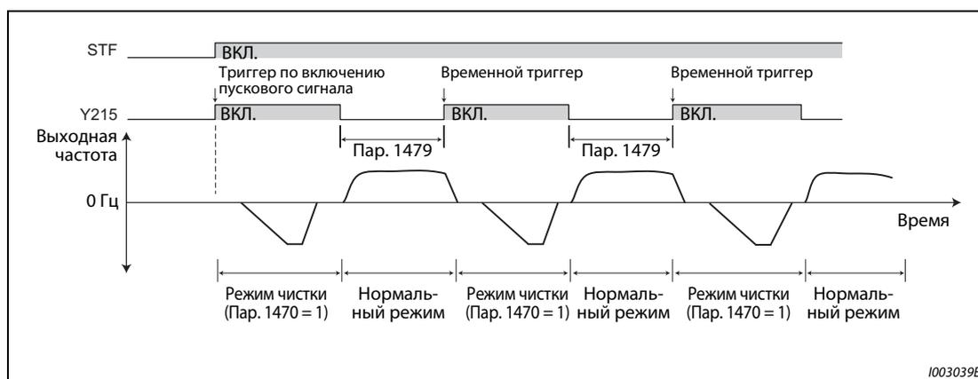
**Рис. 5-158:** Условия запуска таймера для временного триггера
