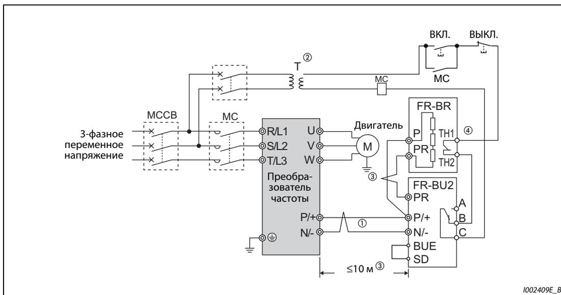
Рис. 2-47: Подключение тормозного блока с тормозным резистором FR-BR(-H)
