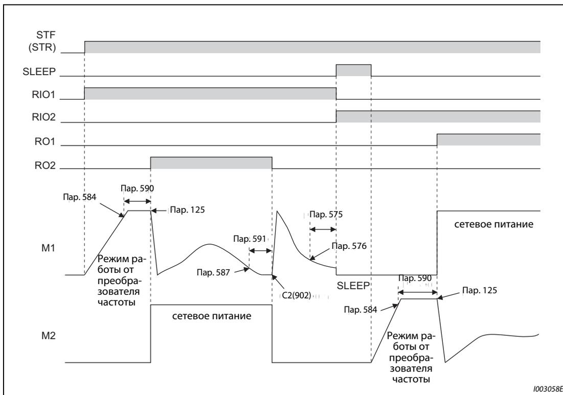
Рис. 5-192: Временная последовательность с двумя двигателями (переменный режим)
