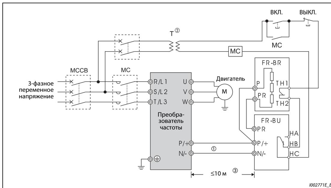
Рис. 2-49: Подключение тормозного блока FR-BU
