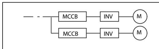
**Рис. 2-5:** Компоновка силовых выключателей
