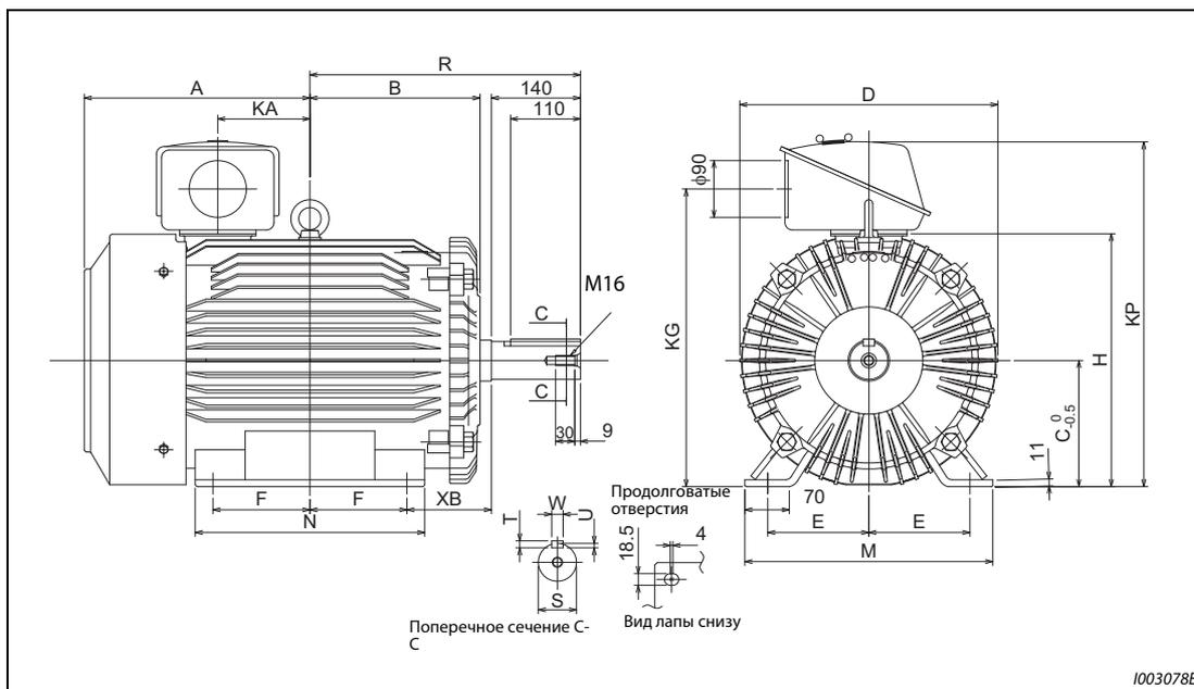
**Рис. 8-14:** Габаритно-присоединительные размеры MM-EFS (ном. частота вращения 1500 мин<sup>-1</sup>), от 37К до 55К
