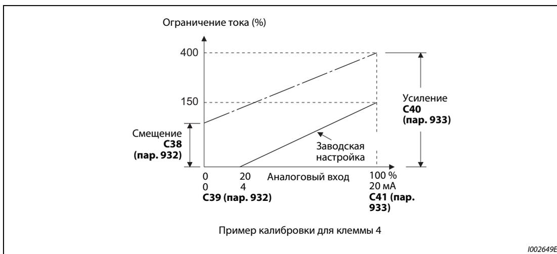
Рис. 5-126: Компенсация сигнала на клемме 4
