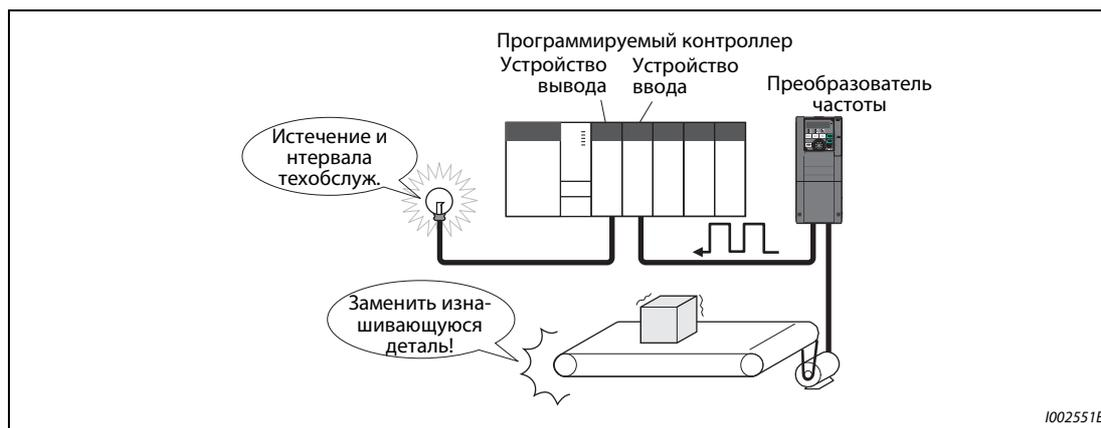
Рис. 5-12: Контроль интервала техобслуживания и среднего значения тока
