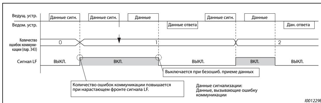
Рис. 5-240: Вывод сигнала LF
