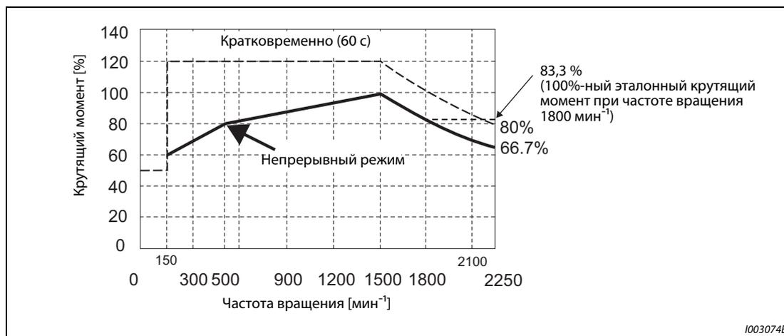
**Рис. 8-1:** Характеристика крутящего момента двигателей [ММ-EFS (ном. частота вращения 1500 мин<sup>-1</sup>)]
