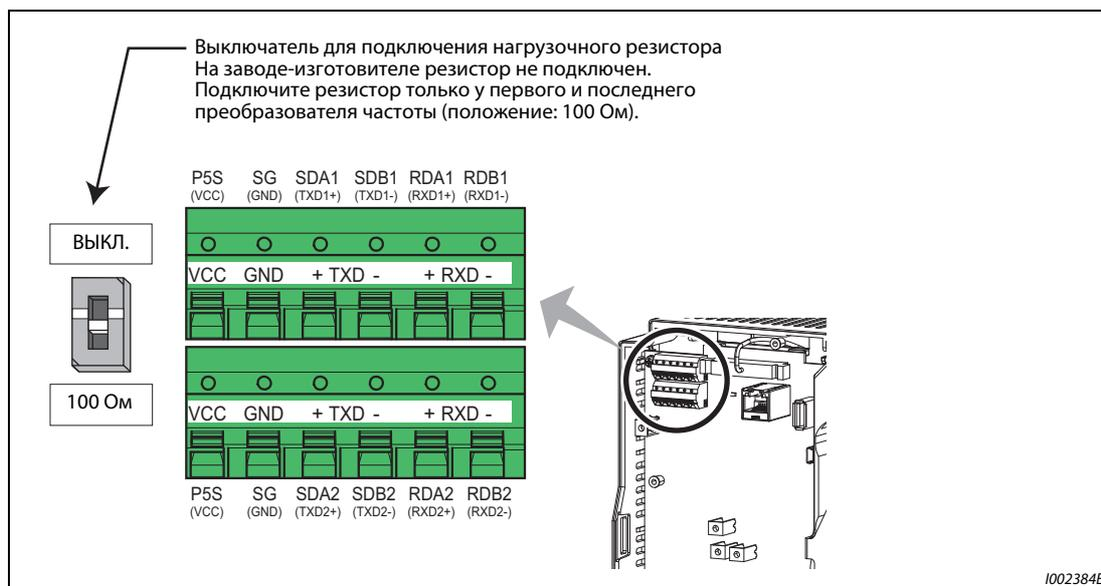
**Рис. 2-45:** 2-й последовательный интерфейс преобразователя частоты
