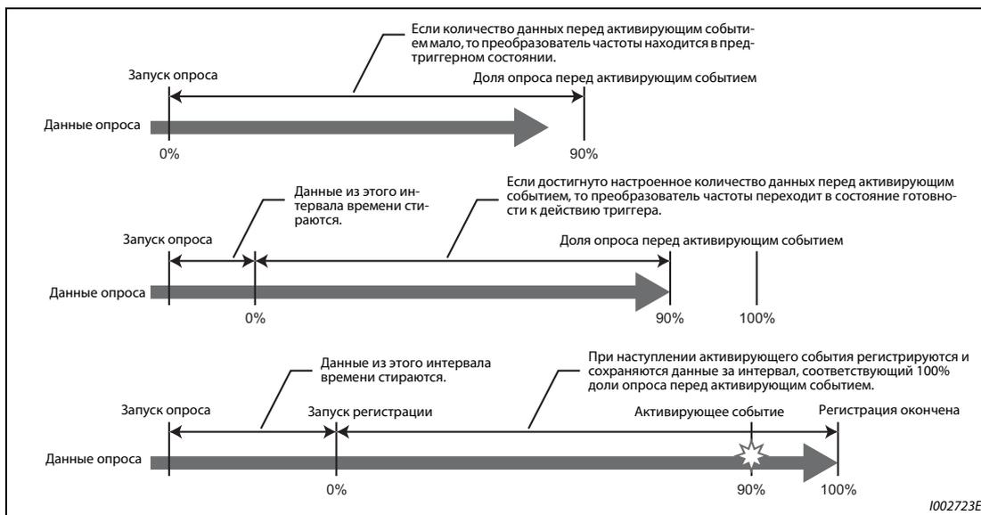
**Рис. 5-218:** Функция трассировки
