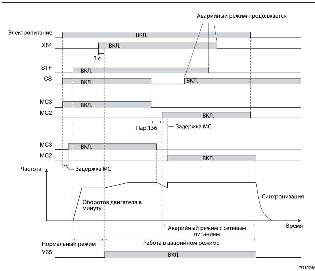
Рис. 5-60: Аварийный режим с переключением на сетевое питание
