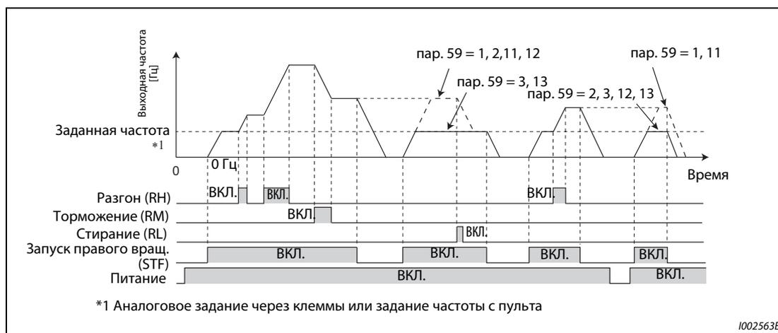
Рис. 5-26: Пример работы цифрового потенциометра
