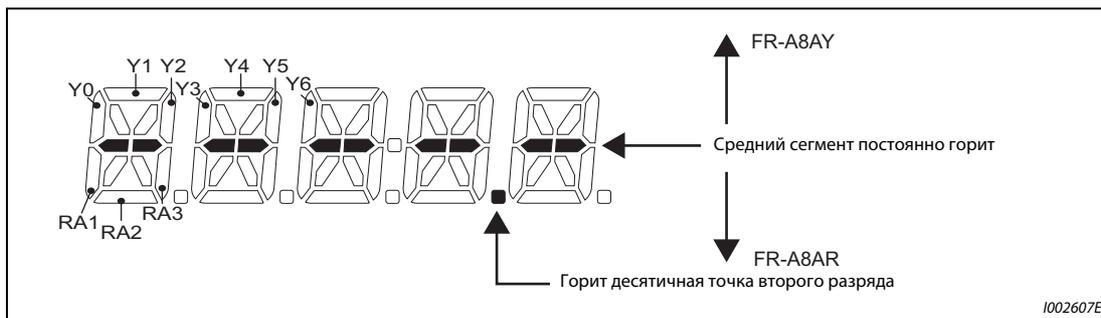
**Рис. 5-80:** *Индикация при установленной опции FR-A8AY или FR-A8AR*
