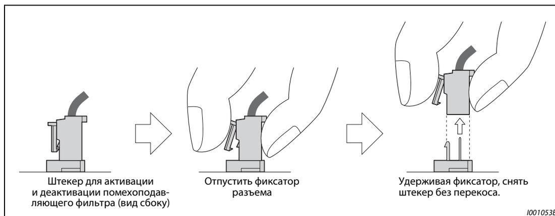
**Рис. 3-8:** Активация внутреннего помехоподавляющего фильтра
