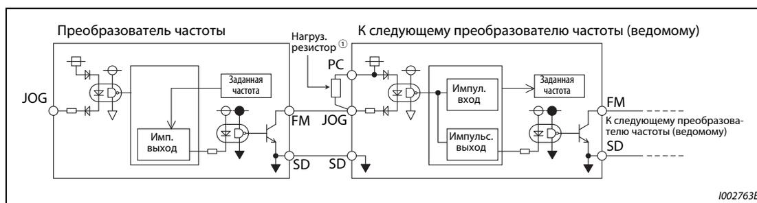
**Рис. 5-40:** Синхронизация частоты вращения
