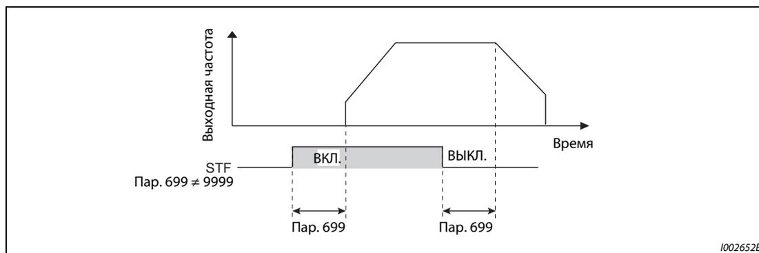
**Рис. 5-133:** Принцип задержки срабатывания входных клемм (пар. 699)
