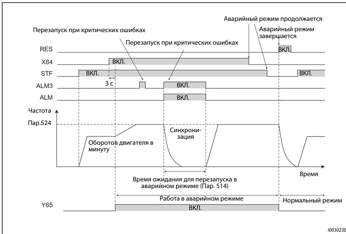
Рис. 5-59: Аварийный режим без переключения на сетевое питание
