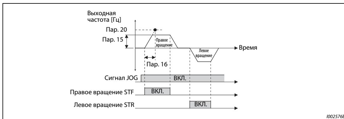
**Рис. 5-41:** Временные диаграммы сигналов в толчковом режиме
