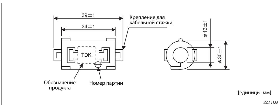
**Рис. 3-5:** Размеры ферритового бочонка ZCAT3035-1330, защелкиваемого вокруг кабеля
