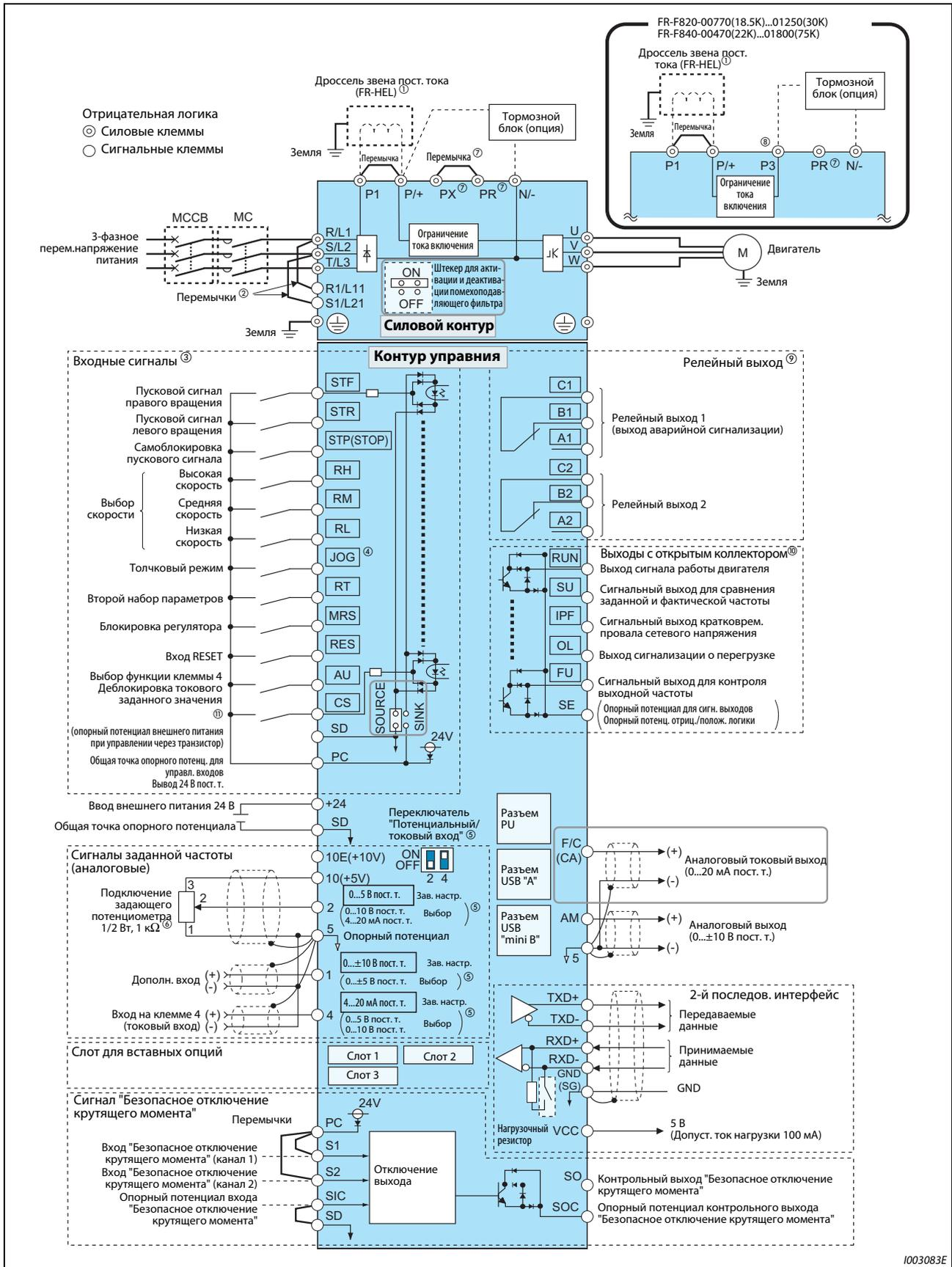
Рис. 2-20: Схема подключения преобразователя частоты (тип CA)
