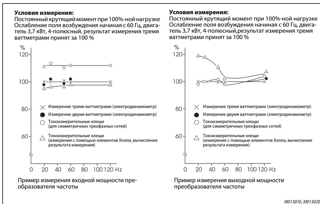
**Рис. 7-12:** Различные методы измерения мощности дают различные результаты
