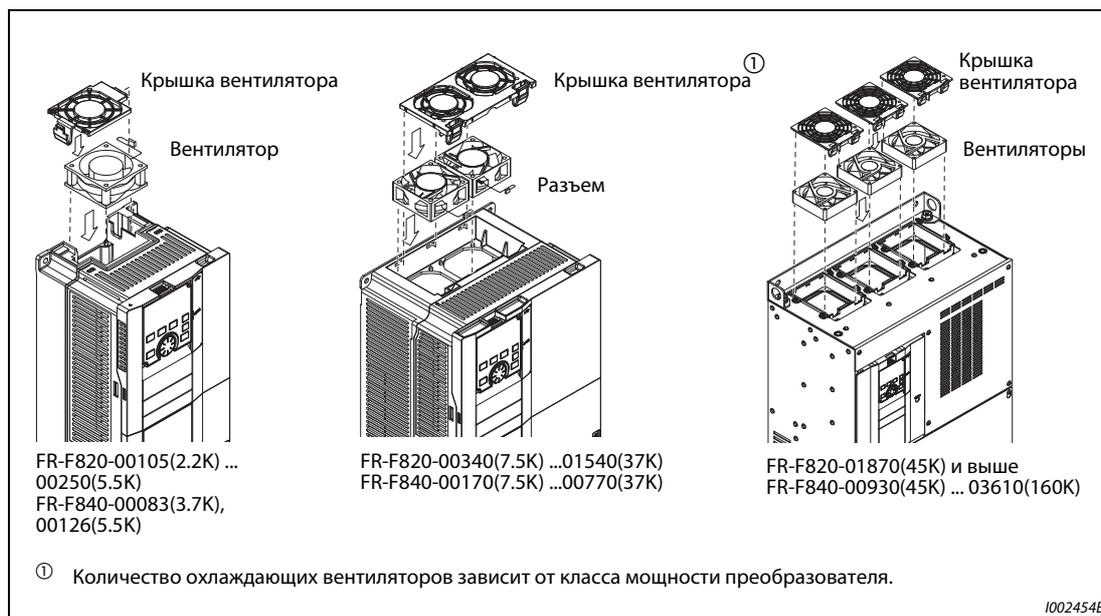
**Рис. 7-3:** Демонтаж охлаждающего вентилятора (вентиляторов)
