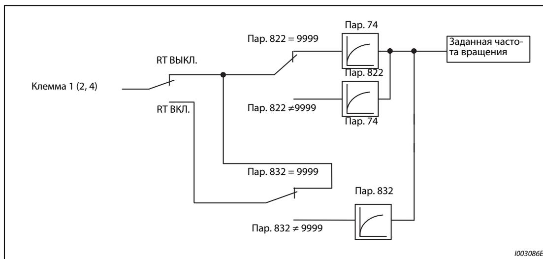
Рис. 5-122: Блок-схема входной клеммы 1 (2, 4)
