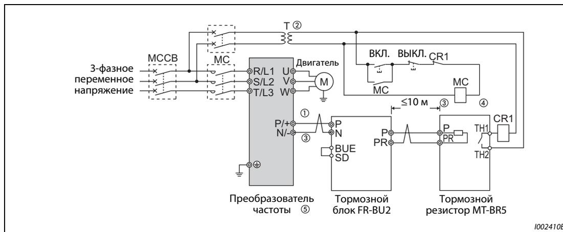
**Рис. 2-48:** Подключение тормозного блока с тормозным резистором MT-BR5
