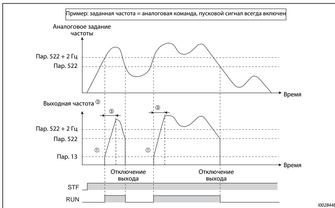
**Рис. 5-254:** Пример отключения выхода
