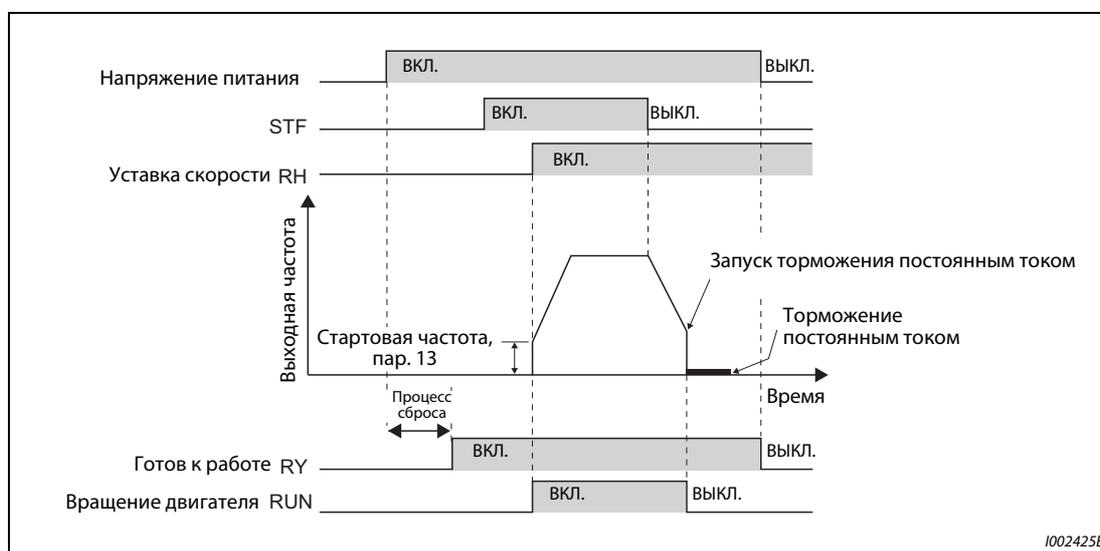
Рис. 3-14: Готовность к работе и вращение двигателя
