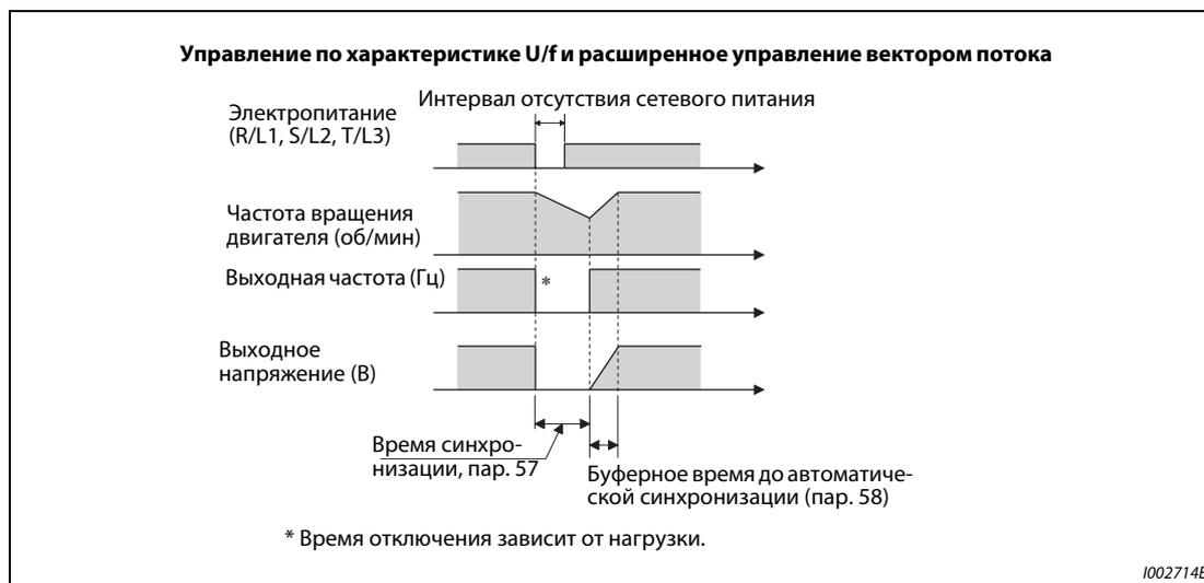
**Рис. 5-208:** Автоматический перезапуск без определения выходной частоты (пар. 162 = 1/11)
