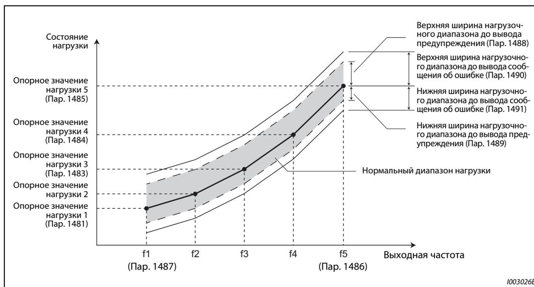
**Рис. 5-71:** Настройка нагрузочной характеристики и диапазона выходной частоты
