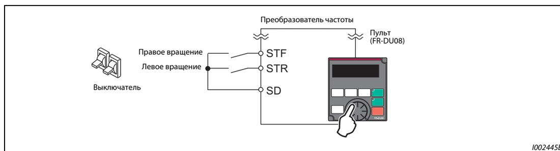
**Рис. 5-35:** Режим комбинированного управления 1
