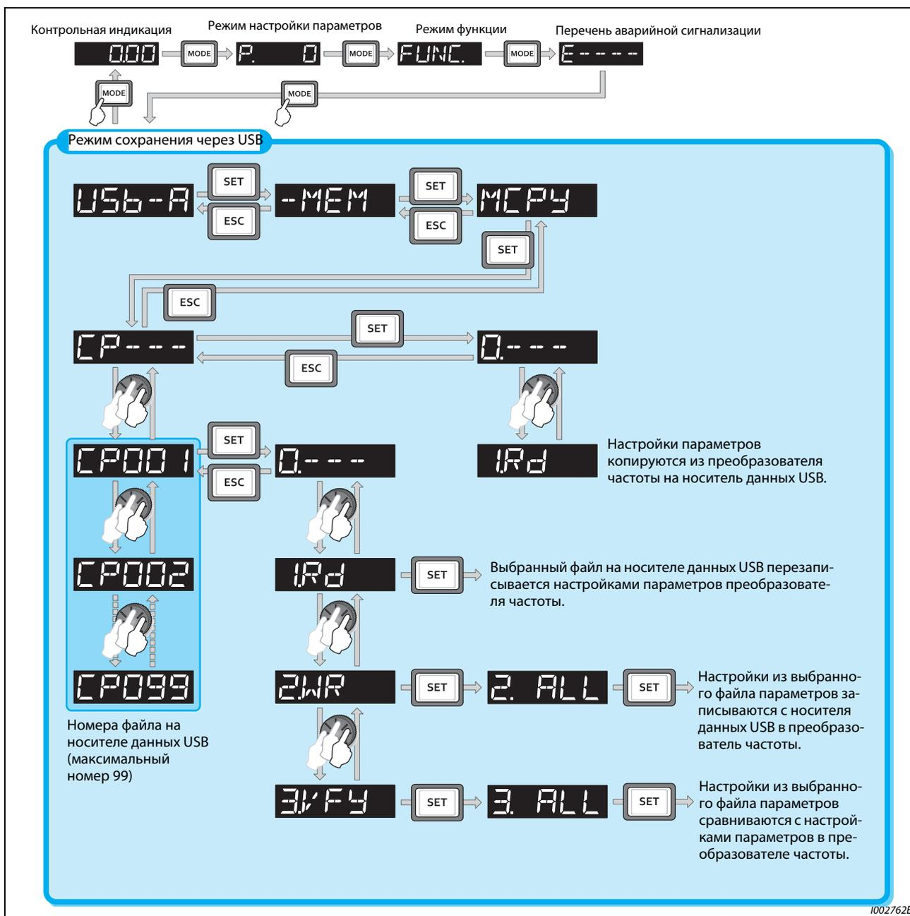
Рис. 5-267: Функции в режиме сохранения через USB
