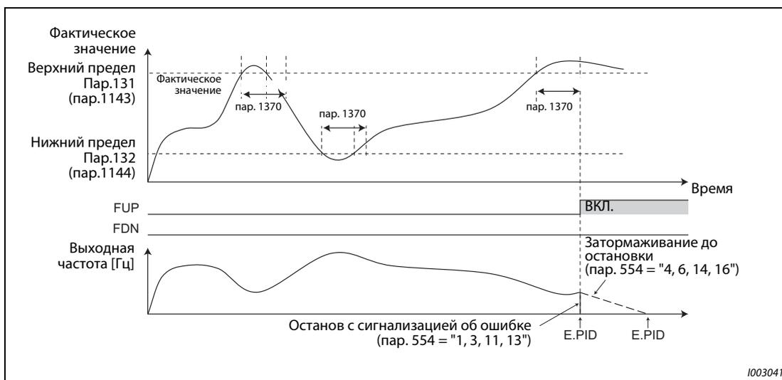
Рис. 5-169: Пример диаграммы активации защитной функции
