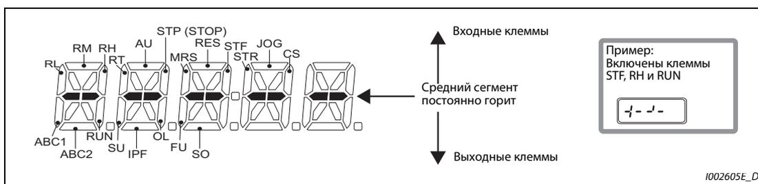
**Рис. 5-78:** *Индикация состояний клемм ввода-вывода*
