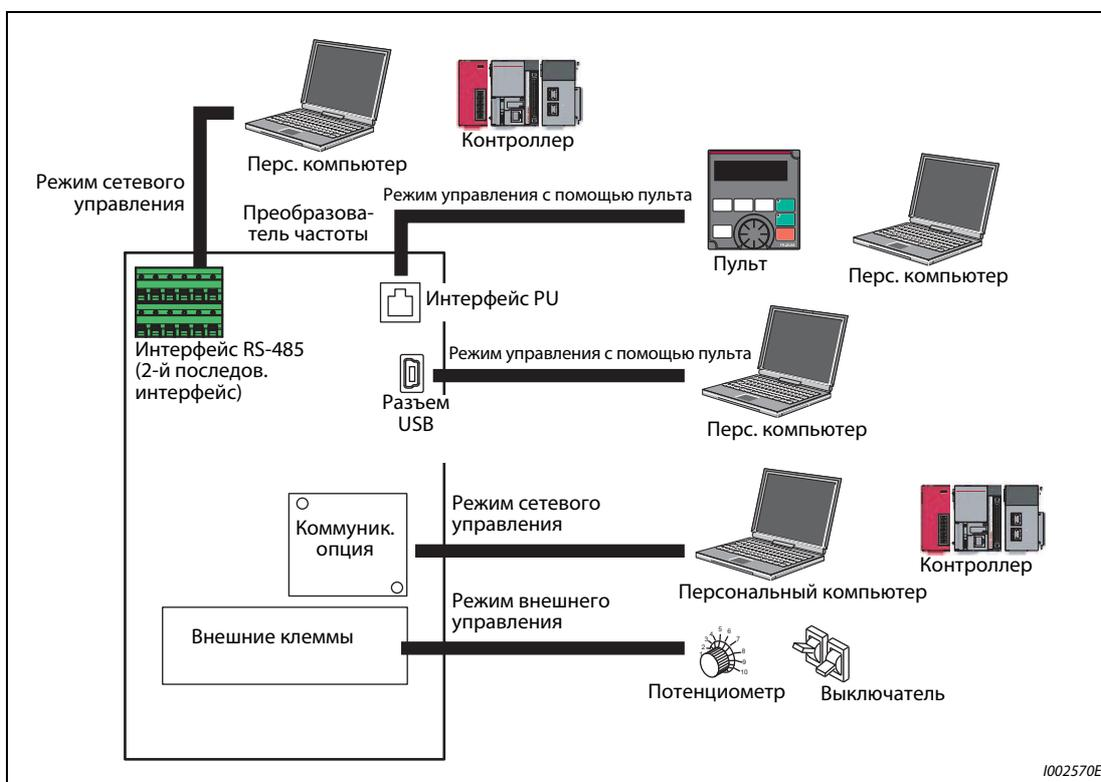
**Рис. 5-31:** Рабочие режимы преобразователя частоты
