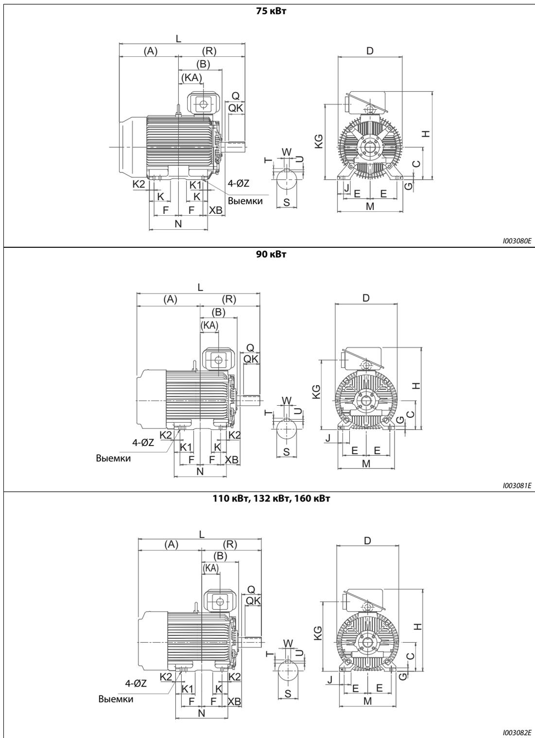
**Рис. 8-16:** Габаритно-присоединительные размеры MM-THE4
