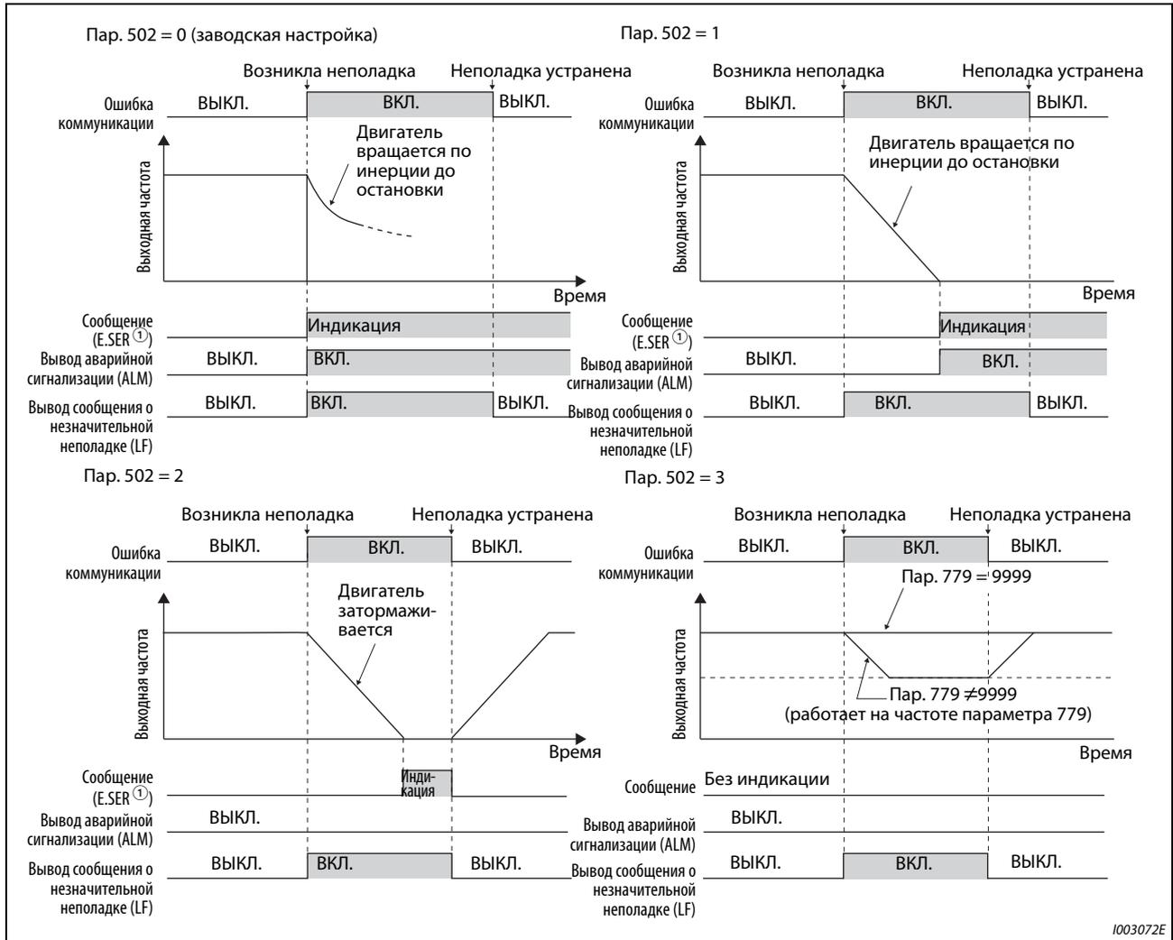
Рис. 5-230: Характер работы при ошибке коммуникации
