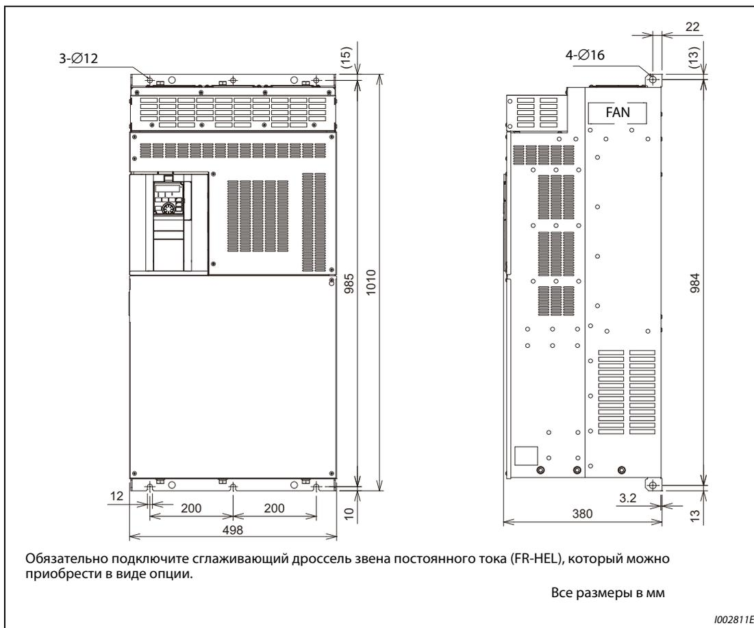
**Рис. 8-10:** Габаритно-присоединительные размеры преобразователей частоты FR-F840-04320(185K), 04810(220K)
