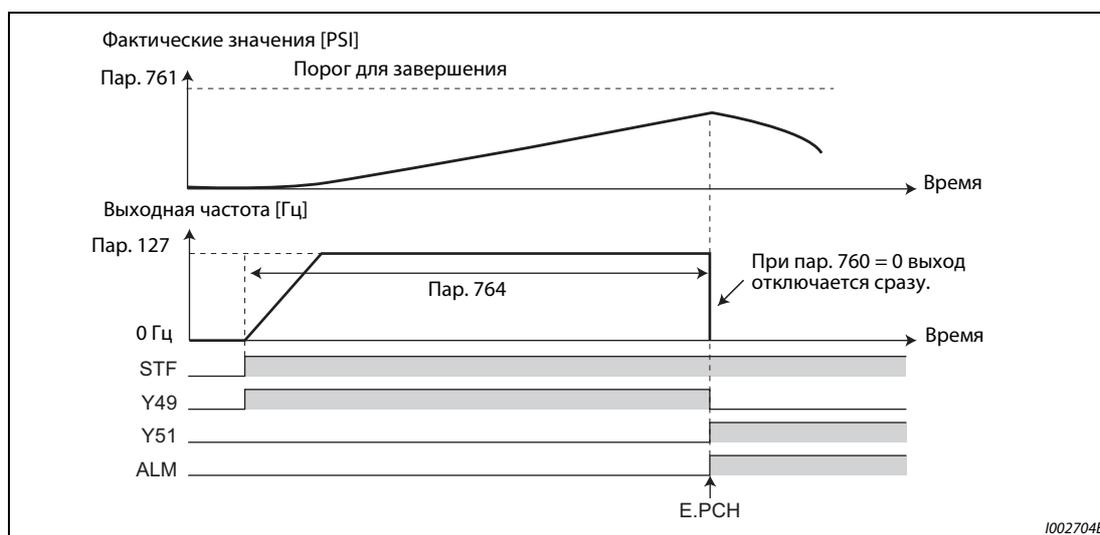
**Рис. 5-183:** Достижение предела времени при режиме предварительного заполнения
