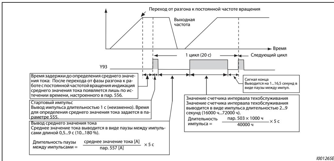
**Рис. 5-13:** Вывод импульсного сигнала Y93
