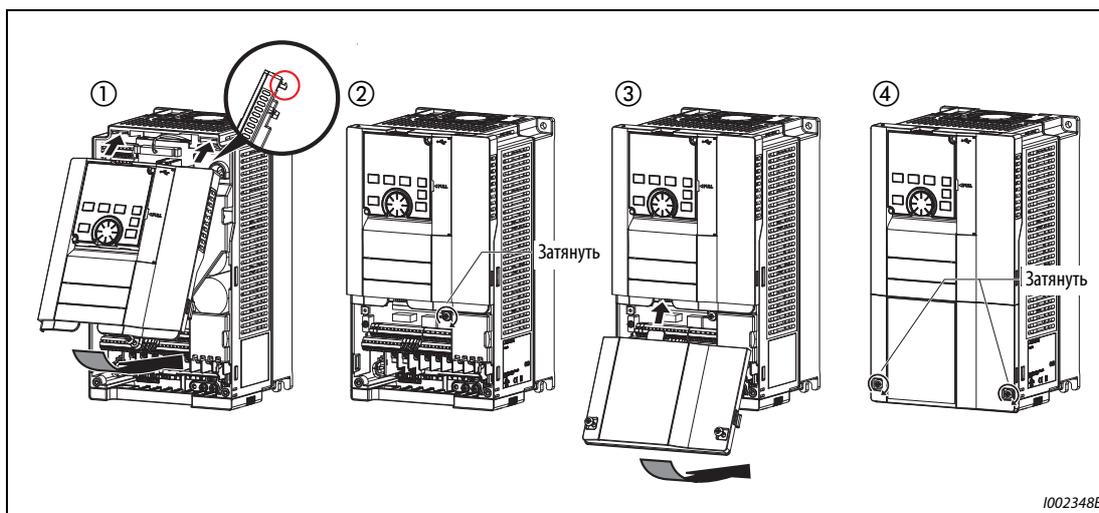
Рис. 2-9: Установка передних панелей
