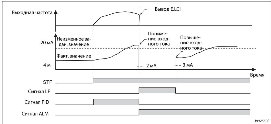
**Рис. 5-130:** Сообщение о неполадке (пар. 573 = 2)**Сообщение о неполадке после затормаживания до неподвижного состояния (пар. 573 = 3)**
