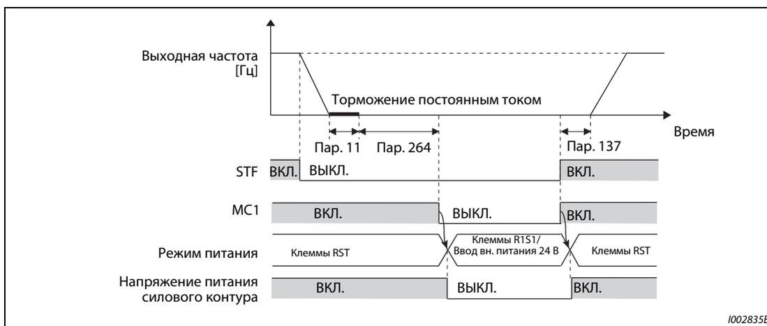
Рис. 5-153: Временная диаграмма функции автоматического уменьшения потребляемой мощности
