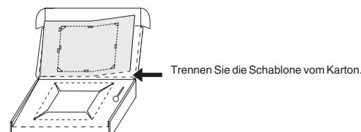
Befestigen Sie die Schablone dort, wo das Bediengerät eingebaut werden soll, und zeichnen Sie an den Außenkanten der Löcher entlang den Schaltaufschlitz an. Entfernen Sie die Schablone, verbinden Sie die Markierungen und fertigen Sie den Ausschnitt an.
