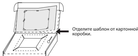
Закрепите шаблон на месте монтажа панели и наметьте контуры проема по внешним краям отверстий шаблона.
