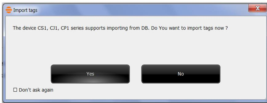
Для создания файла переменных следует в проекте **CX-PROGRAMMER** открыть таблицу символьных переменных и по правой клавише мыши создать файл с символьными переменными, которые возможно импортировать в Polymath.
