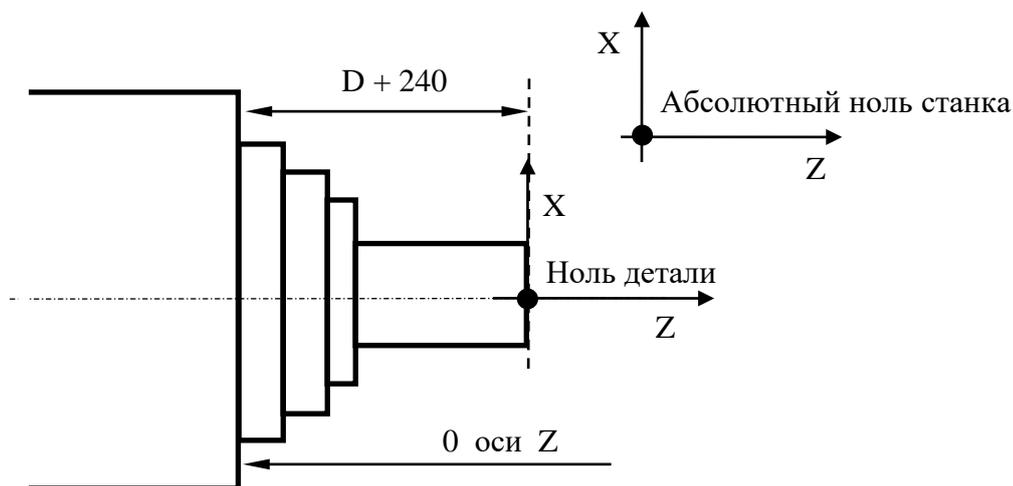
Рисунок 5.7 - Пример определения **Z**-компоненты корректора инструмента
