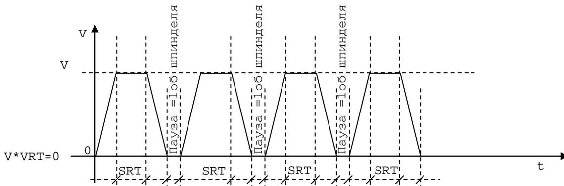
Рисунок 19.2 – Функция дробления стружки при  $VRT = 0$
