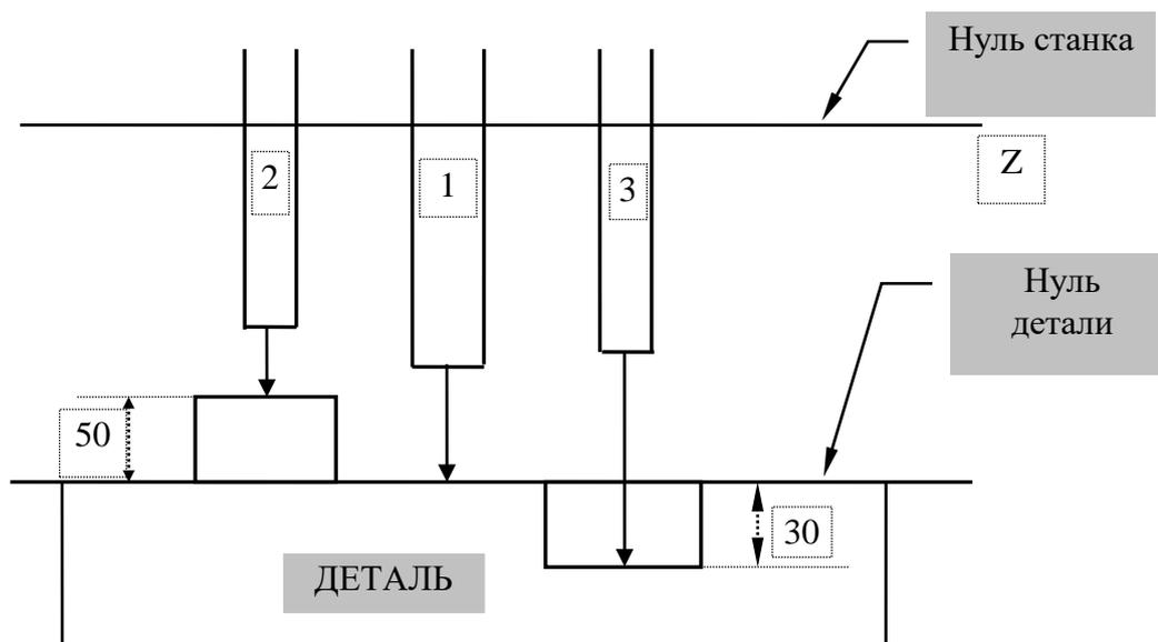
Рисунок 5.3 - Установка на нуле оси **Z** ручным позиционированием инструмента
