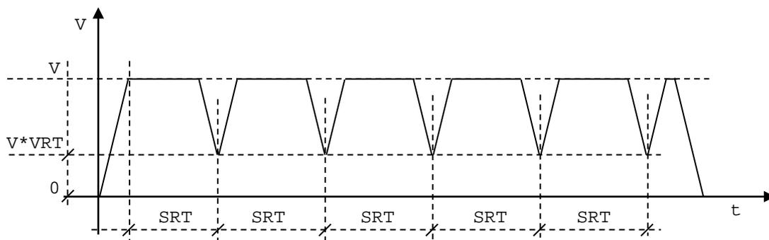
Рисунок 19.1 – Функция дробления стружки при  $VRT > 0$
