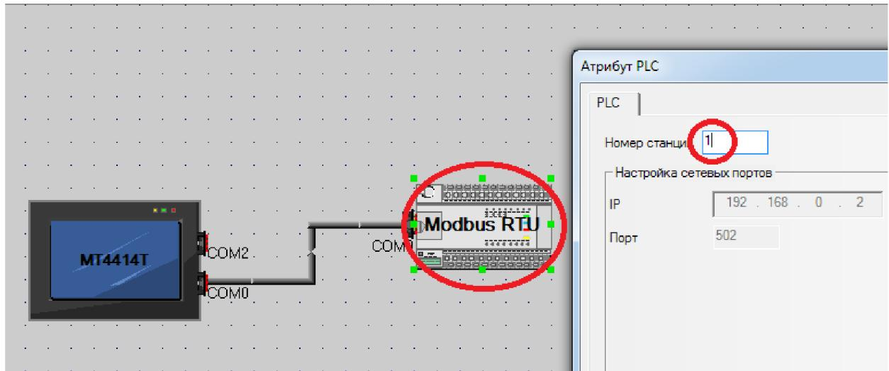
Для того чтобы задать параметры связи панели, нужно двойным щелчком по панели открыть окно настроек и выбрать вкладку «Настройка COM0». В этой вкладке задаются параметры связи по протоколу ModBus RTU.
