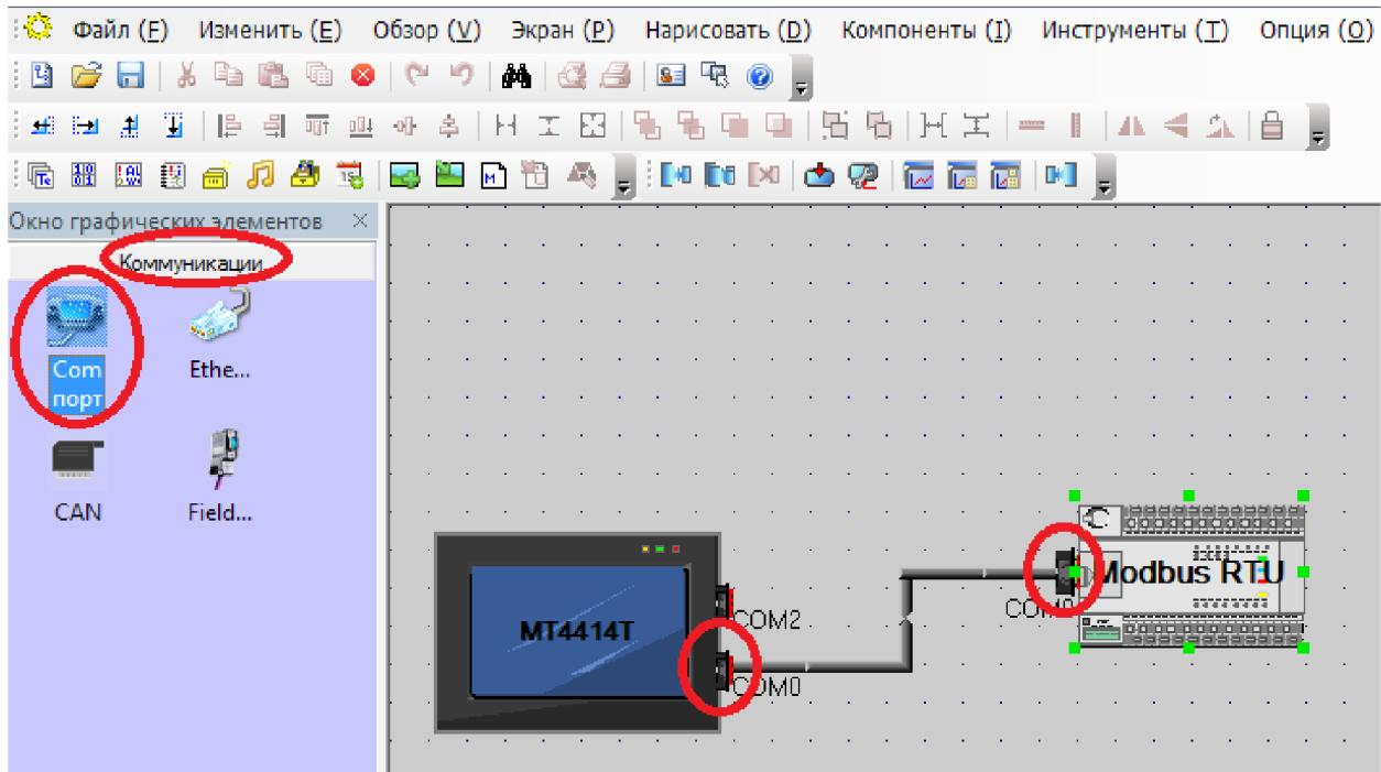
Далее рассматривается соединение по интерфейсу RS-485 2-х проводный, протокол ModBus RTU.
