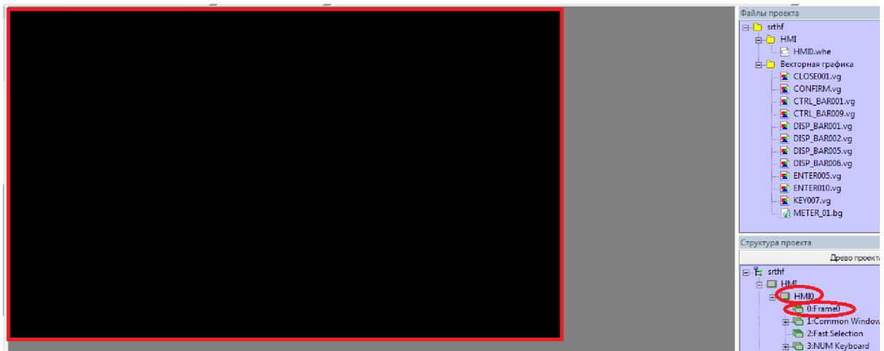
Рассмотрим взаимодействие панели и контроллера на примере элемента ввода числа. В разделе «Графические элементы» выберем элемент «Ввод числа» и перетащим его на рабочее поле, после этого сразу появится окно с настройками данного элемента.
