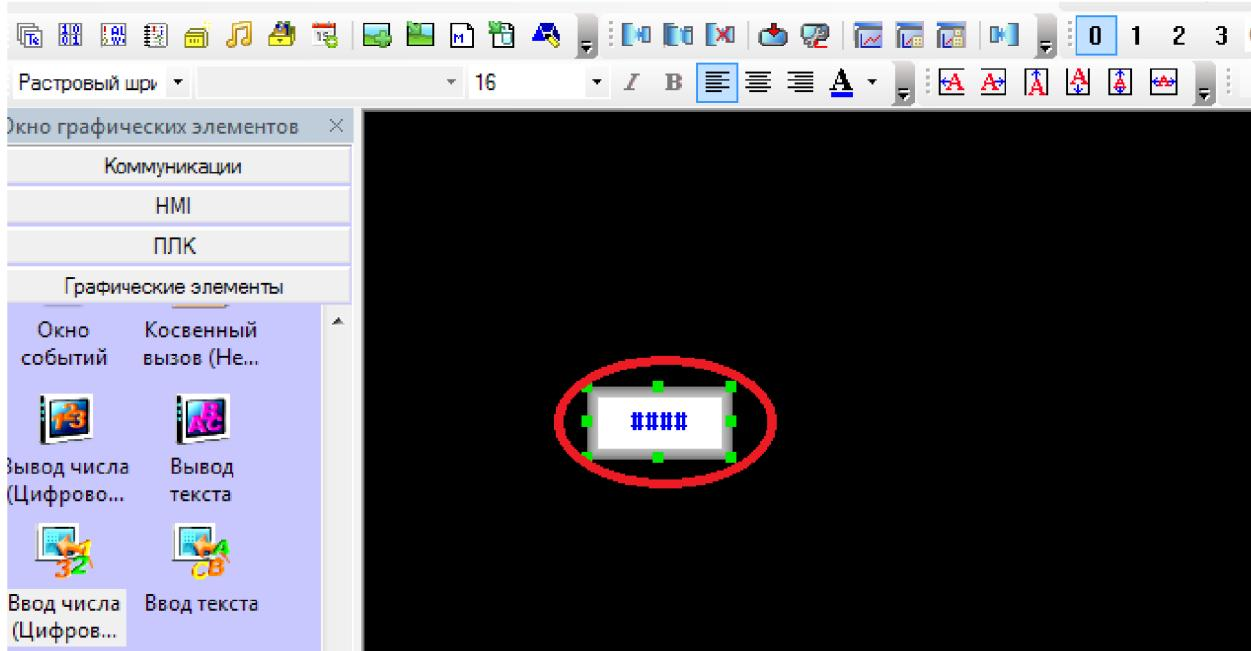
Элемент «Вывода числа» используется только для индикации значения. Для того чтобы введённое значение было отображено в элементе «Вывода числа», необходимо в этом элементе указать такой же адрес как и в элементе «Ввода числа».
