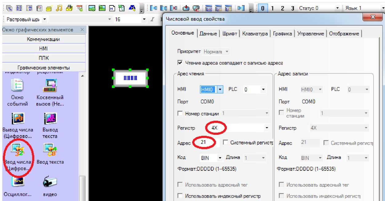
В качестве примера рассмотрим работу с внутренней памятью панели – регистр «**LW**». В поле «Адрес» устанавливаем нужный нам адрес. По этому адресу будет происходить чтение/запись данных в контроллер.
