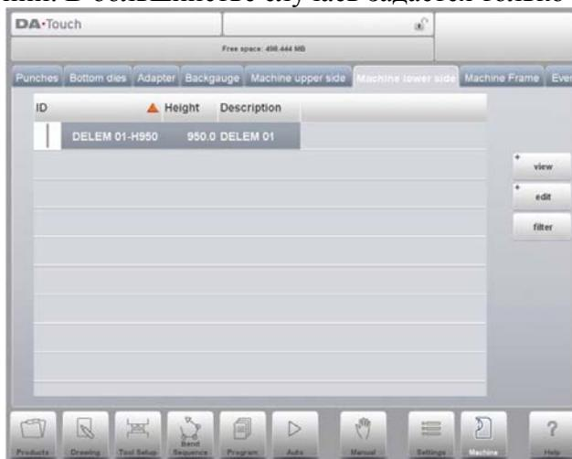
Для нижней стороны станка высота определяется от поверхности стола до уровня пола.
