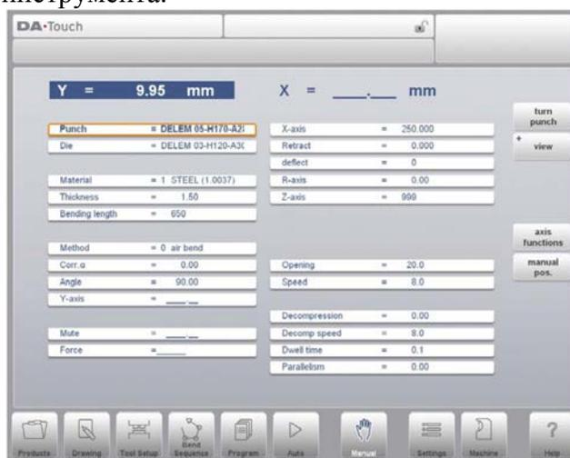
«Turn Punch (Повернуть пробойник)» используется для вращения вокруг применяемого инструмента (наоборот). После этого индикатор появляется за пробойником или пресс-формой.
