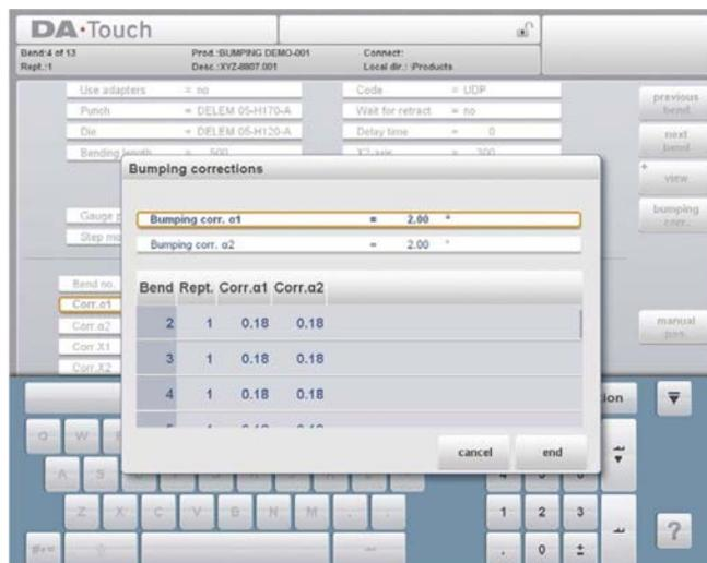
Если общая поправка угла изменена, пересчитываются все индивидуальные поправки. Если любые индивидуальные поправки изменены, пересчитывается общая поправка. Поправки вальцовки могут отдельно задаваться для обеих сторон, 1 и 2. Если изменена общая поправка 1, она автоматически копируется в 2, в результате пересчитываются все отдельные поправки для 2. Для изменения значений поправки 2 используйте поправку 2 или одну из индивидуальных поправок 2.
