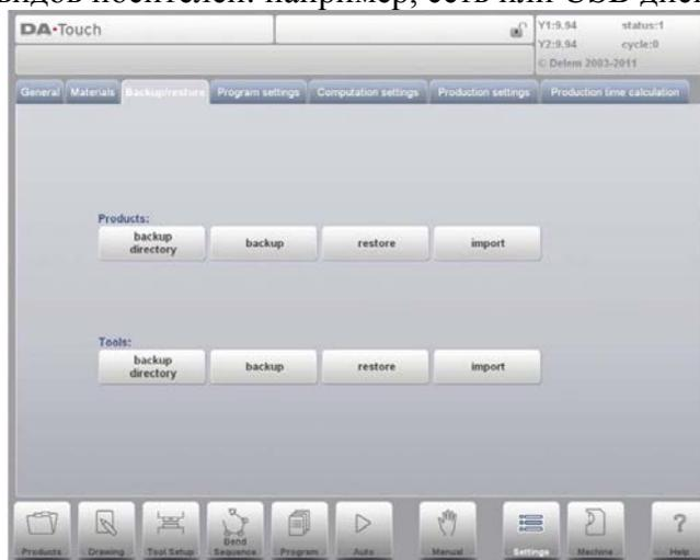
Фактический резервный каталог состоит из устройства (USB диска, сети) и каталога. Выбор устройства зависит от того, какие устройства могут подключаться к системе управления. При необходимости каталоги могут создаваться и выбираться. Резервные ячейки для хранения изделий и инструментов настраиваются отдельно.
