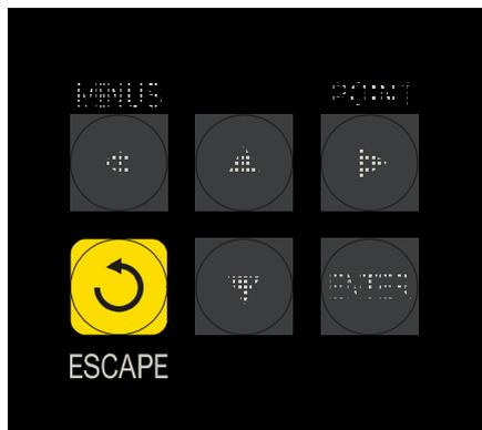
Кнопка «ESCAPE» служит для отмены действия в системном меню контроллера.
