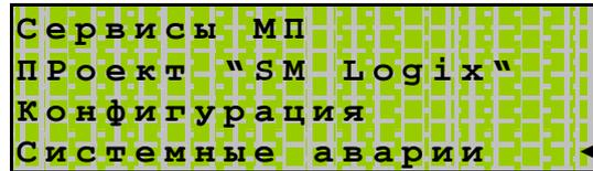
При входе в меню «**Системные аварии**» в случае отсутствия аварий на дисплее отобразится:
