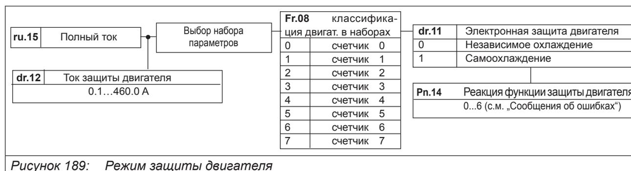
Параметр Pn.14 определяет характеристики привода при активации защитной функции двигателя.
