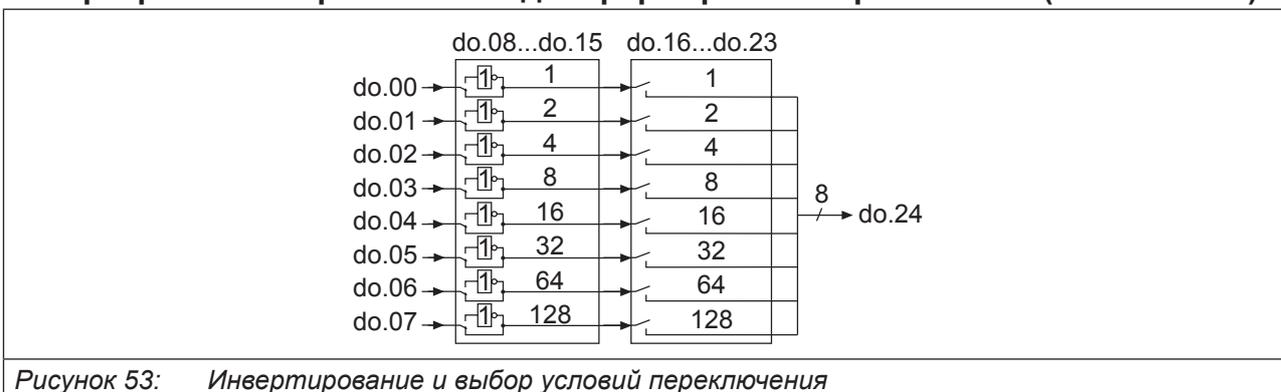
Рисунок 53: Инвертирование и выбор условий переключения
