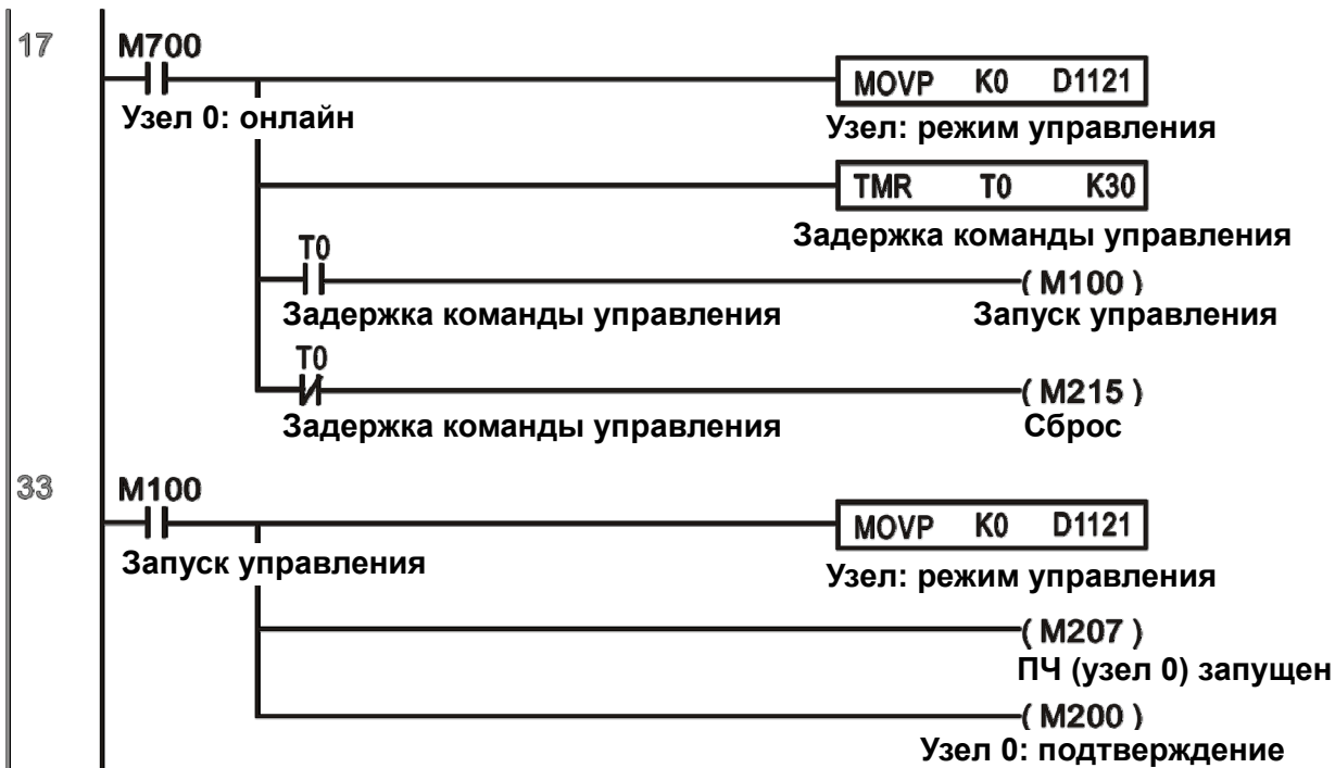
Диаграмма 3: Управляемое устройство Slave 1 осуществляет прямое движение с частотой 30.00 Гц в течение 1 сек. и обратное движение с частотой 60.00 Гц в течение 1 сек. Переключение частоты повторяется.
