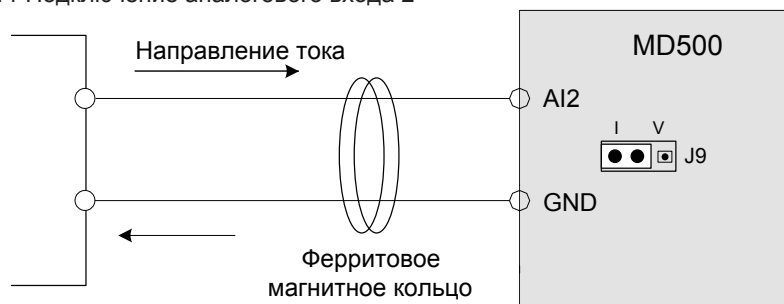
Рисунок 3-11 Подключение аналогового входа 2
