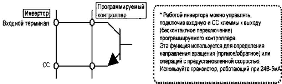
* Соединение инвертора с программируемым контроллером
