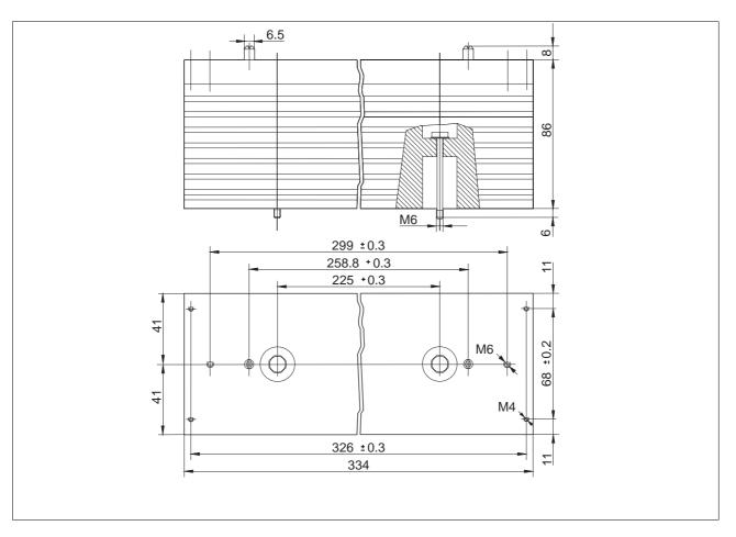
Bild 6-7 Abmessungen Kühlkörper
