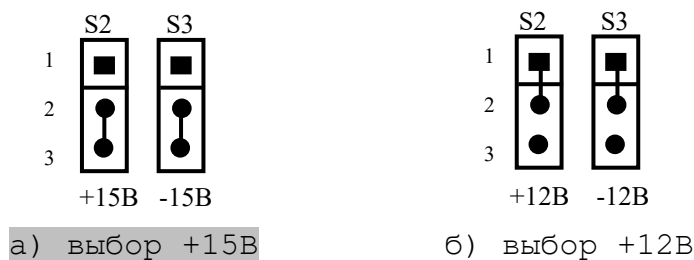
Рисунок 5.7 – Выбор напряжения питания ЦАП
