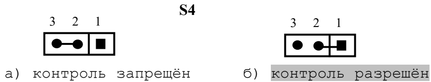
Рисунок 5.4 – Установка аппаратного разрешения контроля обрыва сигналов энкодера
