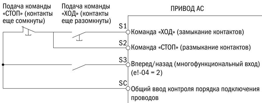
Рис. 6.26. Схема трехпроводного подключения управлением преобразователя
