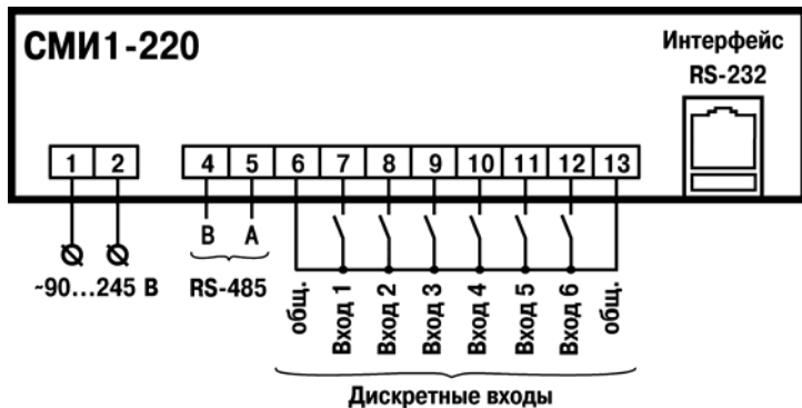
Рисунок Б.1 – Схема подключения питания, дискретных входов, интерфейсов RS-232 и RS-485 панели СМІ1-220
