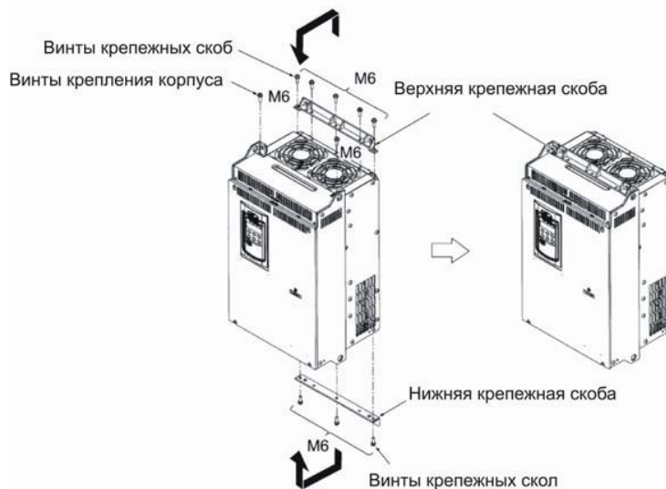
Рис. 2.3 Перестановка крепежных скоб
