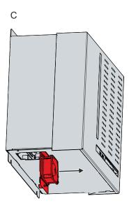
Fig. 32: C6640\_exchange fan bottom
