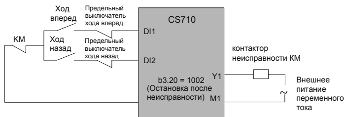
Рис. 5-10. Контур ограничителей безопасности и остановки после неисправности
