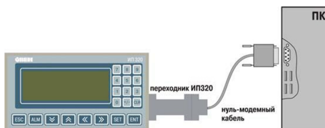
Рисунок 5.1 – Схема подключения интерфейса RS-232 (а) и интерфейса RS-485 (б) для конфигурирования панели ИП320
