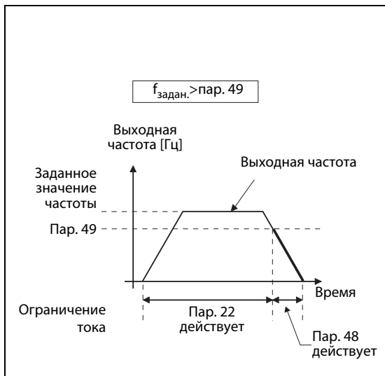
Рис. 6-7: Предельное значение тока, в случае если заданное значение частоты превышает величину, заданную параметром 49.
