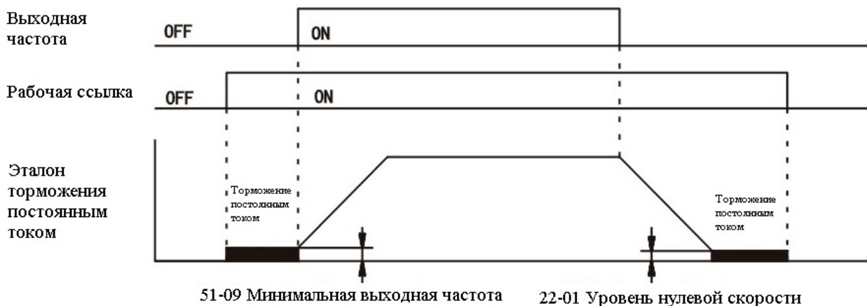
Схема последовательности сигналов эталона торможения постоянным током.
