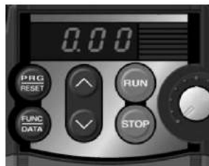
Рисунок 4.2 Изображение на индикаторе после включения электропитания
