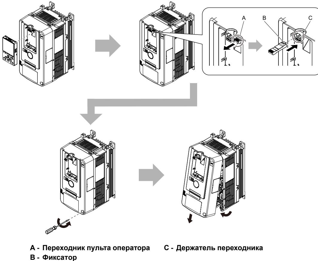
Рисунок 9.5 Снятие передней крышки
