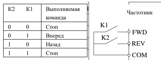
Рис.6-13 Двухпроводной режим управления 1
