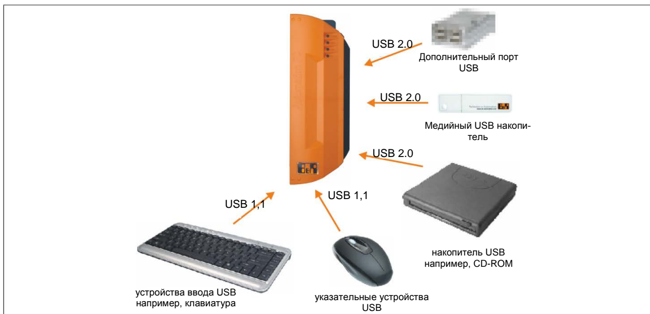
Рис. 35: Локальное подключение периферийных USB устройств на APC510
