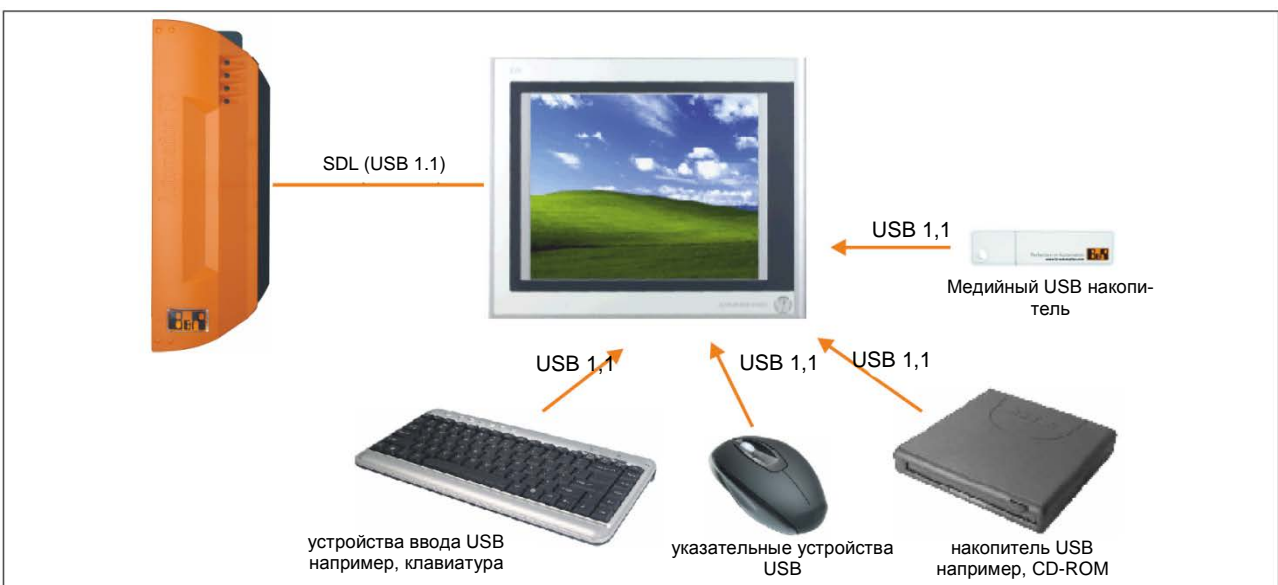
Рис. 37: Дистанционное подключение периферийных USB устройств на APC800/900 с помощью SDL
