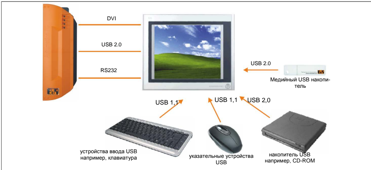
Рис. 36: Дистанционное подключение периферийных USB устройств на APC900 с помощью DVI
