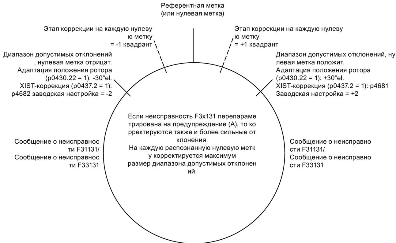
Рисунок 9-14 Окно допуска и исправление
