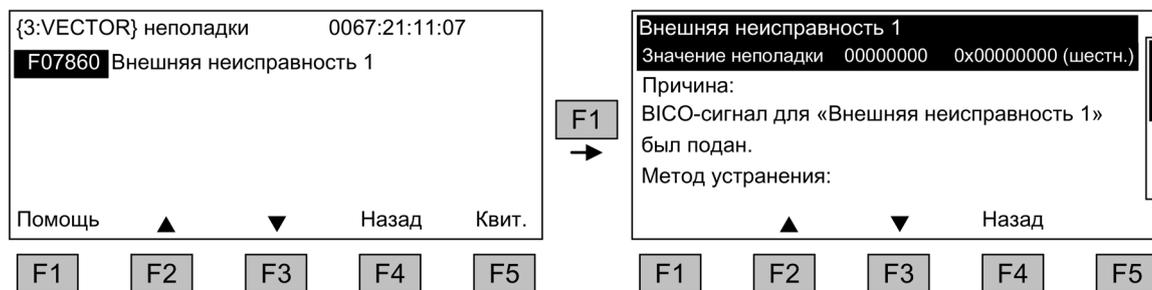
Рисунок 6-28 Окно неисправности
