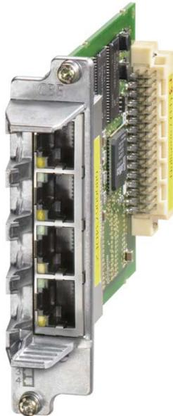
Рисунок 4-30 Плата связи Ethernet CBE20
