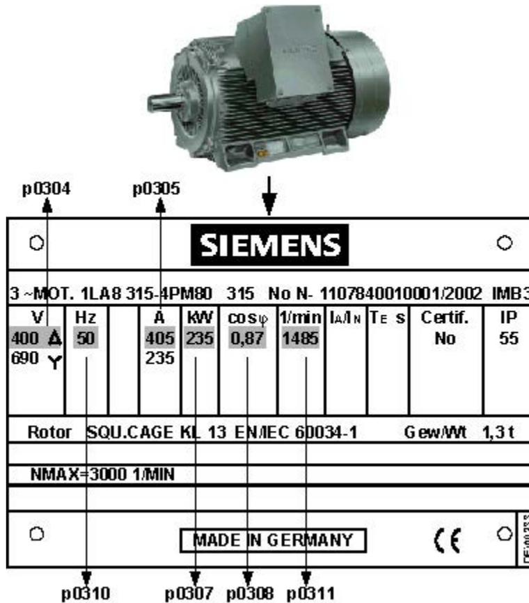
Рисунок 5-44 Пример фирменной таблички двигателя
