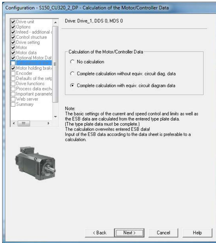
Рисунок 5-24 Расчет данных двигателя/регулятора
