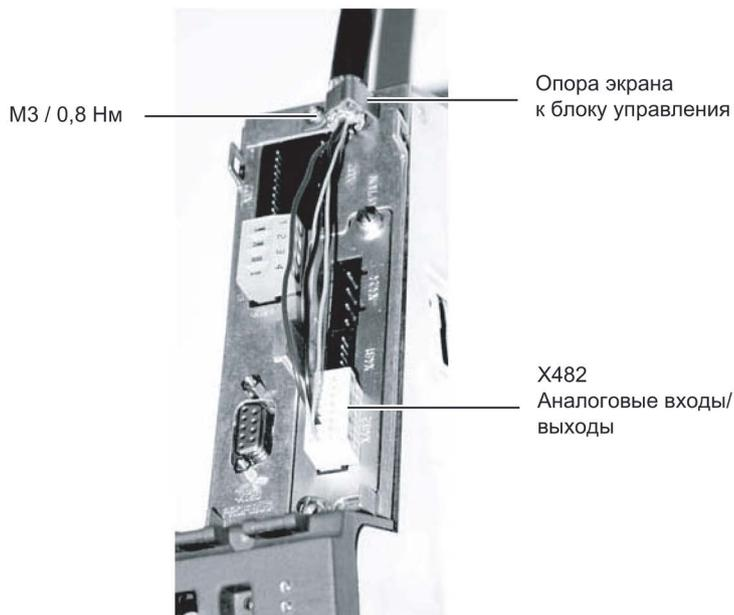
Рисунок 4-50 ТВ30 Подключение экрана
