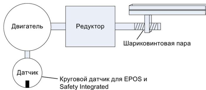
Рисунок 9-49 Пример 3: Круговой датчик для EPOS и Safety Integrated
