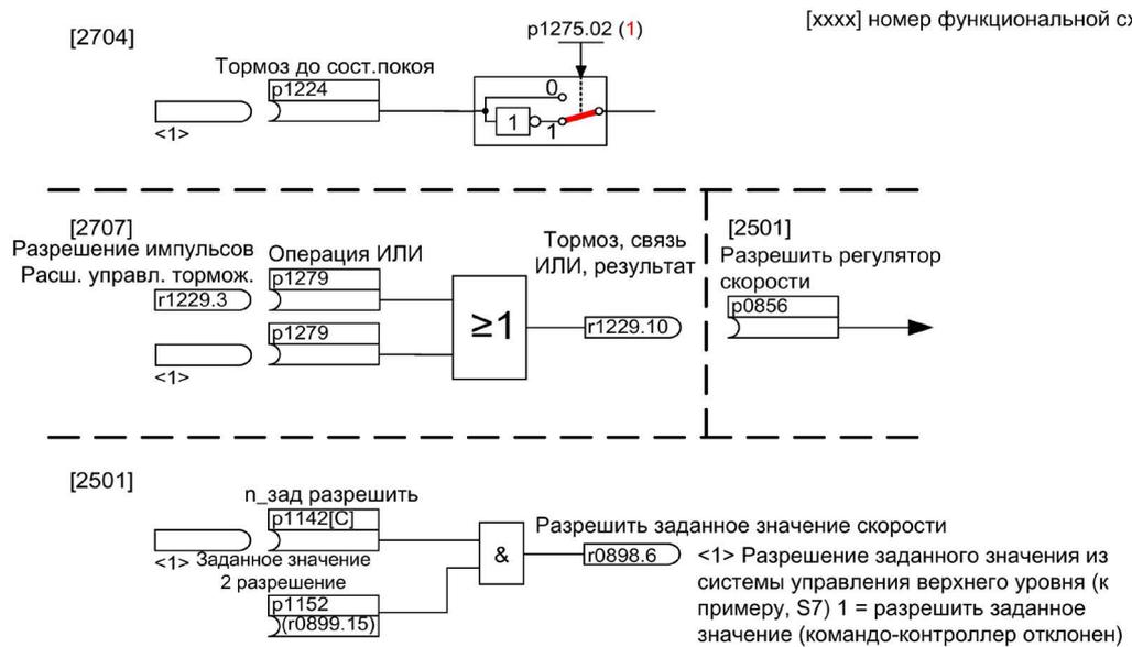
Рисунок 9-25 Пример рабочего тормоза привода крана
