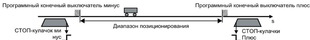
Рисунок 9-41 Программные и аппаратные конечные выключатели в качестве ограничений
