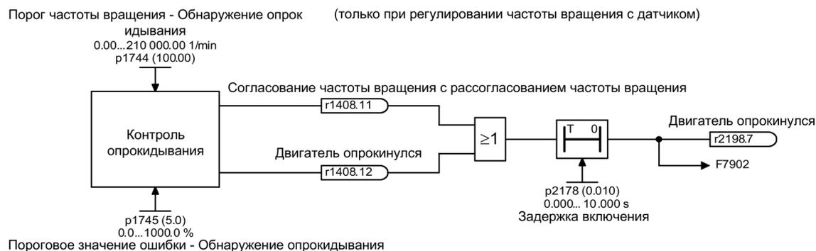
Рисунок 9-51      Защита от опрокидывания
