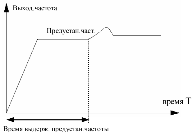
Рис.6-20 режим закр.контура с предустановл.частотой
