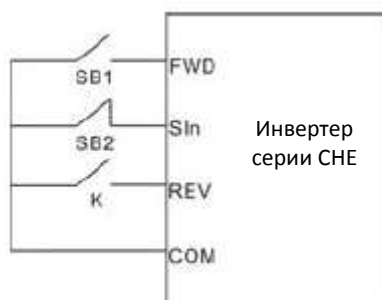
Рисунок 6.12. Трехпроводное управление режим 1.
