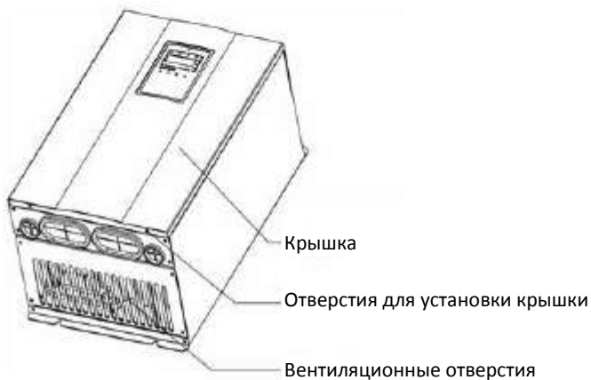
Рисунок 1.3. Компоненты инверторов (18,5 кВт и больше)
