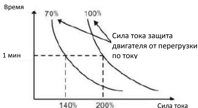
Рисунок 6.27. Кривые защиты двигателя от перегрузки по току.
