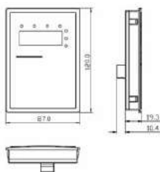
Рисунок 3.5. Установка большой панели
