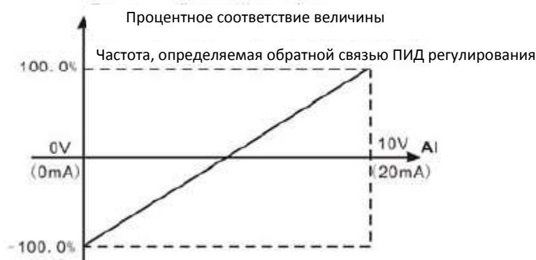
Рисунок 6.14. Отношение между сигналом аналогового входа AI и соответствующей величиной.
