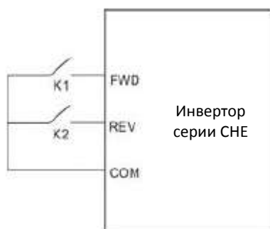
Рисунок 6.11. Двухпроводное управление режим 2.
