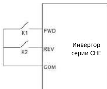
Рисунок 6.10. Двухпроводное управление режим 1.
