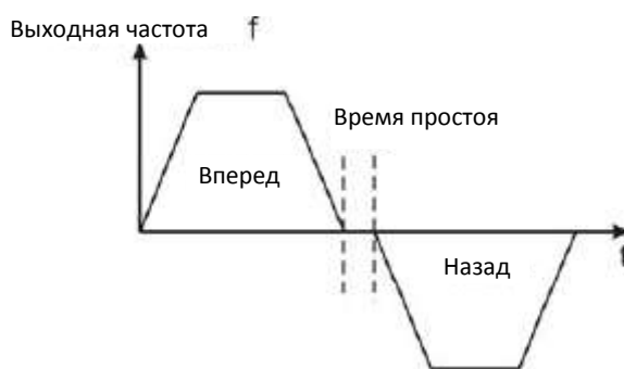
Рисунок 6.5. График задержки переключения вперед-назад (FWD/REV)
