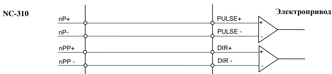
Рисунок 5.26 - Подключение дифференциальных сигналов ЦИП
