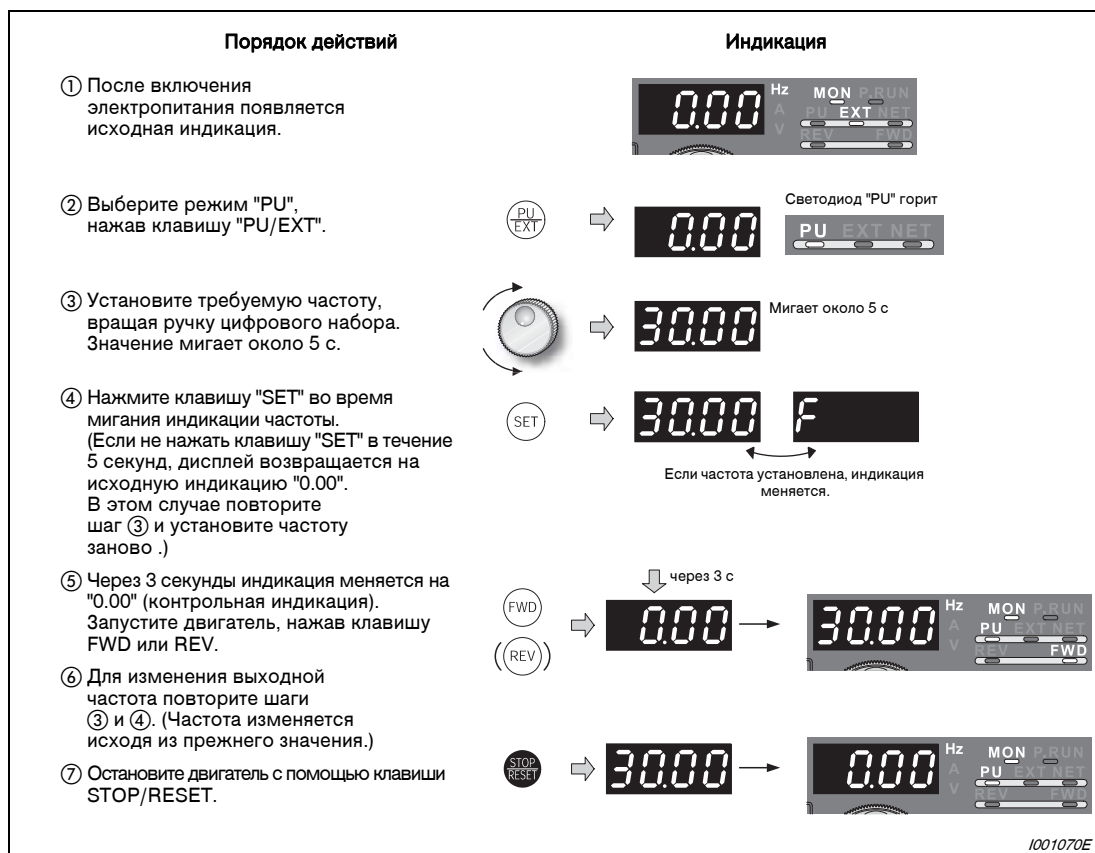
Рис. 5-17: Настройка частоты с помощью ручки цифрового набора
