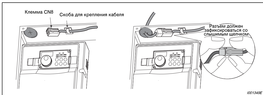
Рис. 3-38: Подключение клеммы CN8
