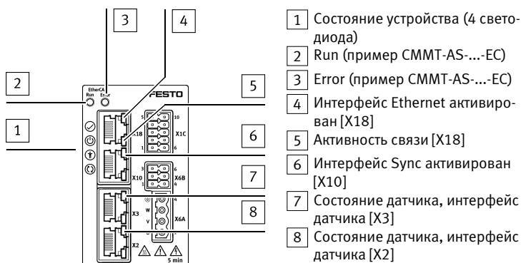
Fig. 13 Светодиоды на передней стороне (пример CMMT-AS-...-EC)
