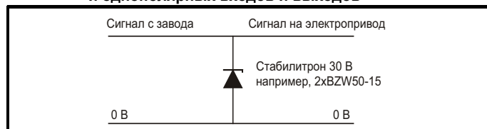
Рис. 4-44 Подавление выбросов для аналоговых и биполярных входов и выходов
