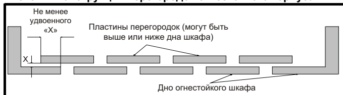
Рис. 3-2 Конструкция перегородок огнестойкого корпуса
