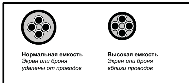
Рис. 4-17 Конструкция кабеля влияет на его емкость
