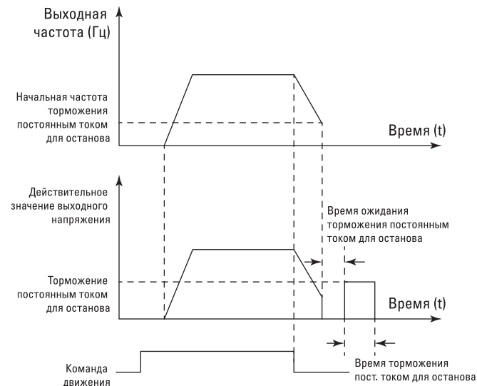
Рис. 6-13. Схема торможения постоянным током для останова
