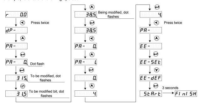
Fig. 4-3 Recover the motor's default parameter
