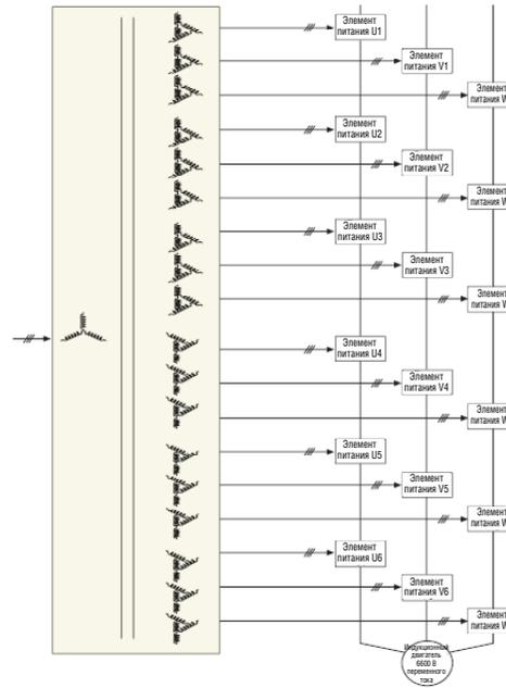
Инвертор однофазного элемента питания (Элемент питания)
