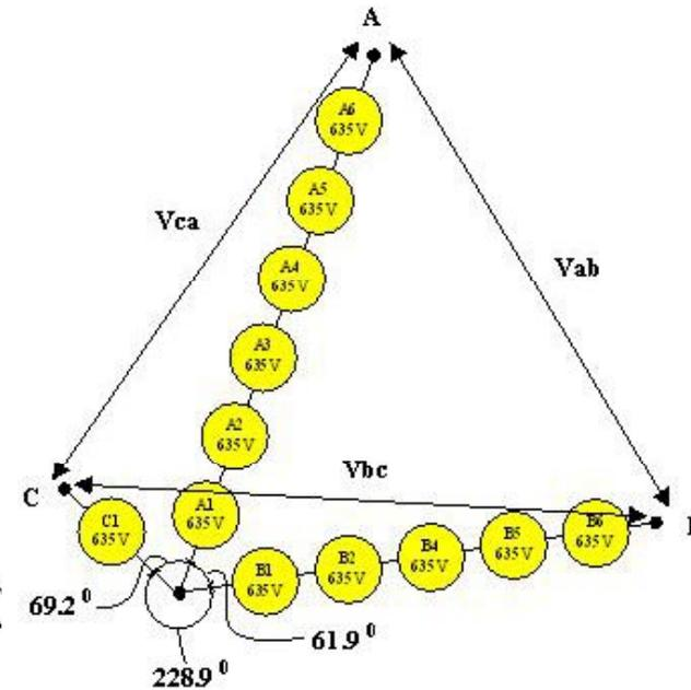
(c) без управления разбалансированностью при наличии неисправных элементов питания
