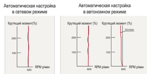
■ При сетевой автонастройке точность операций может быть достигнута посредством метода автоматической компенсации константы двигателя даже при изменении температуры двигателя.
