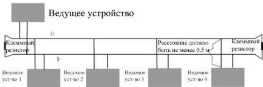
**Схема подключения клеммного резистора**
