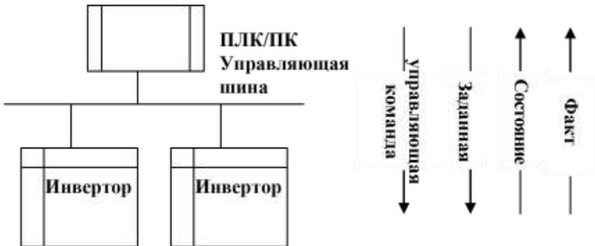
Схема подключения управляющей шины
