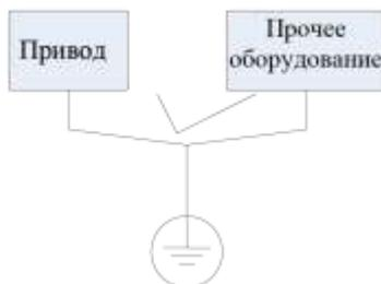
Общий кабель заземления (неприемлемо)
