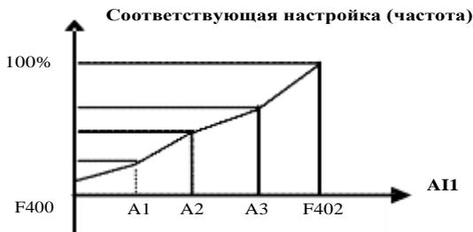
**Рис. 6-17 Значение параметра криволинейного аналогового сигнала**
