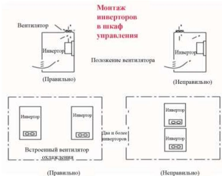
Рис. 1-3 Монтаж в шкаф
