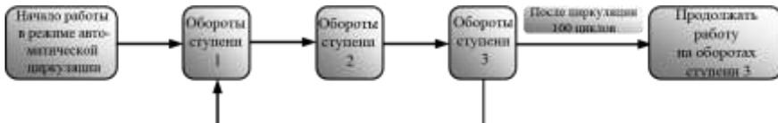
Рис. 6-18 Работа в режиме автоматической циркуляции
