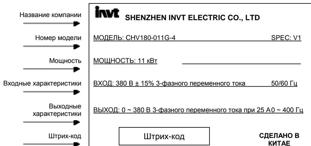
Рисунок 1.1 Паспортная табличка преобразователя частоты
