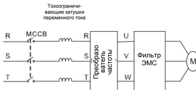
Рисунок 4.8 Электромонтаж цепи электродвигателя
