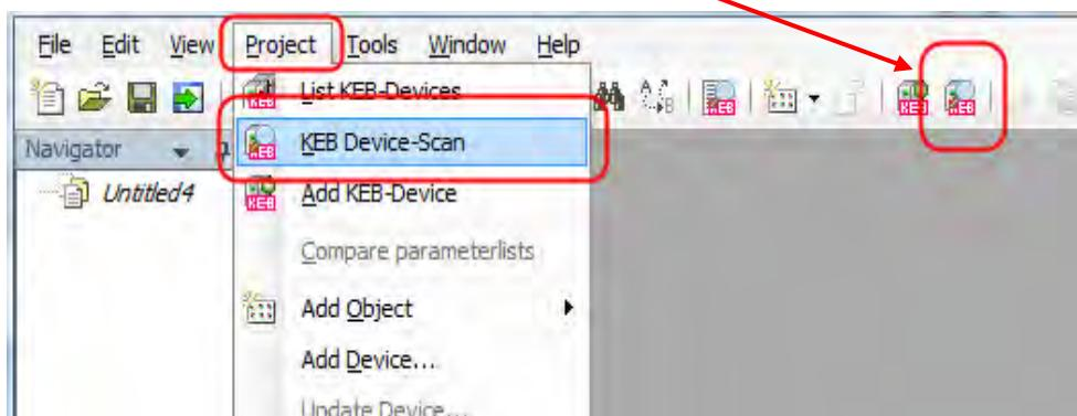
Начало сканирования можно контролировать в окне “KEB сканирование устройств”.
