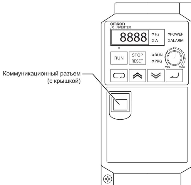
\*Крышка коммуникационного разъема является съемной. Необходимо снять переднюю панель для того, чтобы ее поставить.
