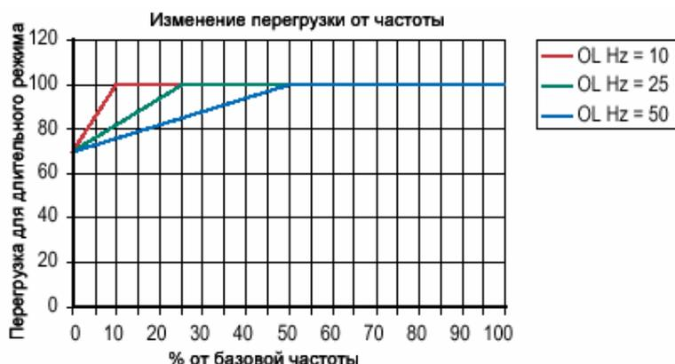
Уставка [Motor NP FLA], умноженная на коэффициент [Motor OL Factor] выбирает значение тока двигателя для тепловой защиты двигателя. Это может быть использовано для увеличения или уменьшения токовой уставки, которая вызывает срабатывание тепловой защиты двигателя от перегруза. Действующей уставкой защиты от перегруза является комбинация уставок [Motor OL Hertz] и [Motor OL Factor].
