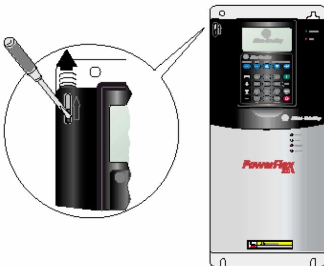
Найдите прорезь в левой верхней части корпуса. Сдвиньте вверх фиксатор защелки и, покачивая, откройте крышку. Специальные шарниры позволяют перемещать крышку в разные стороны, и расположить ее например на корпусе соседнего привода (если он есть).
